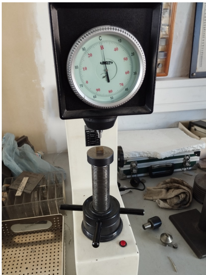
Slika 31. Određivanje adhezivnosti prevlake na Rockwell C tvrdomjeru
