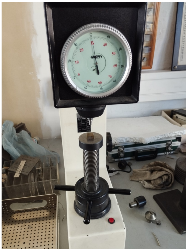
Slika 31. Određivanje adhezivnosti prevlake na Rockwell C tvrdomjeru
