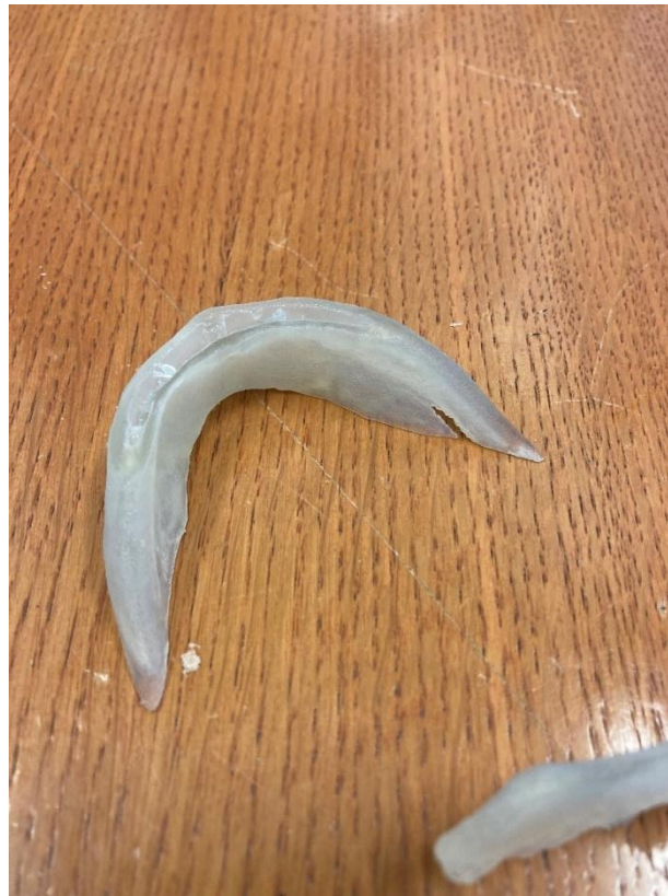
Slika 33 Prototip implantata nakon uklanjanja potporne strukture
