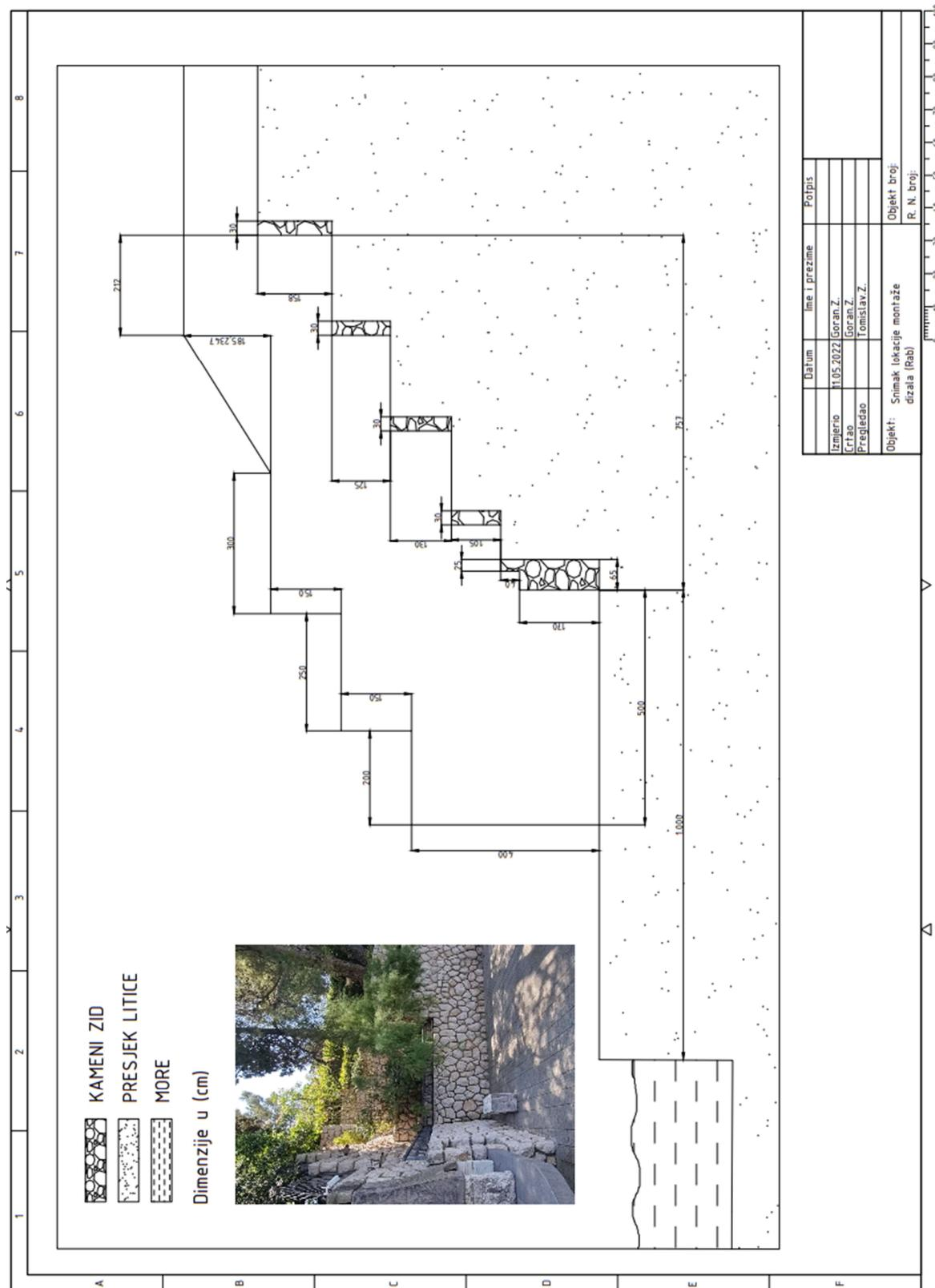
**Slika 7-6 Snimak lokacije montaže s dimenzijama (presjek litice).**
