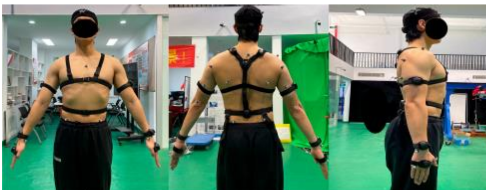
Slika 49. 11 senzora i 25 markera [39]
