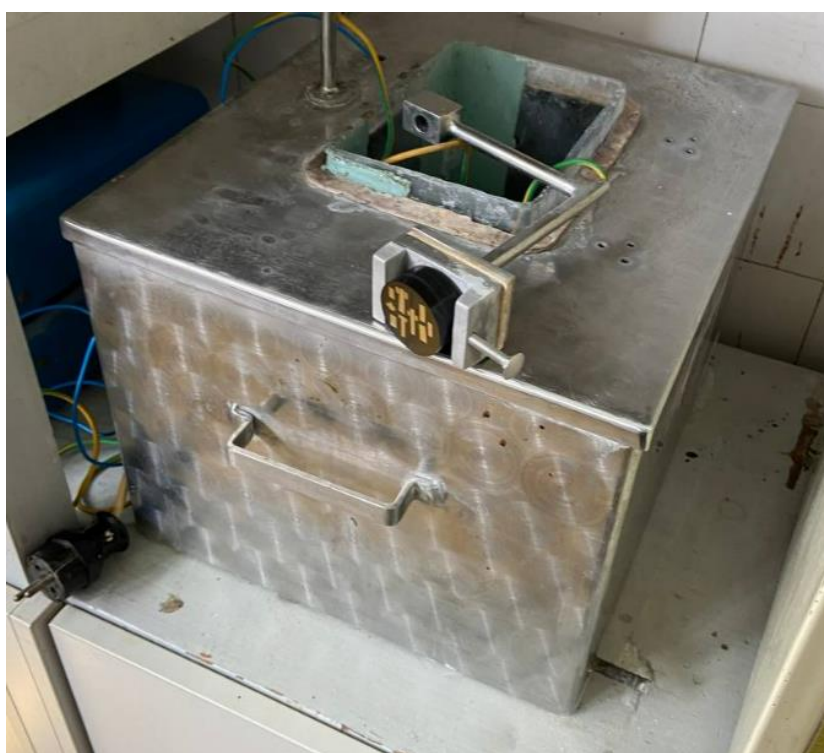
Slika 20. Oprema za elektrokemijsko nagrizanje
