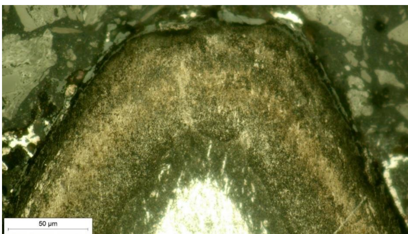
Slika 27. Vrh navoja M5, nitrokarburirano 6h, povećanje 500x
