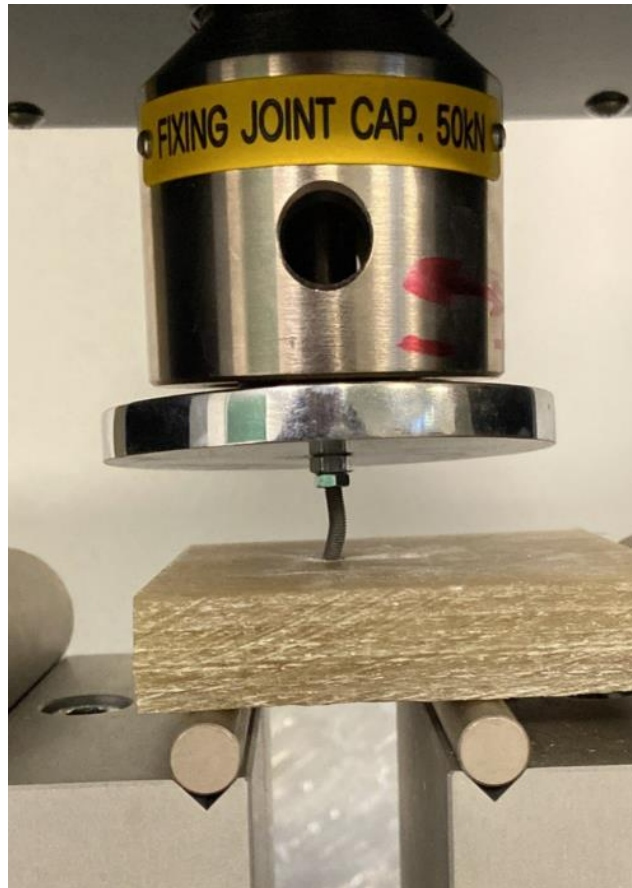
Slika 33. Izvijanje pri postupku određivanja sile pucanja
