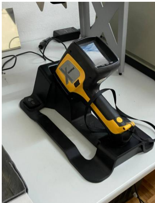
Slika 16. Uređaj za određivanje kemijskog sastava marke „XRF Olympus“
