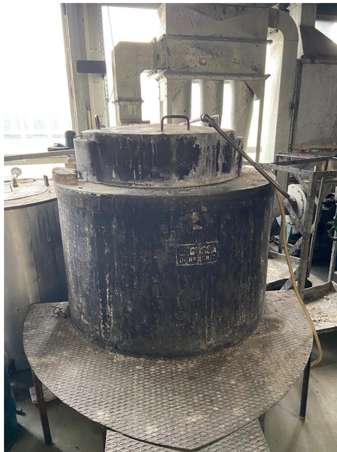
Slika 17. Solna kupka korištena za nitrokarburiranje „DURFERRIT-DEGUSSA GmbH“
