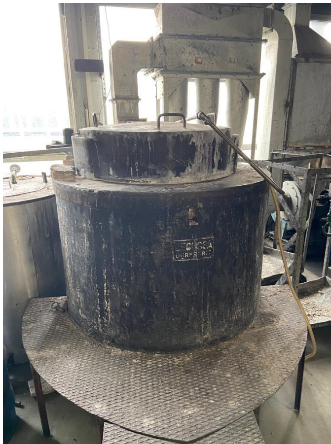
Slika 17. Solna kupka korištena za nitrokarburiranje „DURFERRIT-DEGUSSA GmbH“
