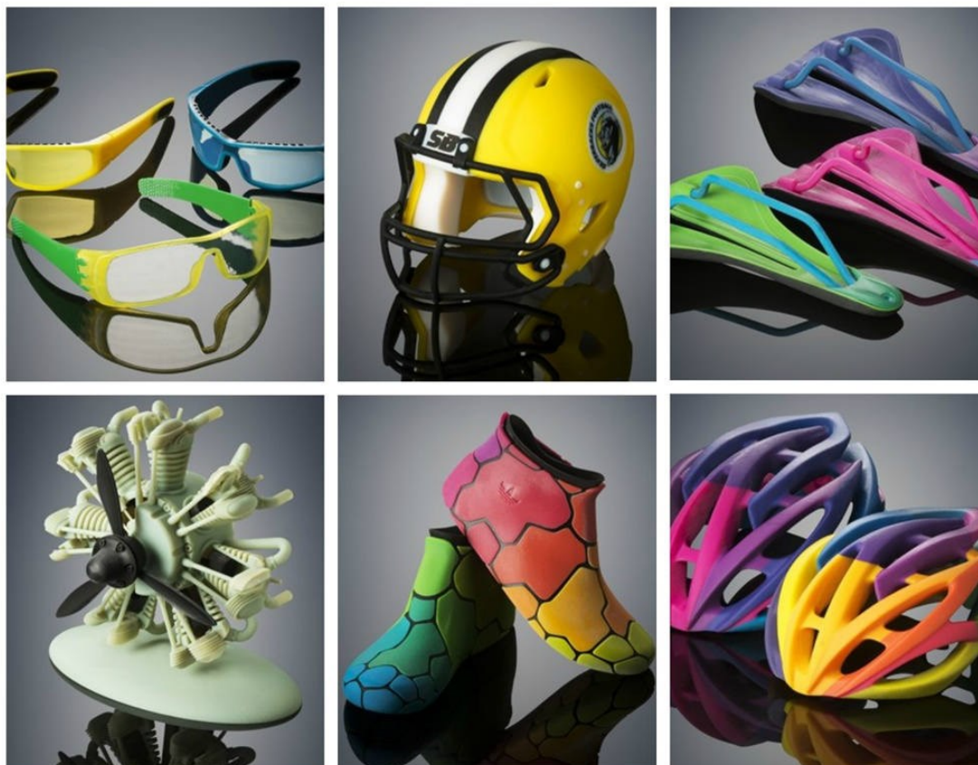
Slika 5 Proizvodi PolyJet tehnologije [11]
