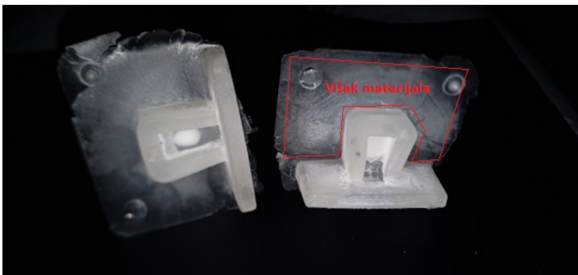
Slika 37 Proizvodi načinjeni u HP Jet Fusion kalupnom umetku
