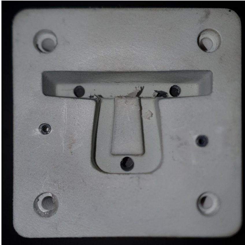
Slika 38 Deformacija HP Jet Fusion kalupnog umetka
