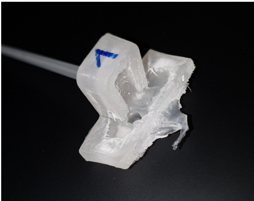
Slika 32 Proizvod načinjen u FDM kalupnom umetku
