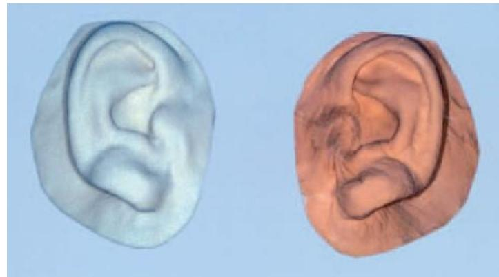
Slika 22. Razlika zrcalnog modela dobivenog AM postupkom (lijevo) i gipsanog (desno) [18]
