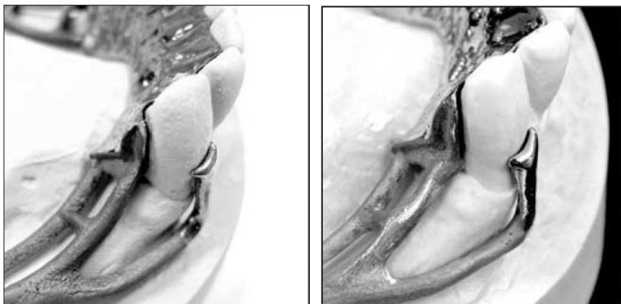
Slika 18. Proteza izrađena od 316L nehrdajućeg čelika (lijevo) i legure kroma i kobalta (desno) [14]
