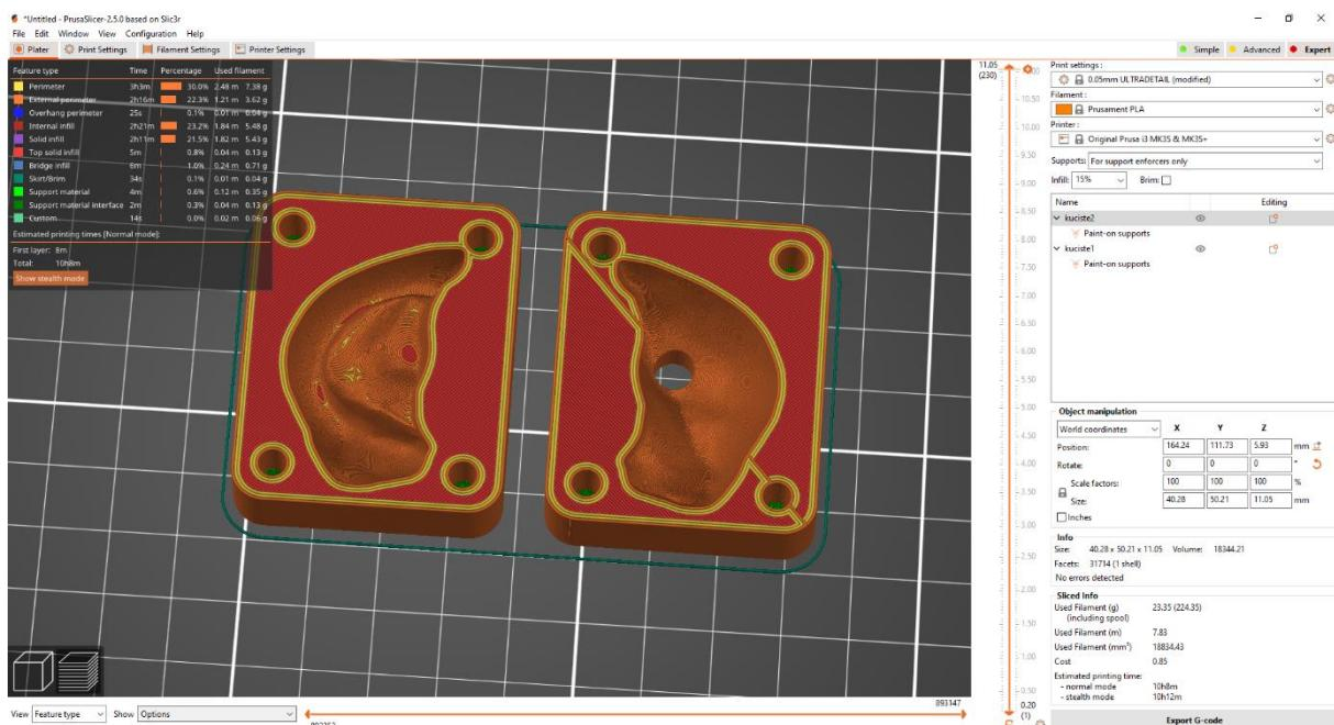
Slika 46. Kalup pri kvaliteti izrade s debeljinom sloja 0,05 mm
