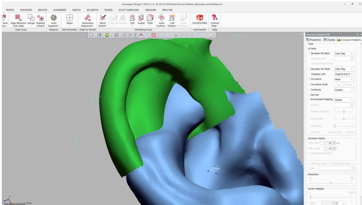
Slika 29. Preklapanje desne uške i zrcaljene lijeve
