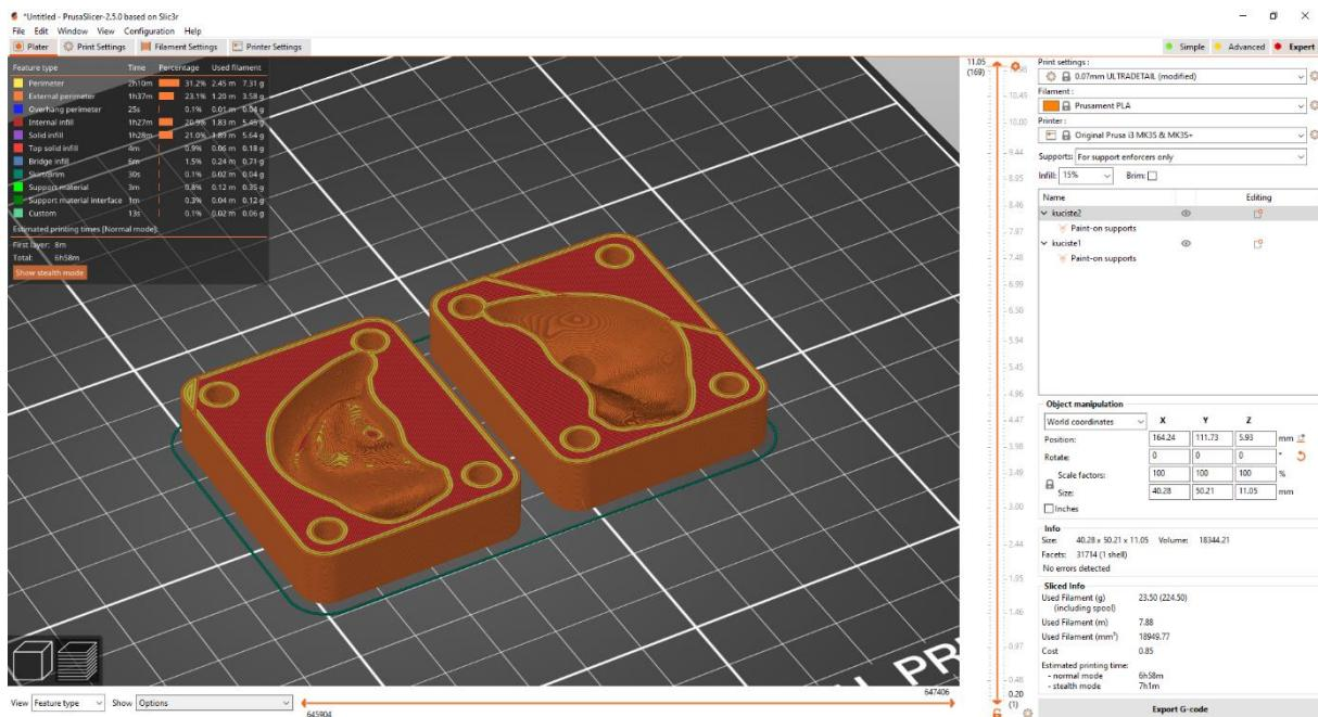
Slika 45. Kalup pri kvaliteti izrade s debeljinom sloja 0,07 mm
