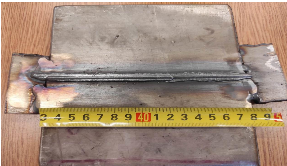
Slika 37. Izgled korijena zavara i donje površine MIG uzorka
