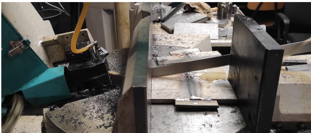
Slika 69. Rezanje uzoraka na tračnoj pili
