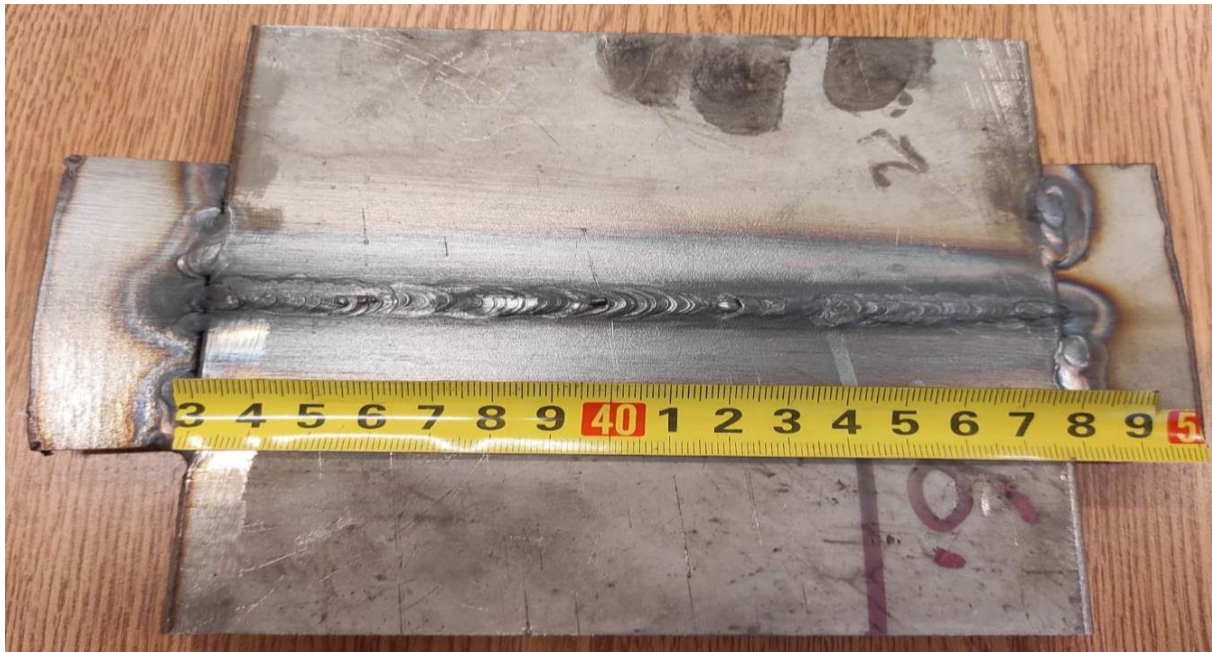
Slika 31. Izgled korijena zavara i donje površine TIG uzorka
