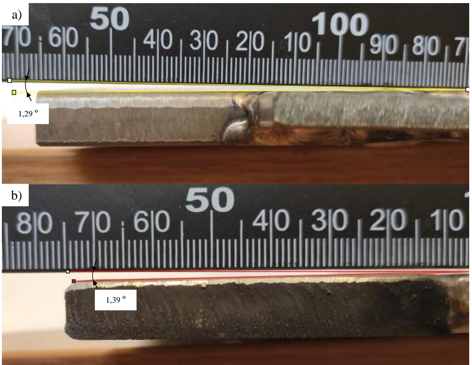
Slika 68. Deformacija: a) TIG uzorka i b) MIG uzorka
