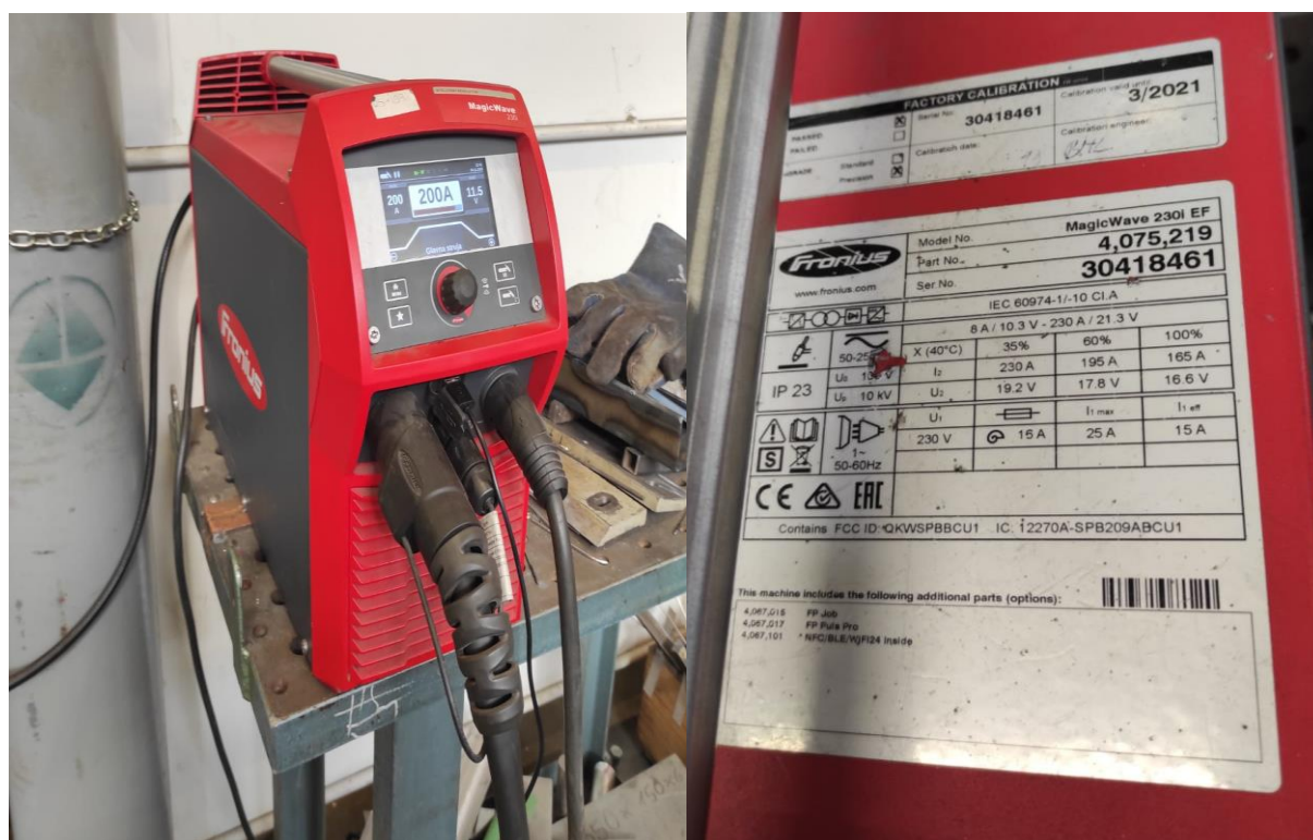
Slika 24. Izvor struje za zavarivanje MagicWave 230i i pripadajuća identifikacijska pločica
