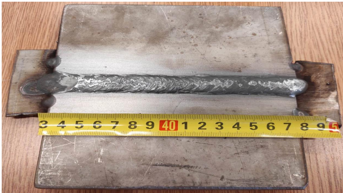
Slika 38. Izgled gornje površine i lica zavora MIG uzorka
