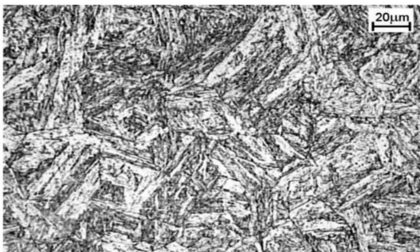
Slika 20. Mikrostruktura martenzitnog nehrđajućeg čelika [21]
