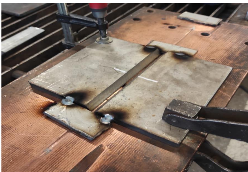
Slika 35. Priprema spoja kod MIG uzorka
