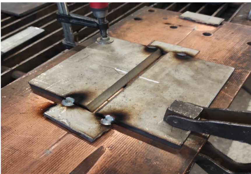
Slika 35. Priprema spoja kod MIG uzorka
