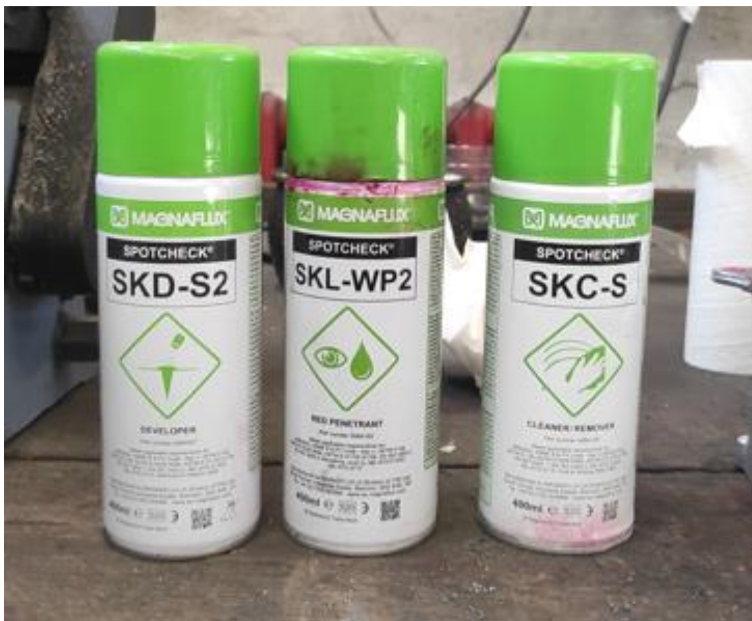
Slika 37. Penetrant, odstranjivač, razvijач korišteni u eksperimentu
