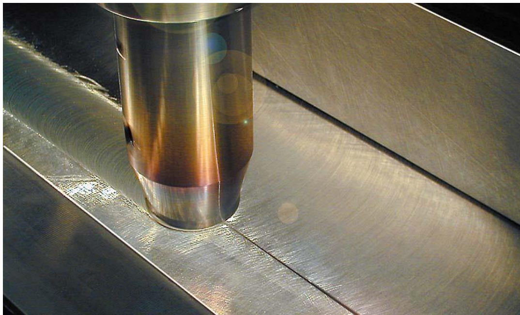
Slika 12.Faza formiranja FSW zavarenog spoja[17]
