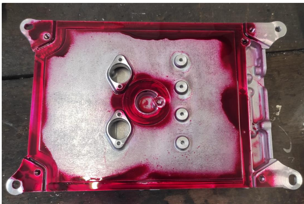
Slika 38. Uzorak nakon čišćenja površine
