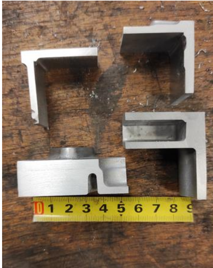
Slika 50. Makrouzorci nakon ručnog brušenja
