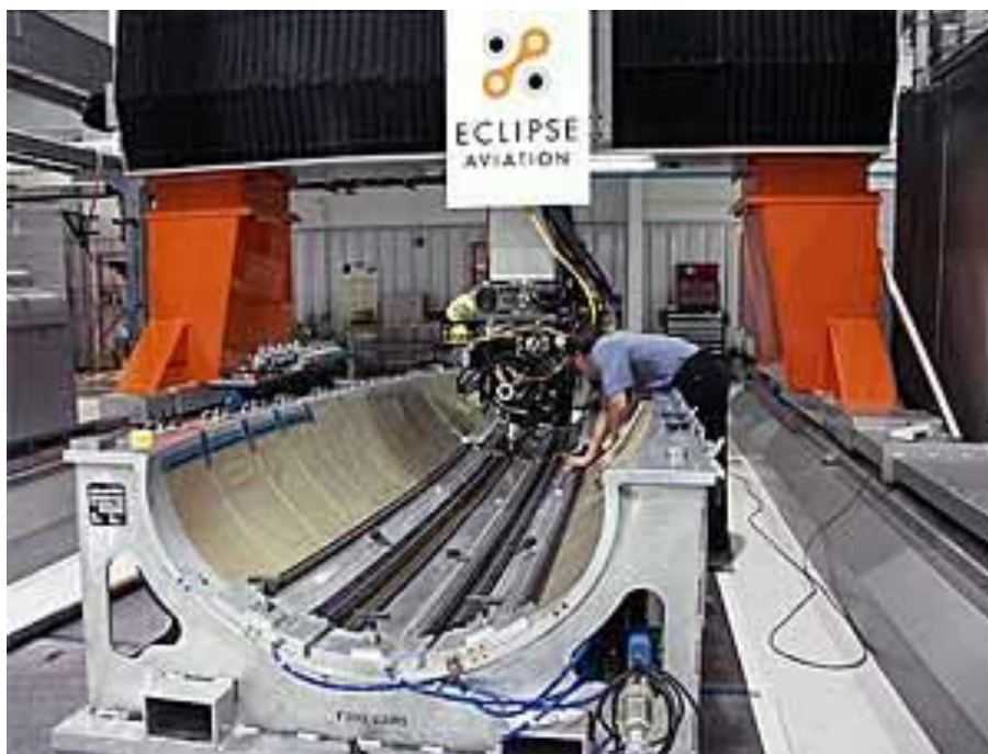
Slika 6. FSW zavarivanje aluminijskih poprečnih greda i poluga za kabinske ploče[8]
