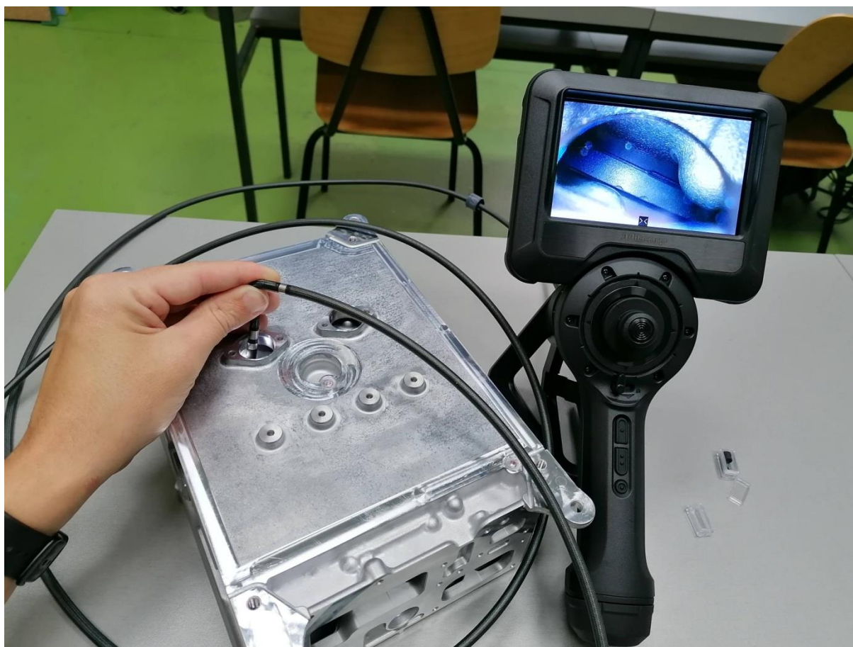
Slika 47. Vizualna kontrola pomoću videoscopa Mitcorp X750
