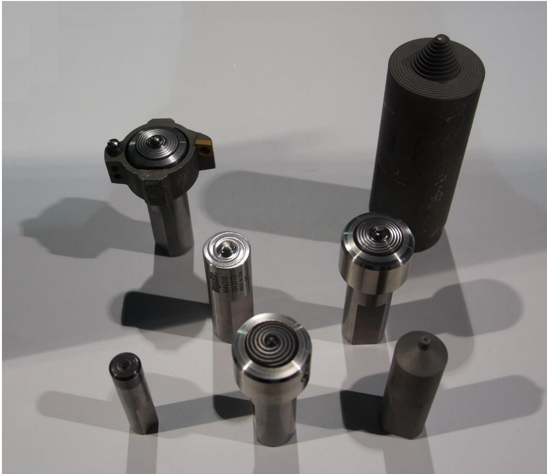
Slika 18. MegaStir napredni alati za zavarivanje [6]
