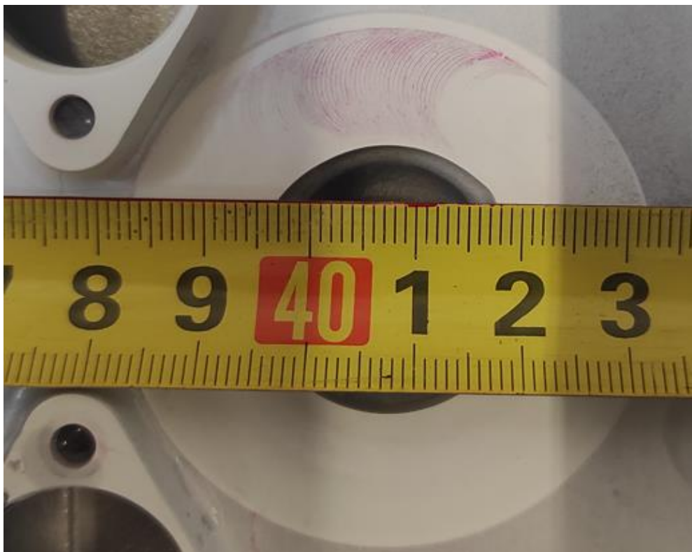
Slika 40. Zavar nakon ispitivanja penetrantom
