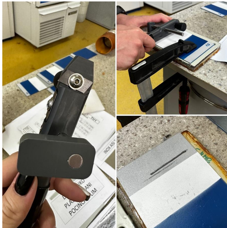
Slika 36. Postupak izrade ureza prije slane komore
