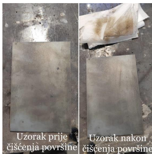
Slika 18. Čišćenje površine ispitnih uzoraka
