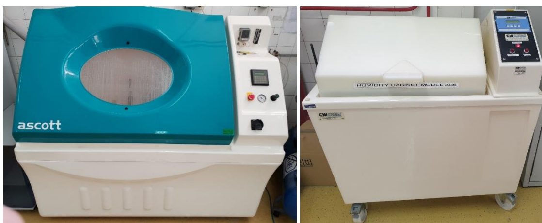
Slika 23. Slana (lijevo) i vlažna (desno) komora u Laboratoriju za zaštitu materijala na Fakultetu strojarstva i brodogradnje
