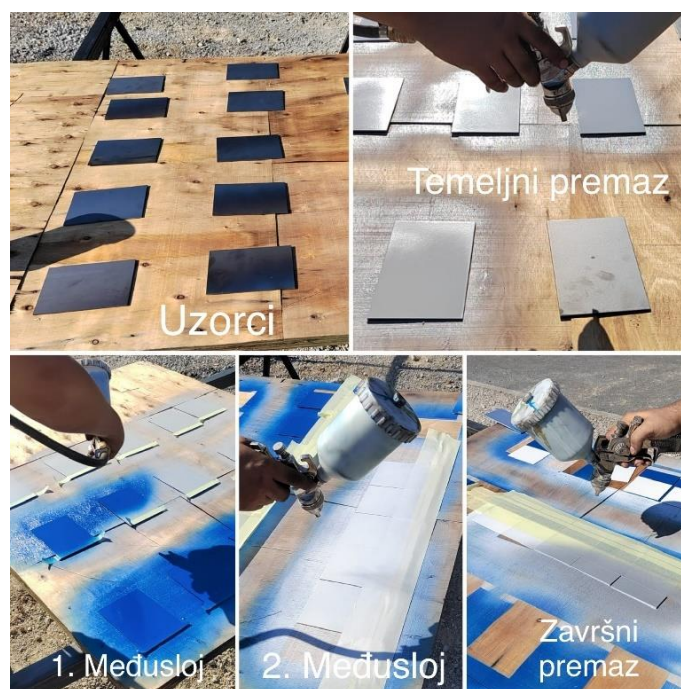
Slika 22. Nanošenje premaza na ispitne uzorke
