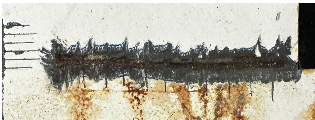
Slika 39. Postupak ocjenjivanja stupnja korozije oko ureza
