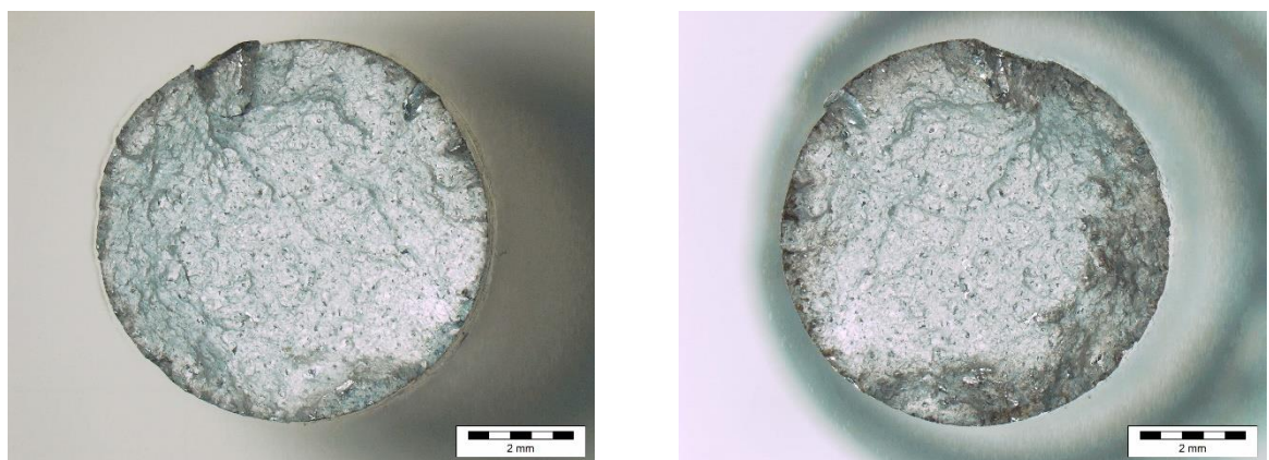
Slika 55 Prijelom SLM toplinski neobrađene epruvete 1
