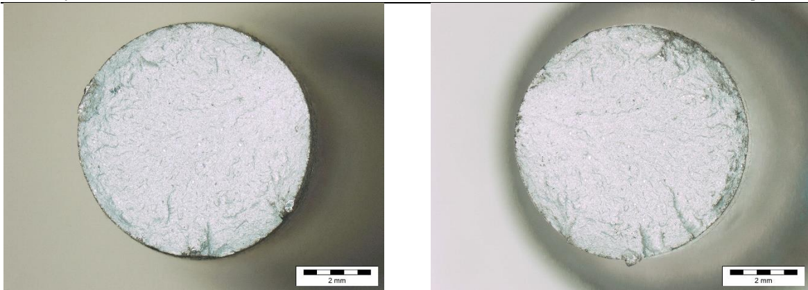
Slika 56 Prijelom SLM T6 toplinski obrađene epruvete 2
