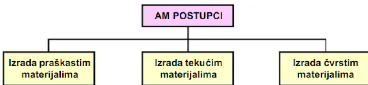
Slika 25 Podjela postupaka aditivne proizvodnje [26]
