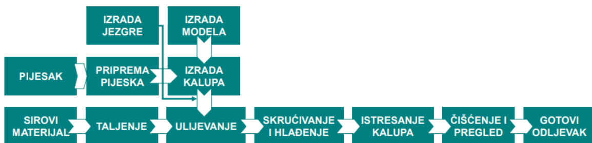
Slika 3 Prikaz pješčanog lijeva [5]
