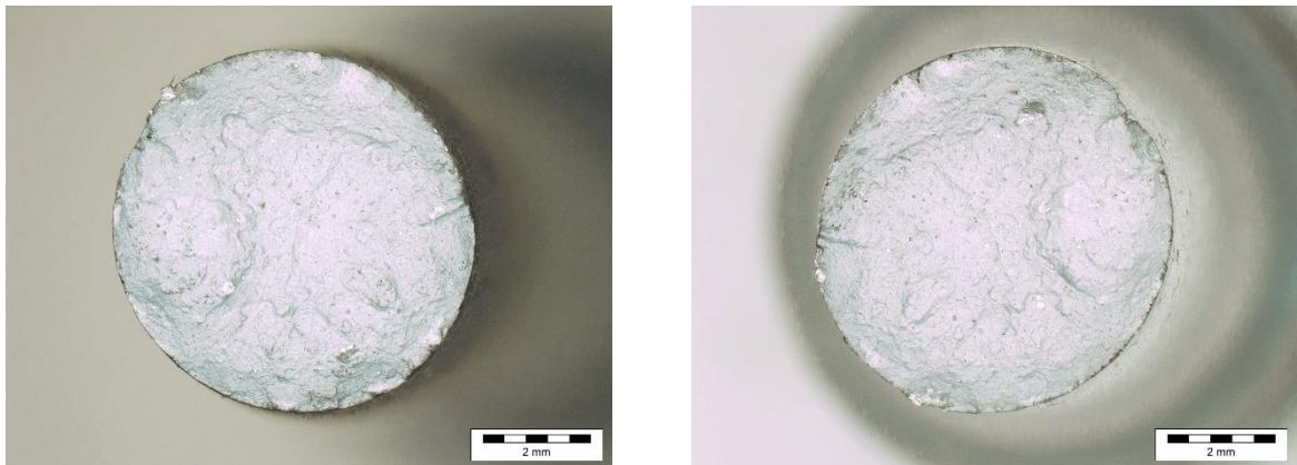
Slika 57 Prijelom SLM EOS T6 toplinski obrađene epruvete 2
