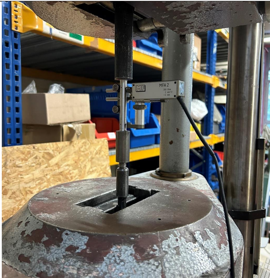
Slika 44 Epruveta u kidalici s ekstenziometrom
