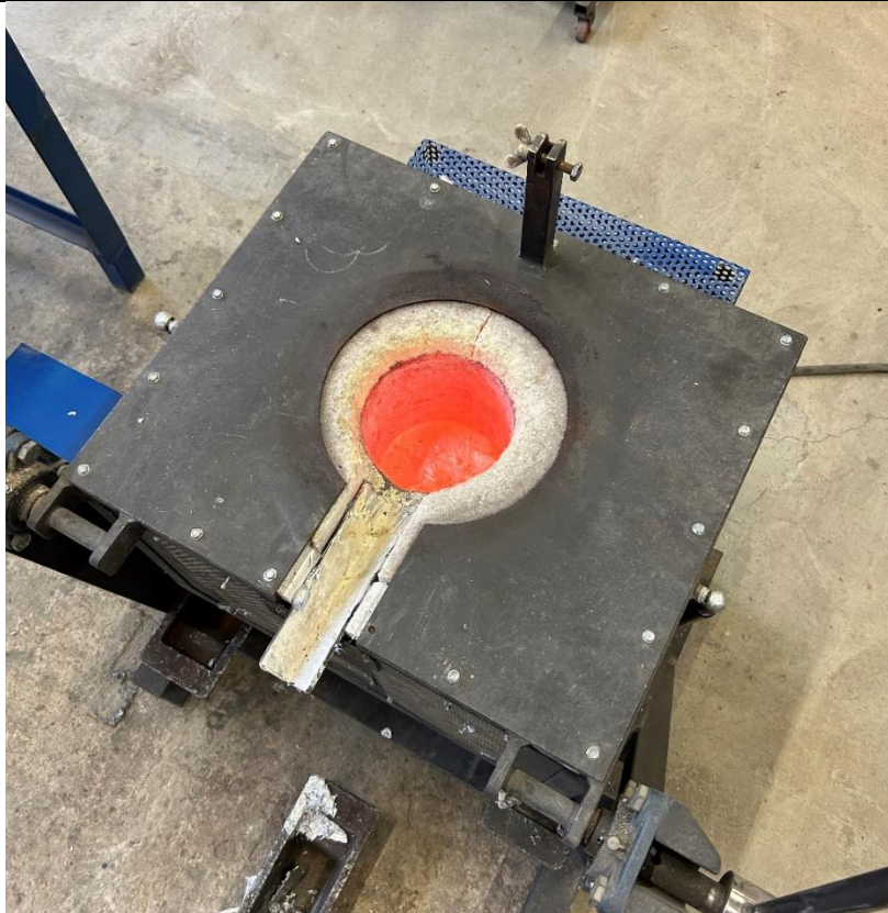
Slika 37 Taljenje aluminijske legure u peći
