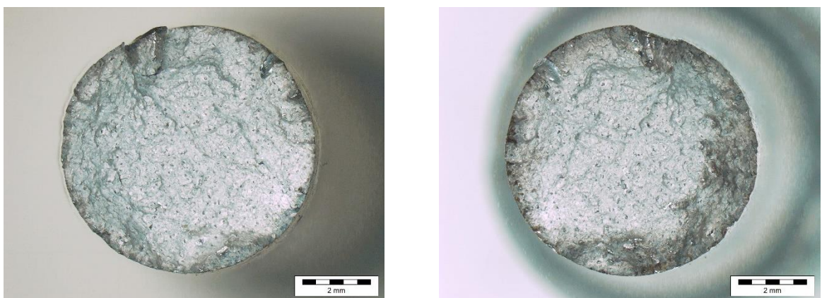
Slika 55 Prijelom SLM toplinski neobrađene epruvete 1
