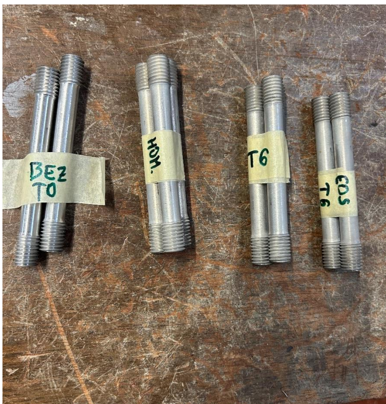
Slika 43 Epruvete izrađene aditivnom proizvodnjom
