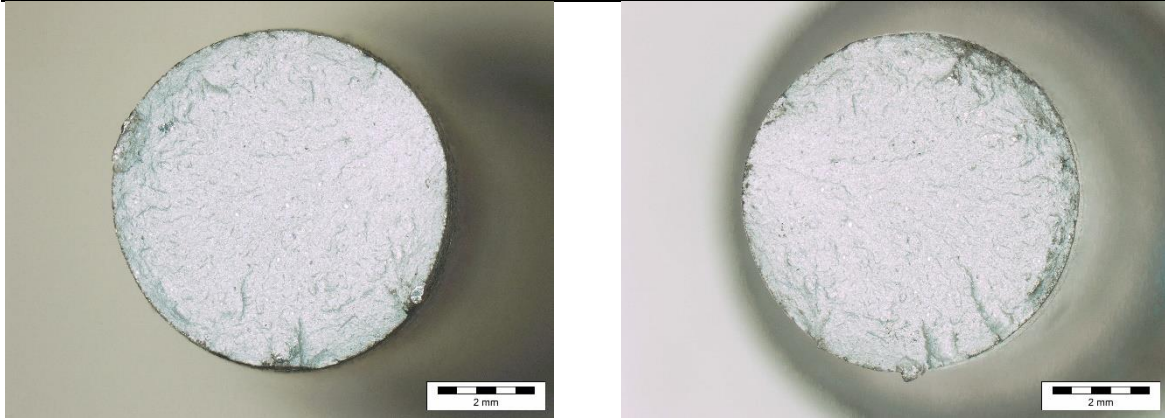
Slika 56 Prijelom SLM T6 toplinski obrađene epruvete 2
