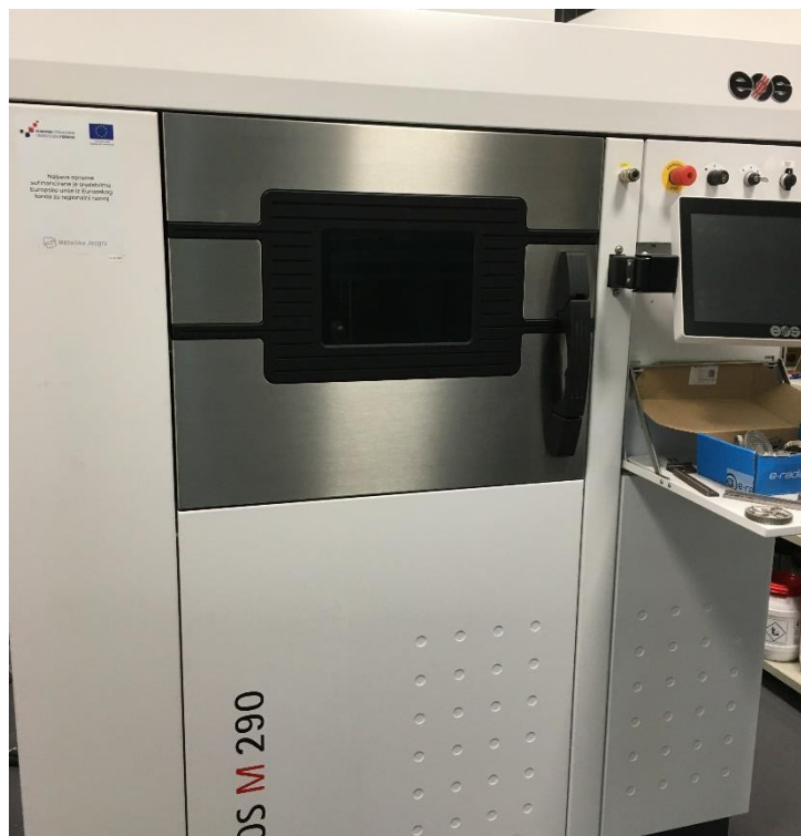
Slika 41 Laserski 3D printer za metal EOS M 290
