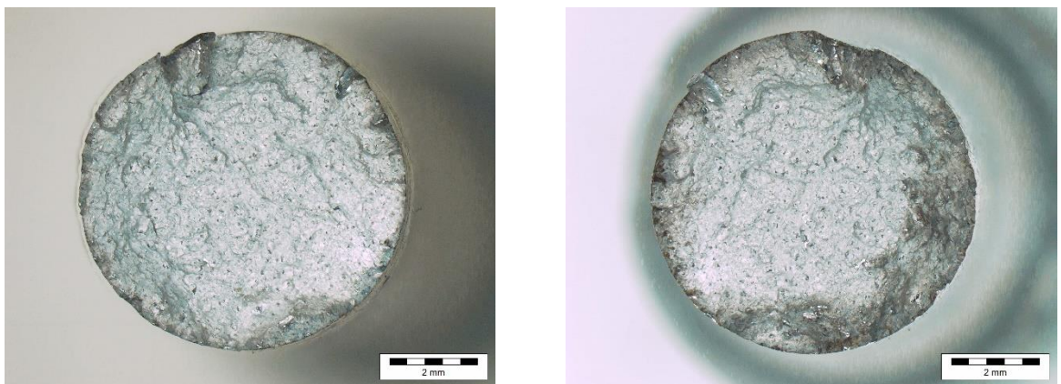
Slika 55 Prijelom SLM toplinski neobrađene epruvete 1
