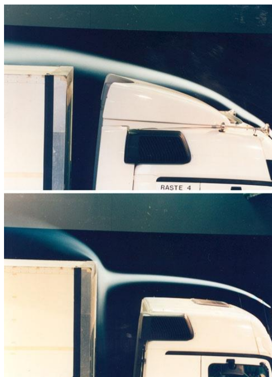
Slika 106. Prikaz zastoja tlaka na kabini [38]
