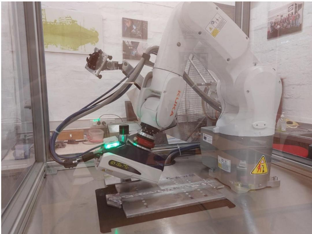
**Slika 44. Pulstec µ-X360s sa robotskom rukom marke Kuka**
