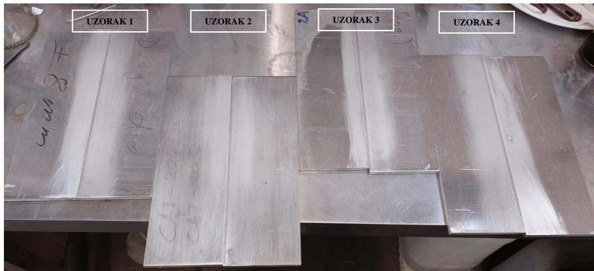
Slika 34. Prikaz Al-Mg ploča prije zavarivanja
