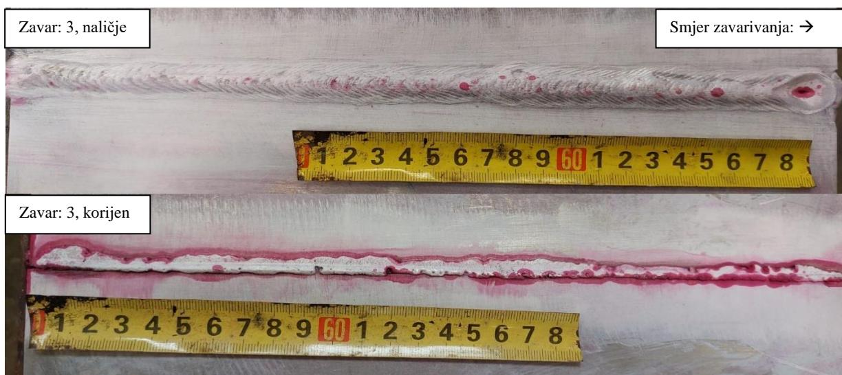
Slika 40. Rezultat ispitivanja penetrantima, uzorak 3
