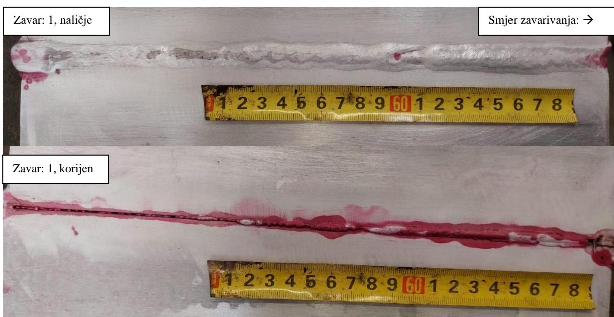
Slika 38. Rezultat ispitivanja penetrantima, uzorak 1
