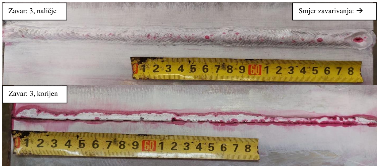
Slika 40. Rezultat ispitivanja penetrantima, uzorak 3
