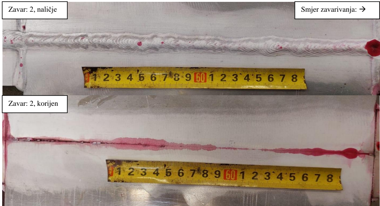
Slika 39. Rezultat ispitivanja penetrantima, uzorak 2
