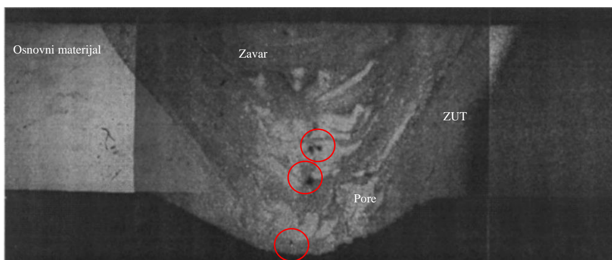
Slika 12. Poprečni presjek zavara kombinacije materijala: AA5083 (desno) i AA6060 (lijevo), dodatni materijal ER4043. debljina ploče 5 mm [4].
