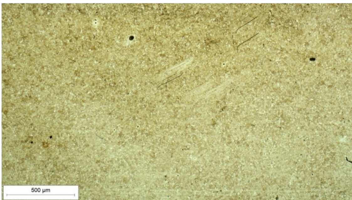
Slika 20. Mikrostruktura čelika Hardox 450, snimljeno pri povećanju od 50×
