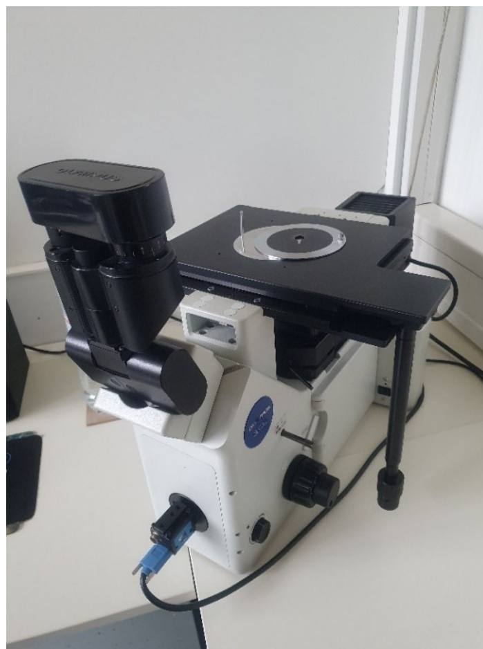
Slika 19. Svjetlosni mikroskop Olympus GX51
