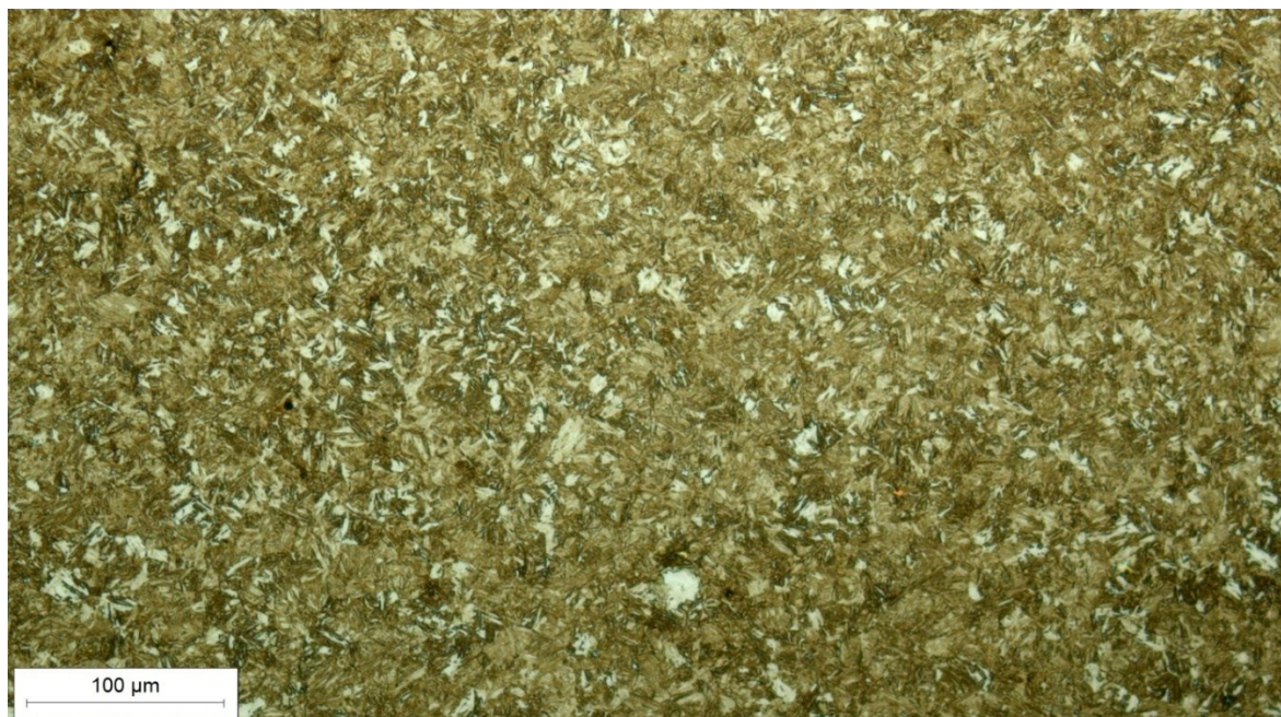
Slika 25. Mikrostruktura čelika XAR 450, snimljeno pri povećanju od 200×
