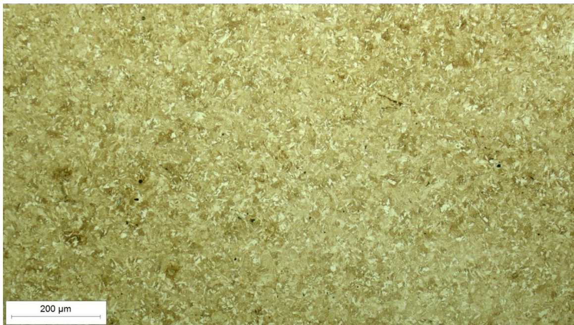
Slika 22. Mikrostruktura čelika Hardox 450, snimljeno pri povećanju od 100×
