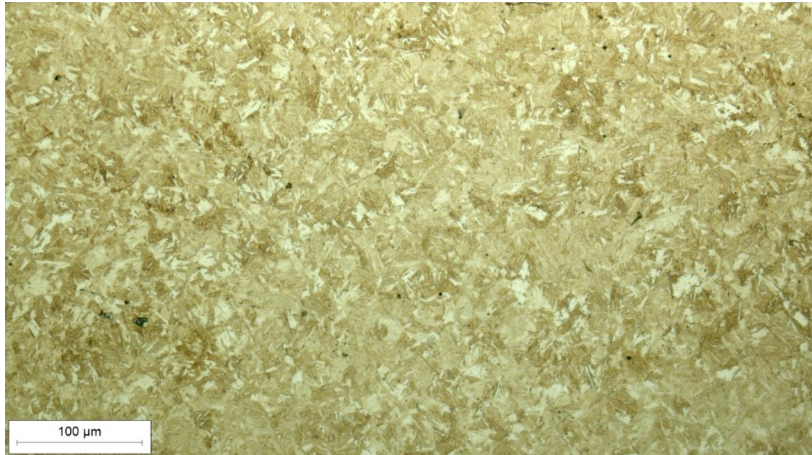
Slika 24. Mikrostruktura čelika Hardox 450, snimljeno pri povećanju od 200×
