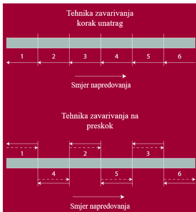
Slika 5.9 Primjena tehnike zavarivanja korak unatrag i na preskok [21]
