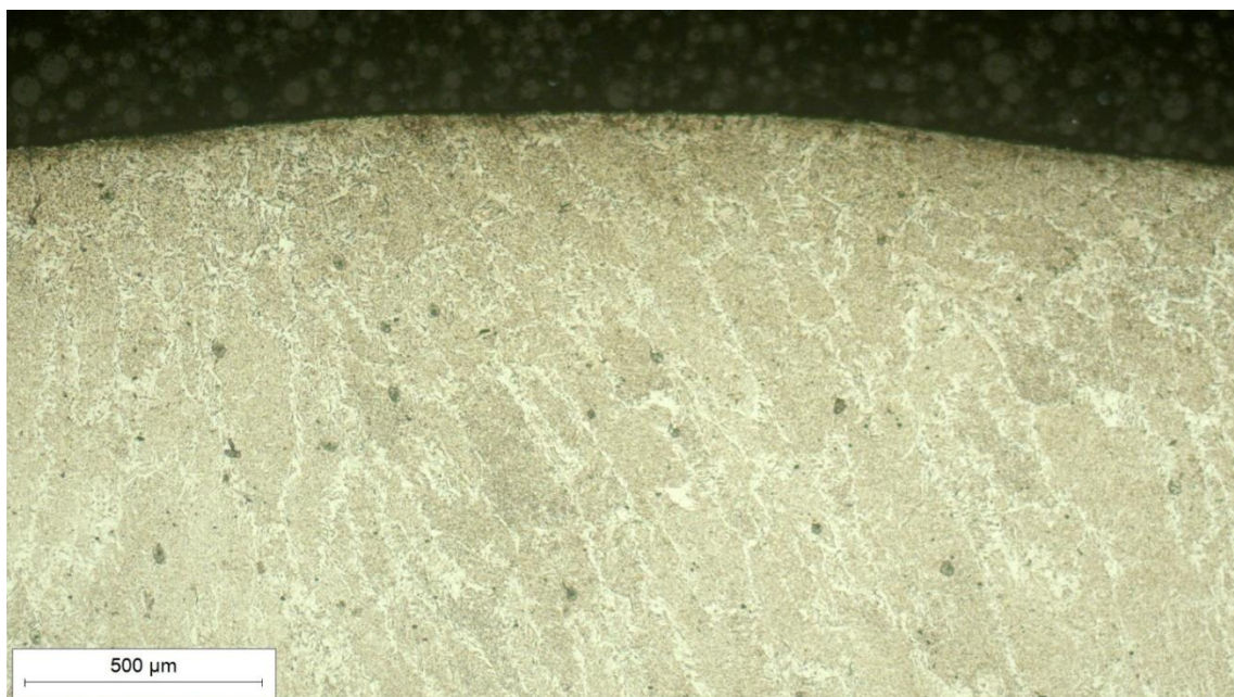
Slika 8.29 Mikrostruktura tjemena zavara, snimljena pri povećanju 50×
