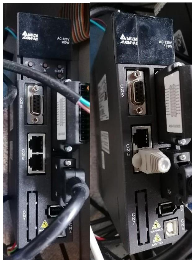
Slika 2.2.2 - Servo pogoni snaga 200 W (lijevo) i 100 W (desno)
