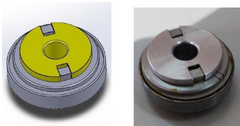
Slika 3.1.6 – Sklop spojke i harmonijskog prijenosnika
