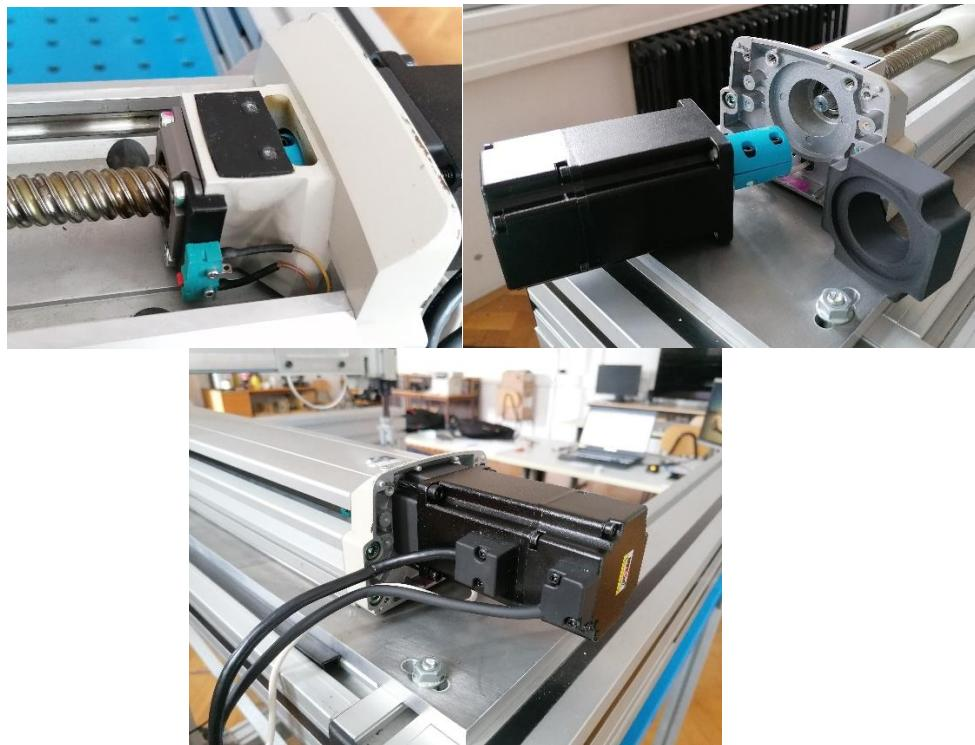
**Slika 3.1.3 – Sklop komponenti na aktuatoru X-osi**
