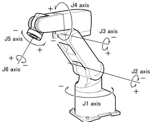
**Slika 1 – 6-osni zglobni robot (eng. Articulated robot)**
