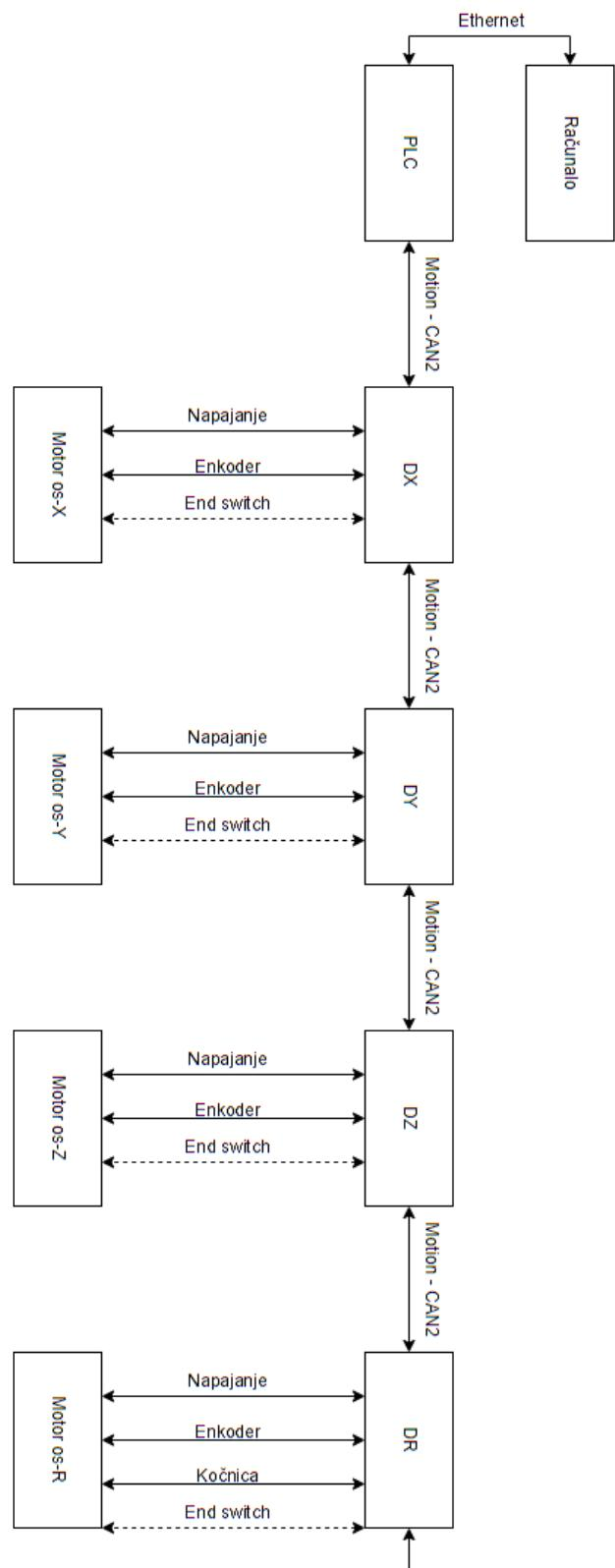
II. Shema spajanja kontakata PLC-a i servo pogona s ostalim komponentama
