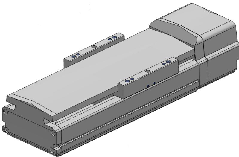
**Slika 2.1.3 – CAD prikaz aktuatora x-osi**
