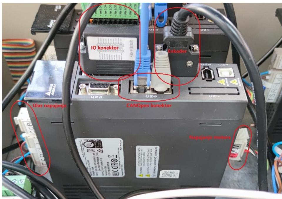
Slika 3.2.4 – Prikaz priključaka na servo pogonu
