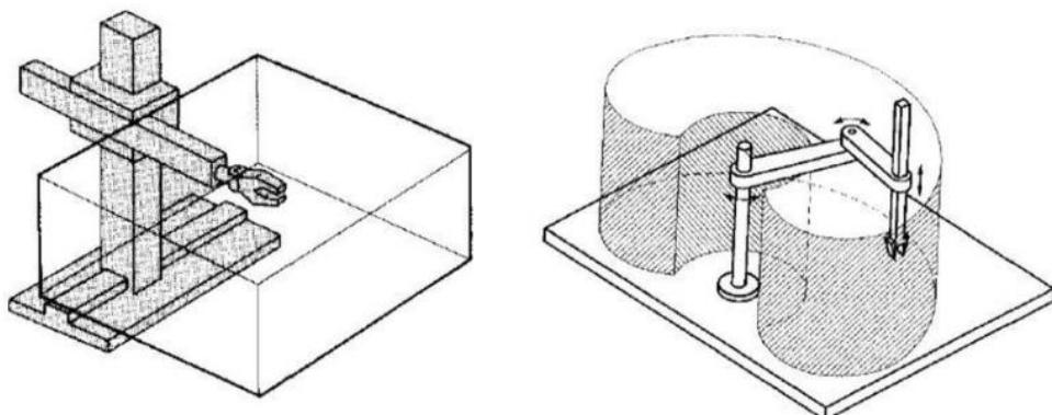
**Slika 3 – Usporedba radnog prostora kartezijskog (lijevo) i SCARA (desno)**
