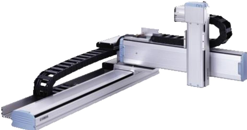
**Slika 1.2 – Primjer položaja osi (linearnih zglobova) kartezijskog koordinatnog robota**
