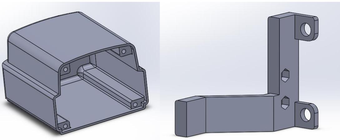
**Slika 3.1.7 – CAD prikaz kućišta motora (lijevo) i držača krajnjeg prekidača (desno)
