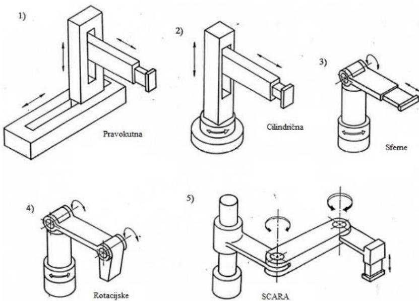
**Slika 2 – Podjela robota s obzirom na strukturu**
