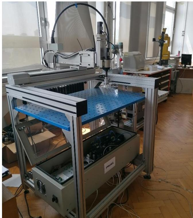
Slika 3.1.2 – Prikaz cijelog kartezijevog koordinatnog robota
