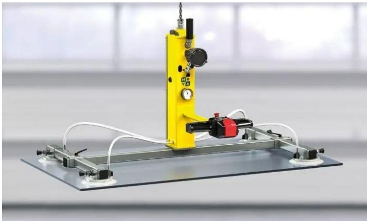
Slika 5. Vakuumski manipulator za rukovanje pločama [4]
