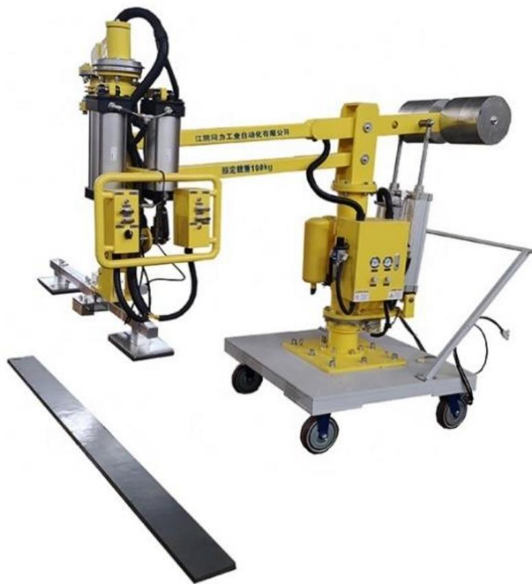
Slika 7. Ručni vakuumski manipulator za rukovanje trakama [6]
