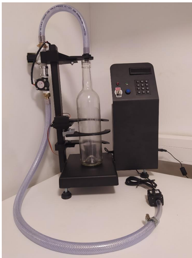
Slika 45. Uređaj za punjenje vinskih boca
