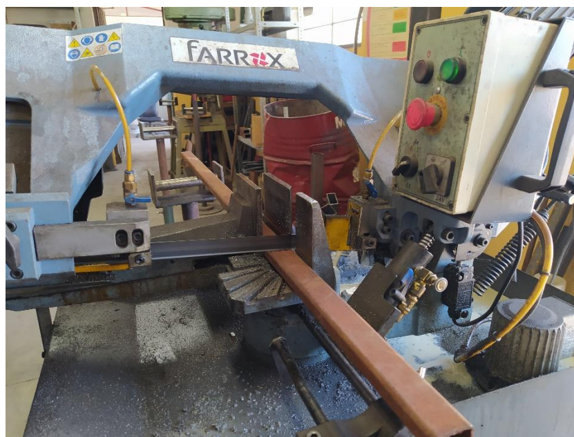
Slika 34. Rezanje odabranog profila
