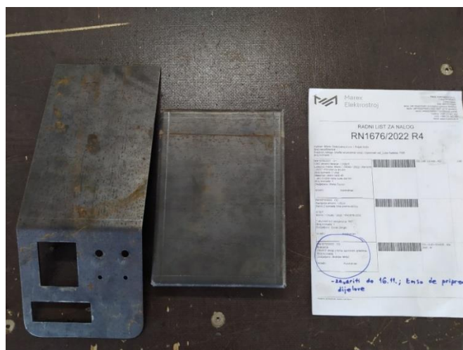
Slika 39. Dijelovi konstrukcije nakon savijanja
