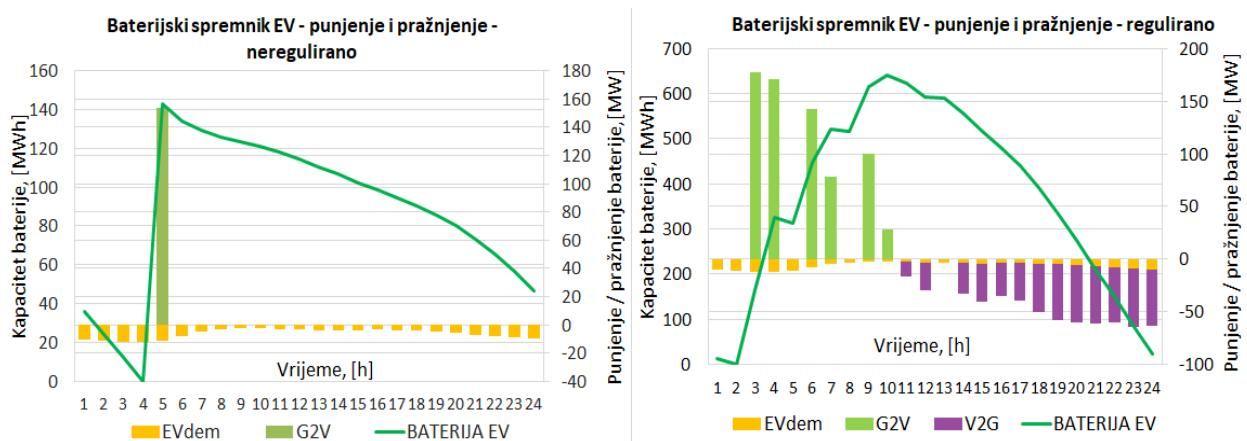
Slika 48. Prikaz energetskih tokova u BEV za neregulirani i regulirani sustav standardnog punjenja i pražnjenja u programu Calliope, dan zime. Lijevi dijagram – neregulirani sustav; desni dijagram – regulirani sustav
