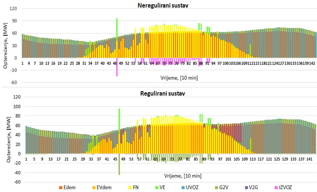
Slika 40. Prikaz energetskih tokova za 16. srpnja za scenarij 2050\_10min\_S1 s usporedbom nereguliranog i reguliranog punjenja i pražnjenja EV
