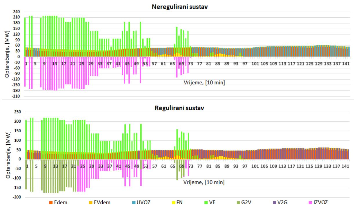
Slika 49. Prikaz energetskih tokova za 15. siječnja za scenarij 2050\_10 min\_SI s usporedbom nereguliranog i reguliranog punjenja i pražnjenja EV u novom algoritmu
