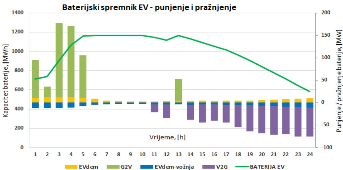
Slika 46. Prikaz energetskih tokova u BEV i kapaciteta baterije za regulirani sustav standardnog punjenja i pražnjenja u novom algoritmu, 15. siječnja za scenarij 2050\_1h\_SI
