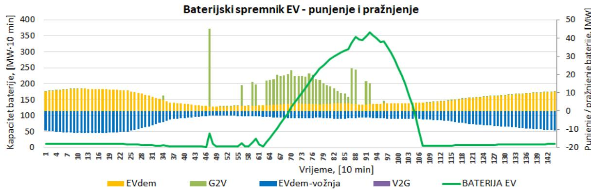
Slika 41. Prikaz energetskih tokova u bateriji EV i kapaciteta baterije za regulirani sustav brzog punjenja i pražnjenja, 16. srpnja za scenarij 2050\_10 min\_S1.
