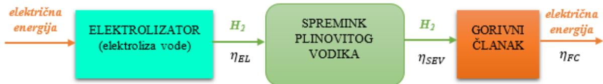
Slika 15. Princip rada i energetski tokovi u sustavu SEV
