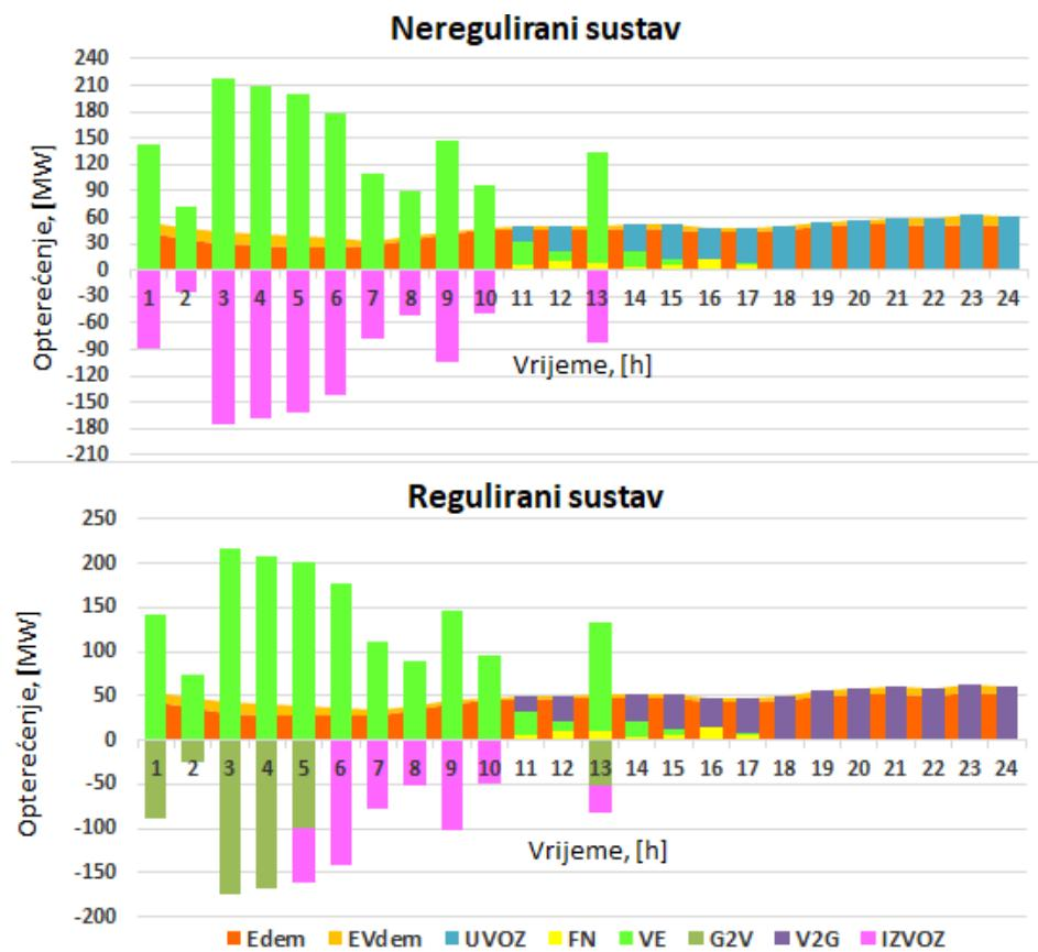
Slika 45. Prikaz energetskih tokova za 15. siječnja za scenarij 2050\_1h\_SI s usporedbom nereguliranog i reguliranog punjenja i pražnjenja EV u novom algoritmu
