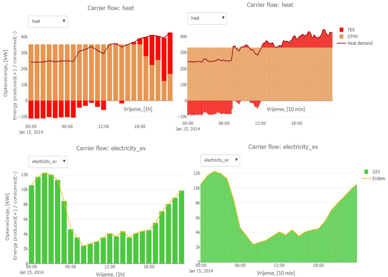
*Slika 54. Prikaz energetskih tokova toplinske energije i električne energije u EV za satni i 10-minutni model u programu Calliope*
