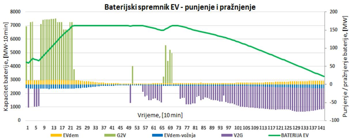
Slika 50. Prikaz energetskih tokova u BEV i kapaciteta baterije za regulirani sustav brzog punjenja i pražnjenja u novom algoritmu, 15. siječnja za scenarij 2050\_10 min\_SI
