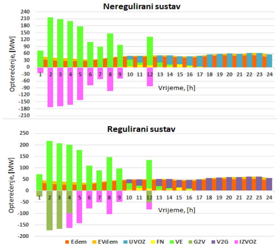
Slika 36. Prikaz energetskih tokova za 15. siječnja za scenarij 2050\_1h\_S1 s usporedbom nereguliranog i reguliranog punjenja i pražnjenja EV
