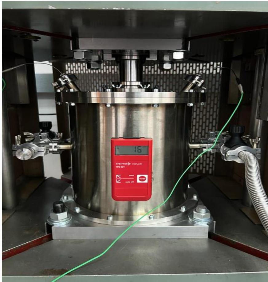
Slika 16. Vakuumska posuda s temperaturnim senzorima
