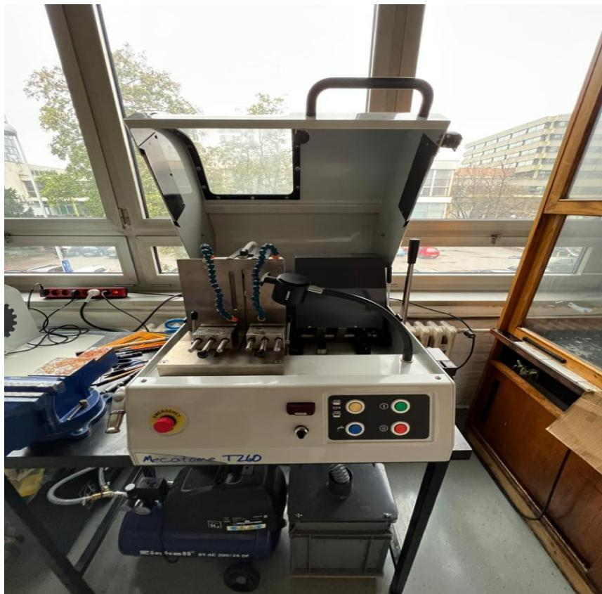
Slika 19. Uređaj za rezanje Mecatome T260
