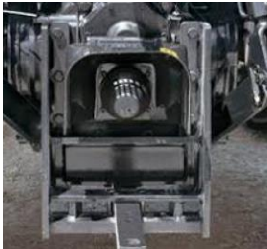
Slika 9. Izlazni priključak za radno vratilo
