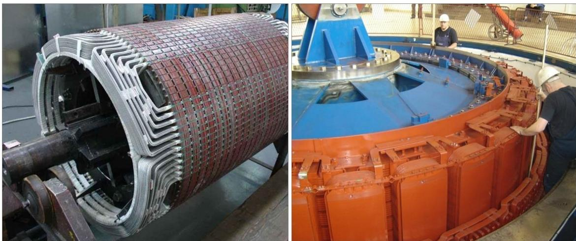
Slika 12 – cilindrični rotor (lijevo) i rotor s istaknutim polovima (desno)
