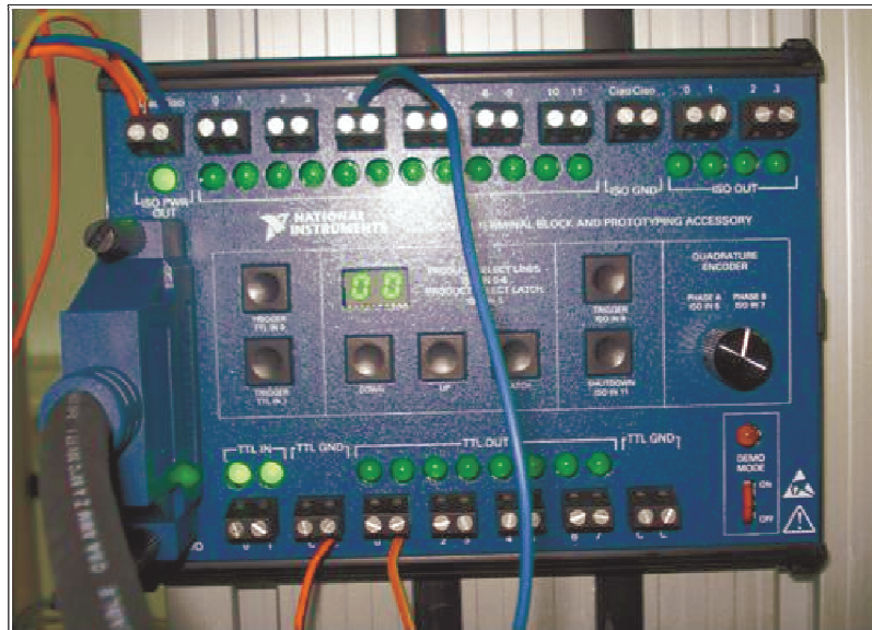
Slika 3.14 NI CVS-1450 ulazno/izlazni modul
