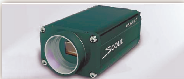
Slika 3.10 Basler Scout ScA 1400-17fc kamera [20]
