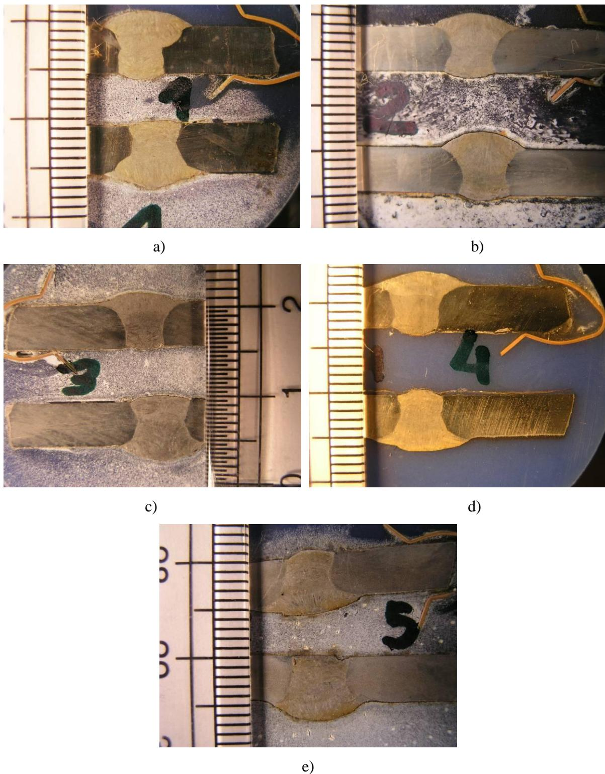
**Slika 58.** Pripremljeni uzorci za mjerjenje geometrije lica i korijena zavara.
