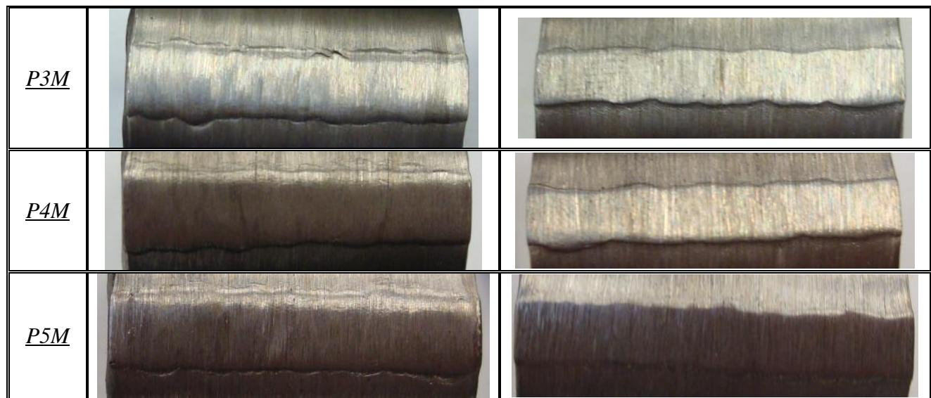
Iz pokusa na savijanje korijena i lica zavara možemo zaključiti da su parametri zavarivanja pravilno odabrani kod mješavine plinova, jer kod svih pokusa savijanja uzoraka koji su bili zavareni mješavinom plinova 97,5 % Ar + 2,5 % CO<sub>2</sub> nije došlo do pojave pukotina prilikom savijanja pri maksimalnom kutu savijanja te su ti uzorci zadovoljili ovo ispitivanje.
