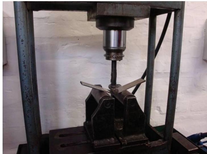
Slika 46. Savijanje uzorka.
