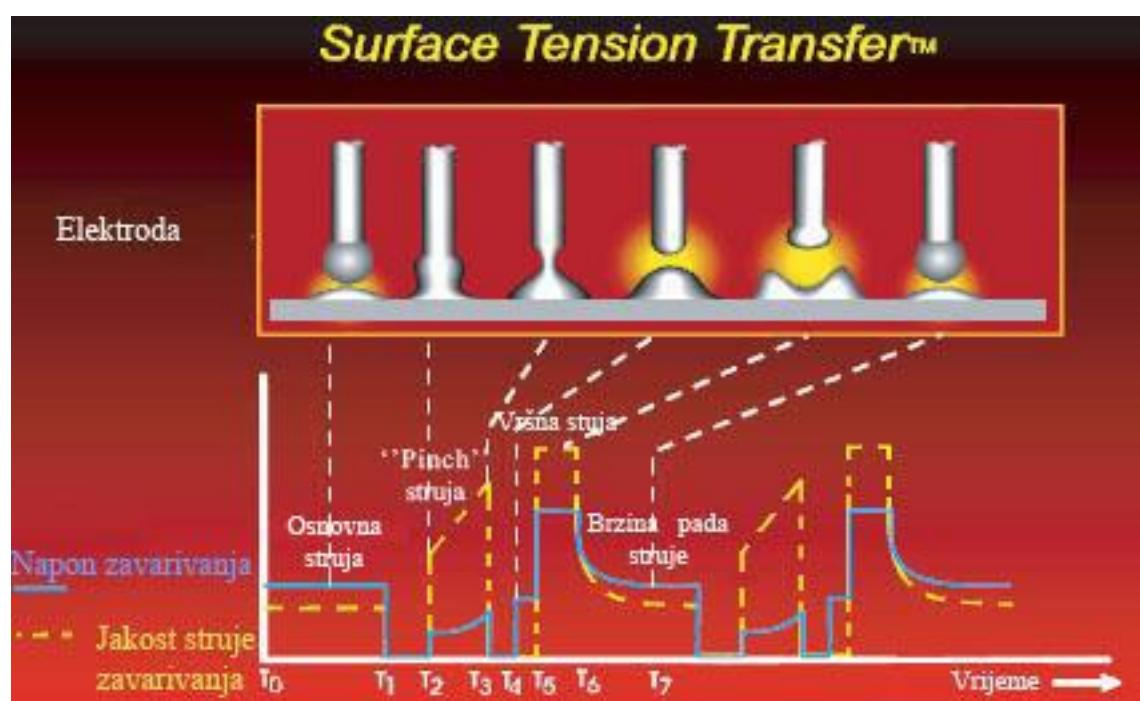
**Slika 3.** Promjene parametara MIG/MAG – STT zavarivanja [1,2,6].
