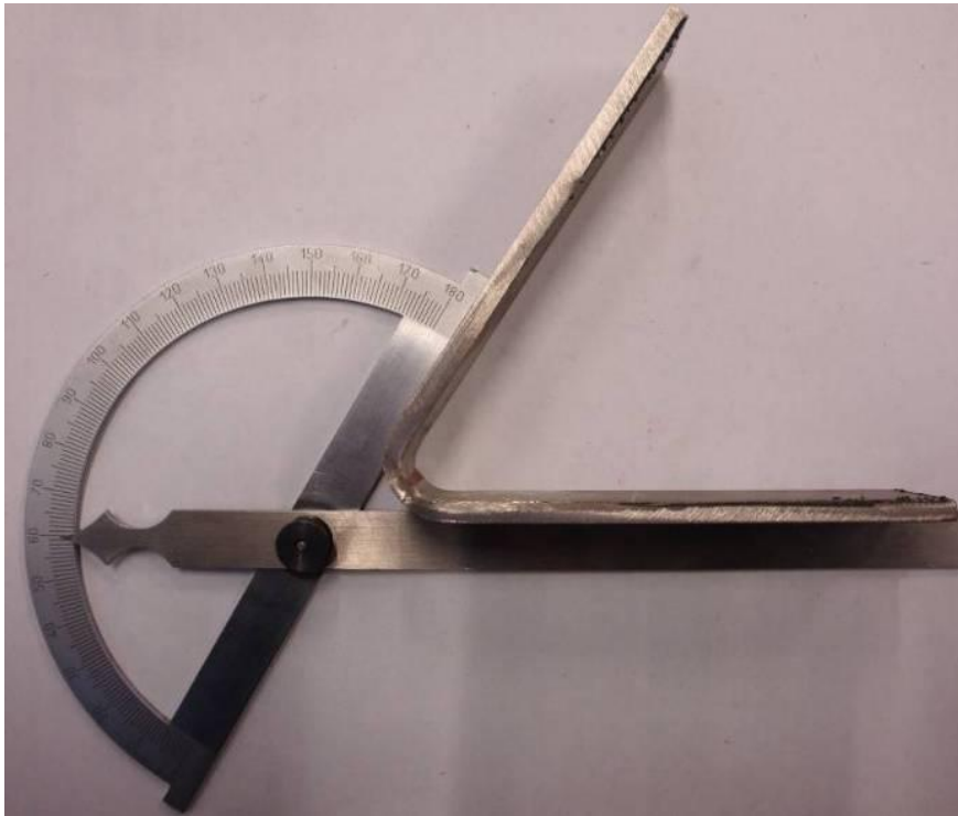
Slika 48. Savijeni uzorak P1A na korijen zavora.
