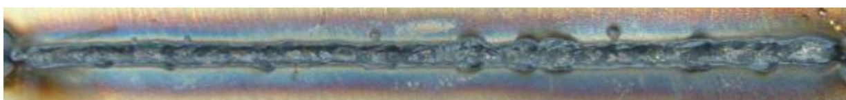
Slika 25. Pokus P2A, korijen zavara.
