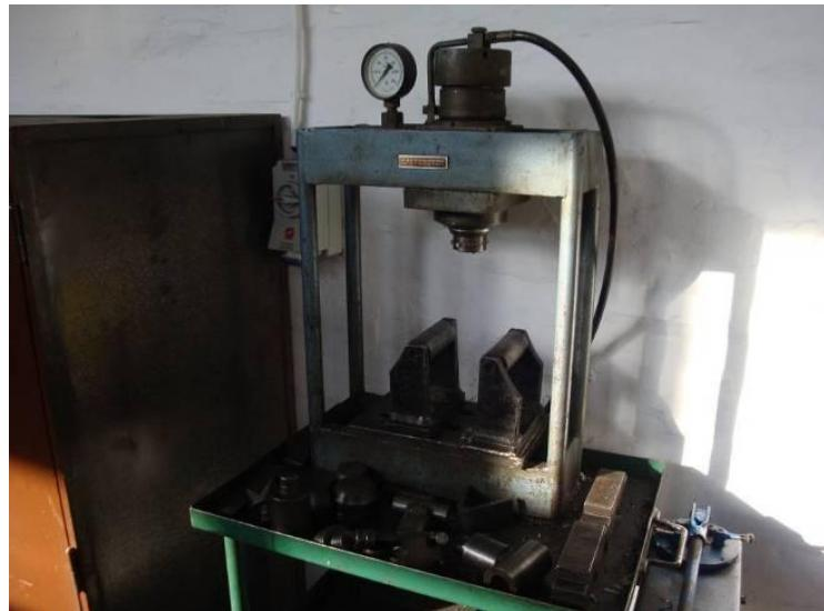
**Slika 44.** Naprava za savijanje uzorka.
