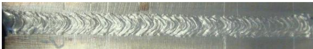
Slika 26. Pokus P3A, lice zavara.
