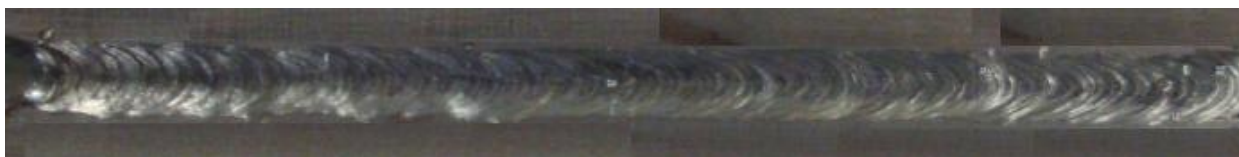
Slika 34. Pokus P2M, lice zavora.
