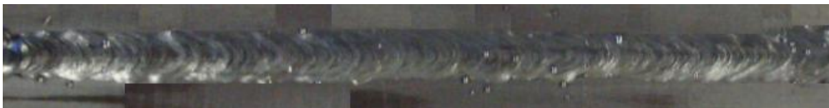
Slika 32. Pokus P1M, lice zavora.
