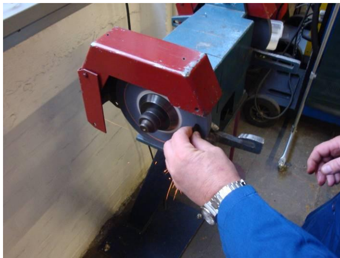
Slika 50. Skidanje srha sa uzoraka.
