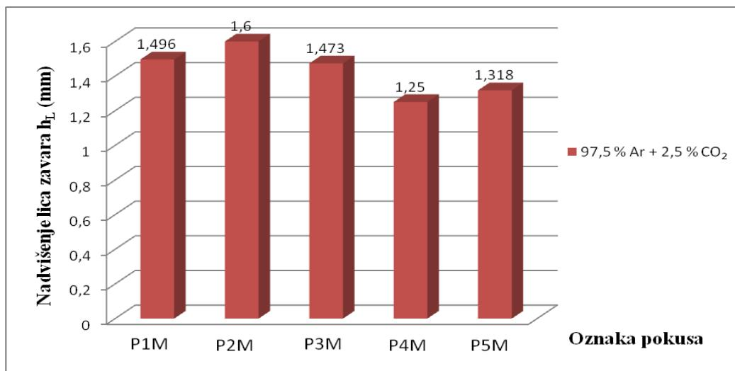
**Slika 64.** Histogram nadvišenja lica zavara, 97,5 % Ar + 2,5 % CO<sub>2</sub>.
