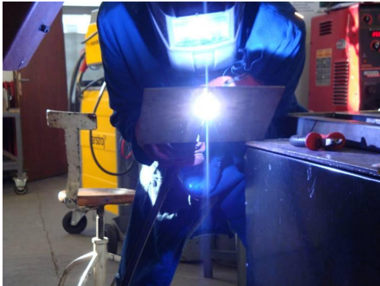
Slika 19. Ručno zavarivanje uzoraka, pogled 2.
