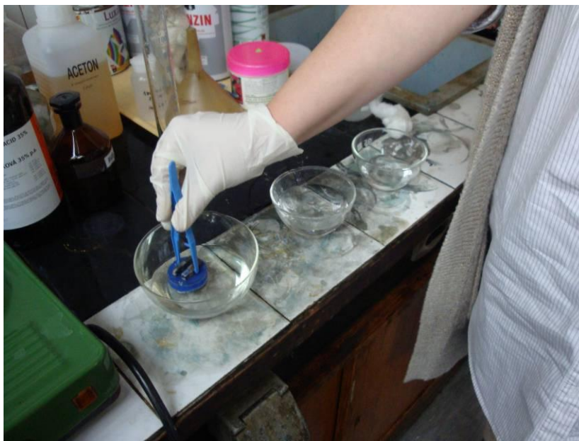
Slika 54. Postupak izazivanja strukture.
