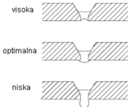
**Slika 2.** Utjecaj osnovne struje na geometriju zavara [3].
