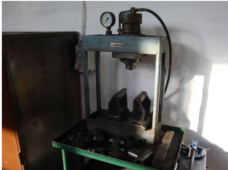
Slika 44. Naprava za savijanje uzoraka.
