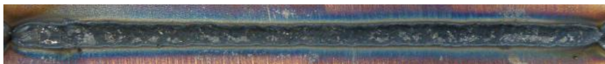
Slika 41. Pokus P5M, korijen zavara.
