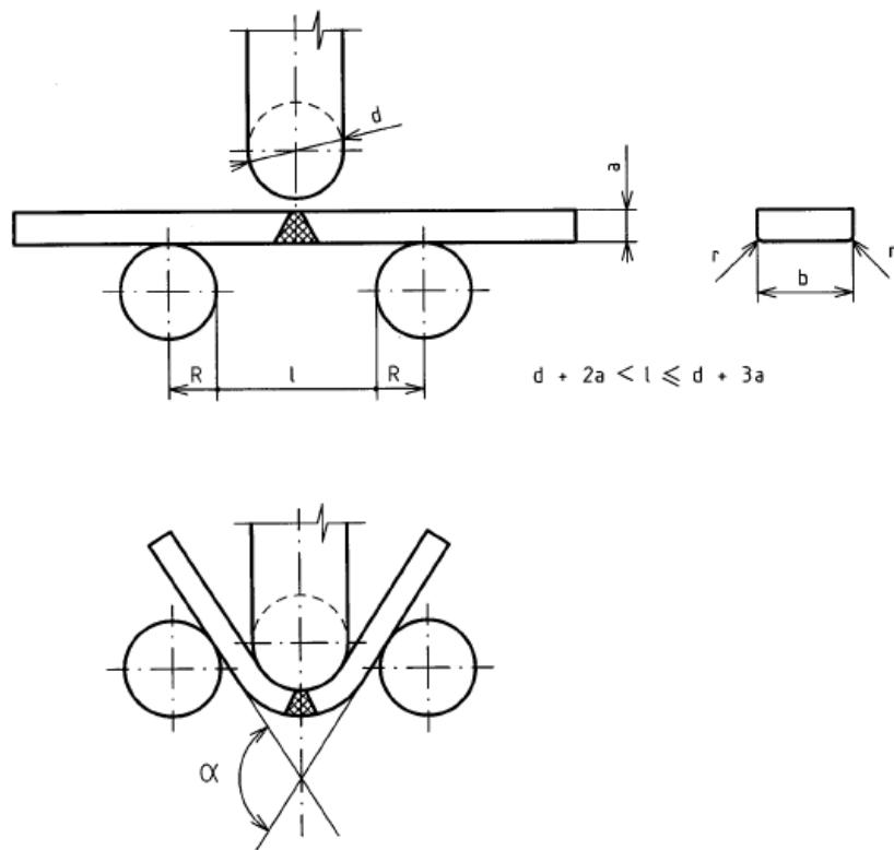
**Slika 43.** Postupak savijanja prema normi EN 910 [22].
