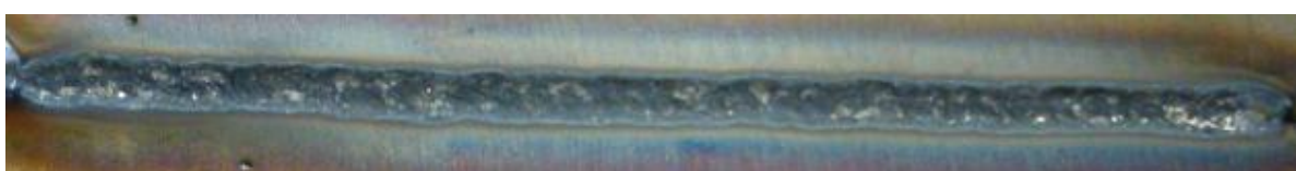
Slika 39. Pokus P4M, korijen zavara.
