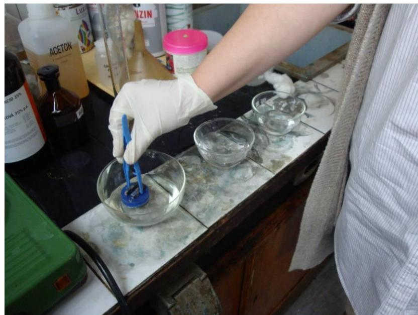
**Slika 54.** Postupak izazivanja strukture.
