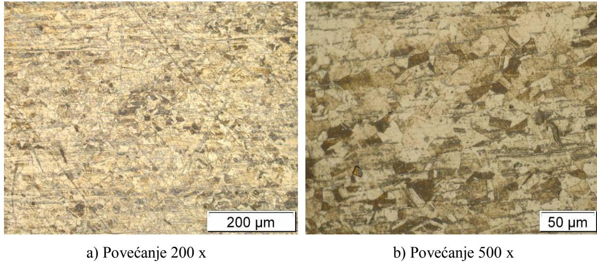
**Slika 56.** Mikrostruktura osnovnog materijala.
