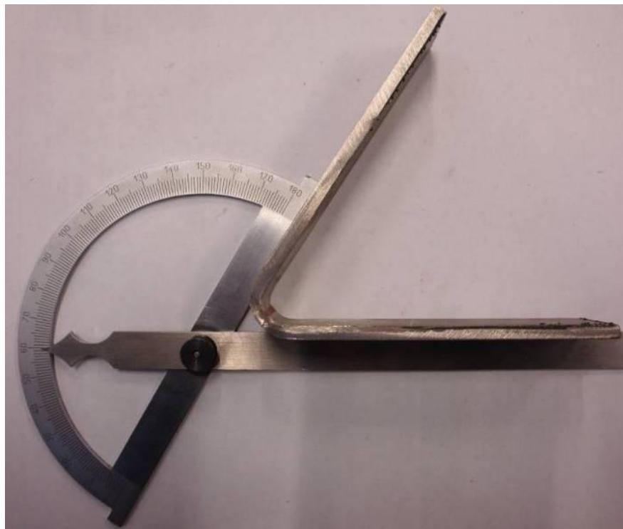
**Slika 48.** Savijeni uzorak P1A na korijen zavara.
