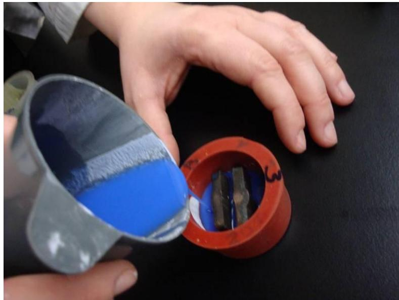
**Slika 51.** Zalijevanje uzorka.
