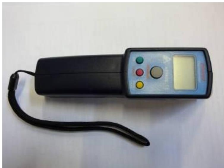
**Slika 12.** IC termometar.
