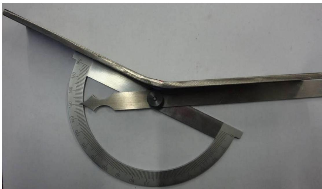
**Slika 49.** Savijeni uzorak P4A na korijen zavara.
