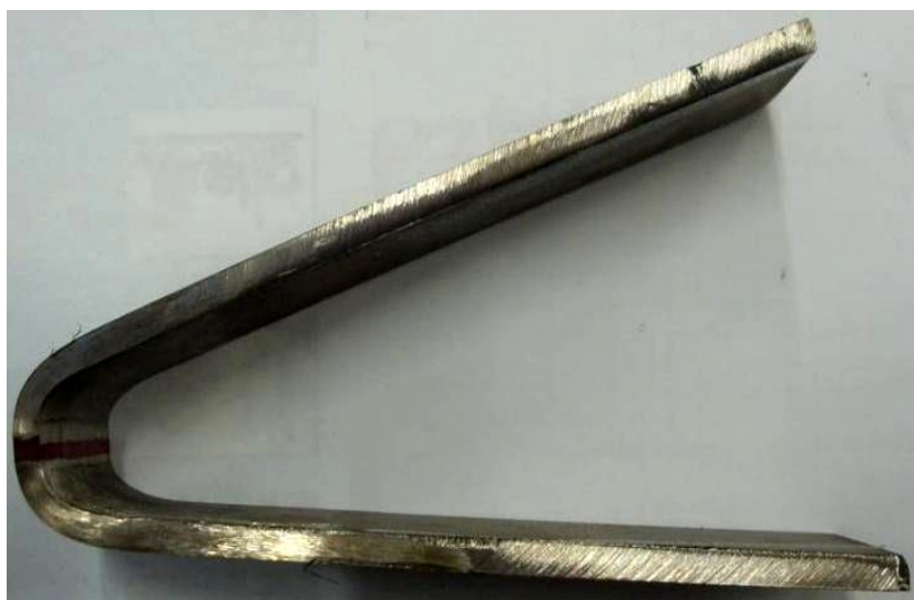
Slika 47. Maksimalno savijen uzorak.
