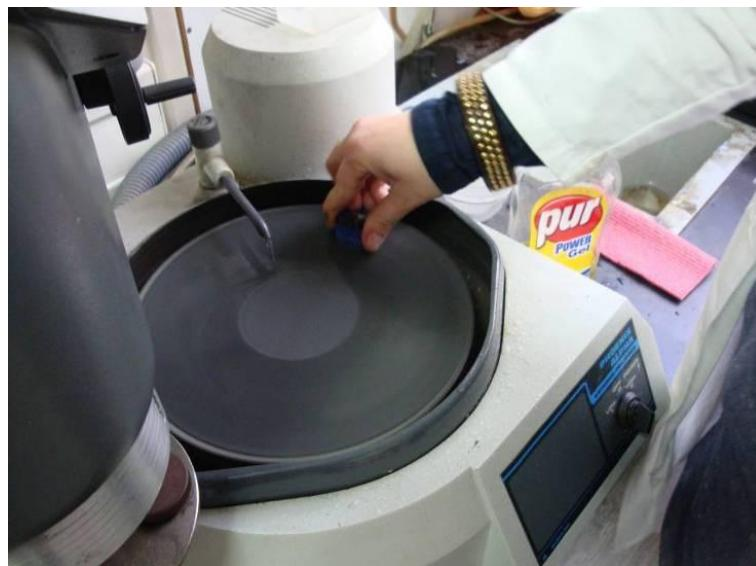
**Slika 53.** Brušenje i poliranje uzorka.
