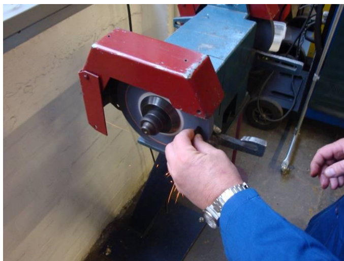
Slika 50. Skidanje srha sa uzoraka.
