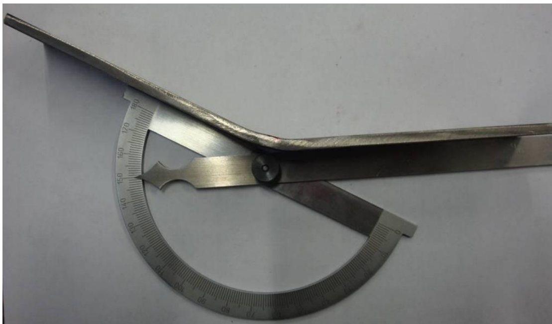
Slika 49. Savijeni uzorak P4A na korijen zavora.
