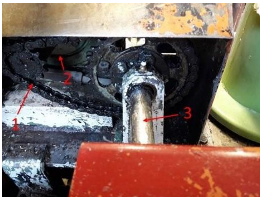
Slika 11. Sustav za okretanje predložaka (1 – lančani prijenos, 2 – prijenosnik snage, 3 – vratilo)
