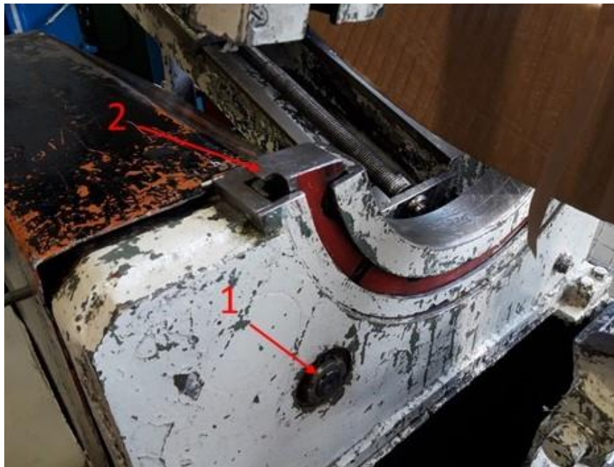
Slika 14. Sustav za namatanje (1 – vratilo, 2 – veliki zupčanik)
