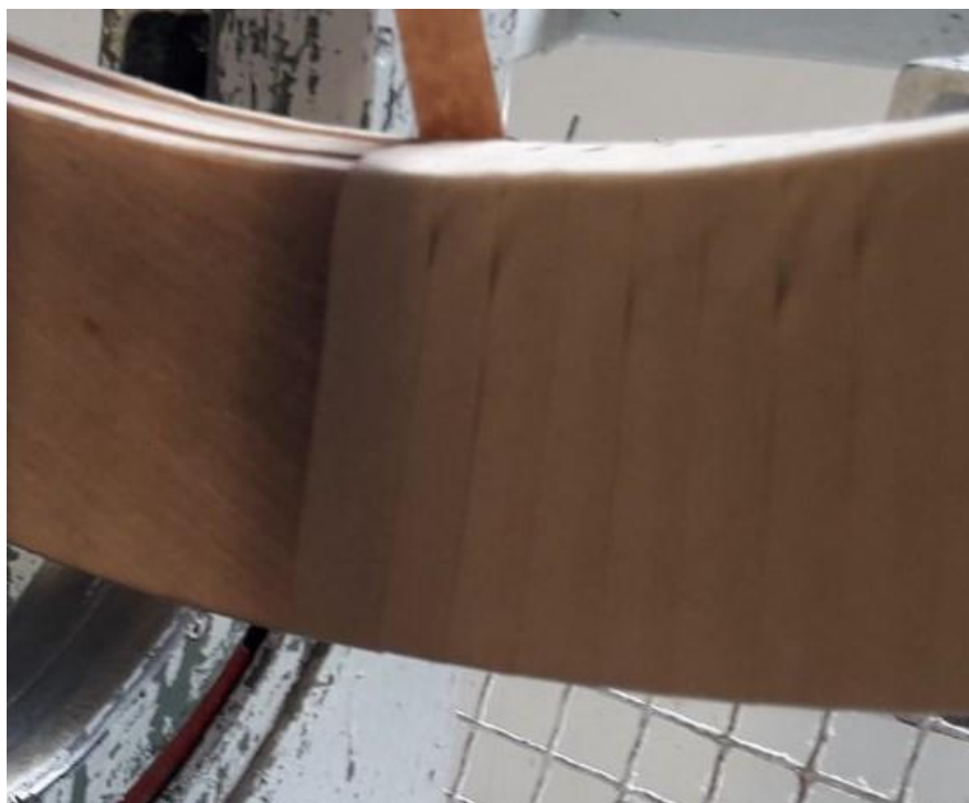
Slika 28. Nepravilno namatanje papira
