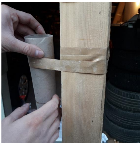
Slika 100. Treći način - namatanje papira na predložak
