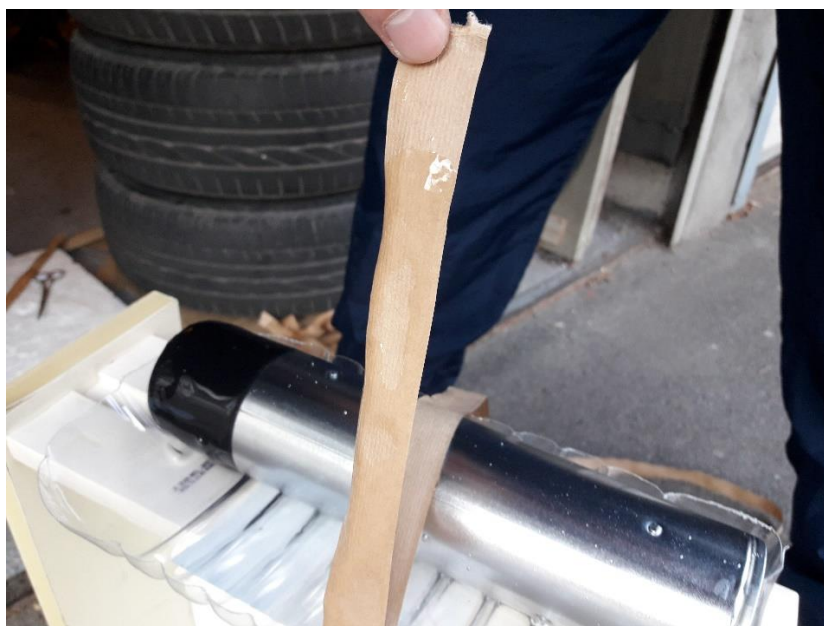
Slika 97. Treći način - neuspješno nanošenje ljepila na papir
