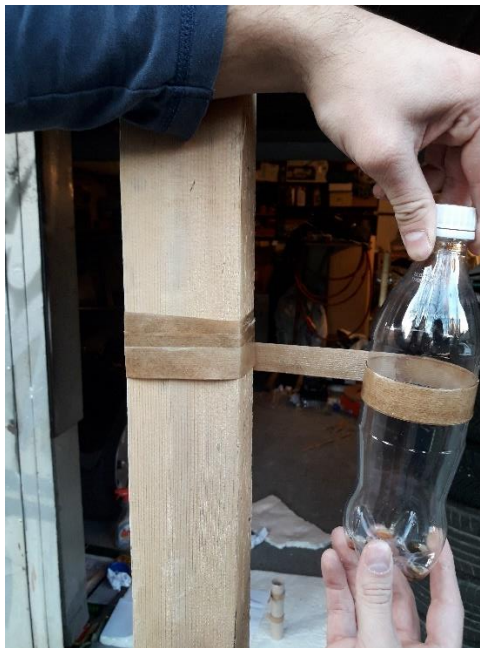
Slika 92. Prvi način - namatanje papira na predložak
