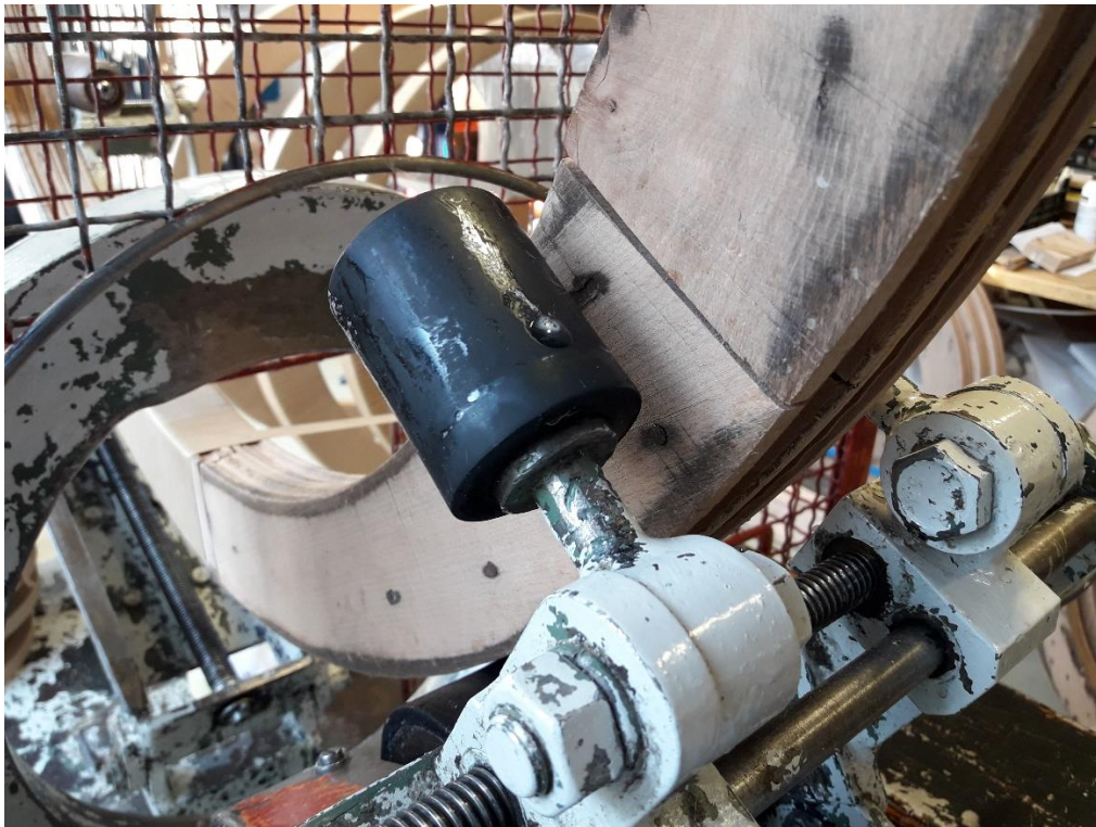
Slika 32. Ostaci ljepila na valjku
