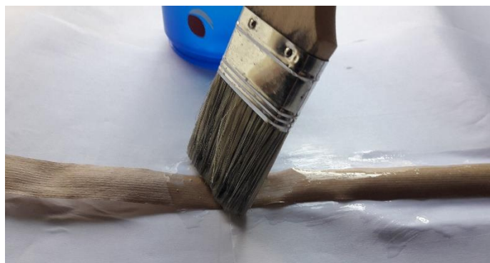
Slika 93. Drugi način - nanošenje ljepila pomoću kista
