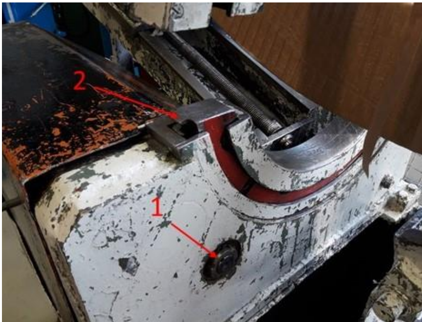
Slika 14. Sustav za namatanje (1 – vratilo, 2 – veliki zupčanik)
