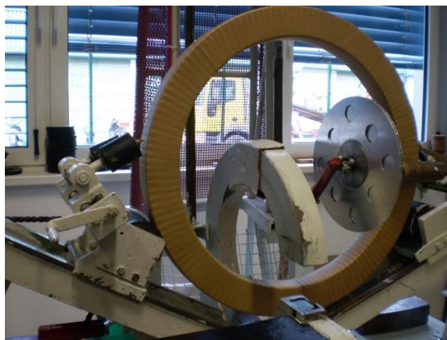
Slika 35. Namatanje najmanjih predložaka bez sigurnosnog kaveza
