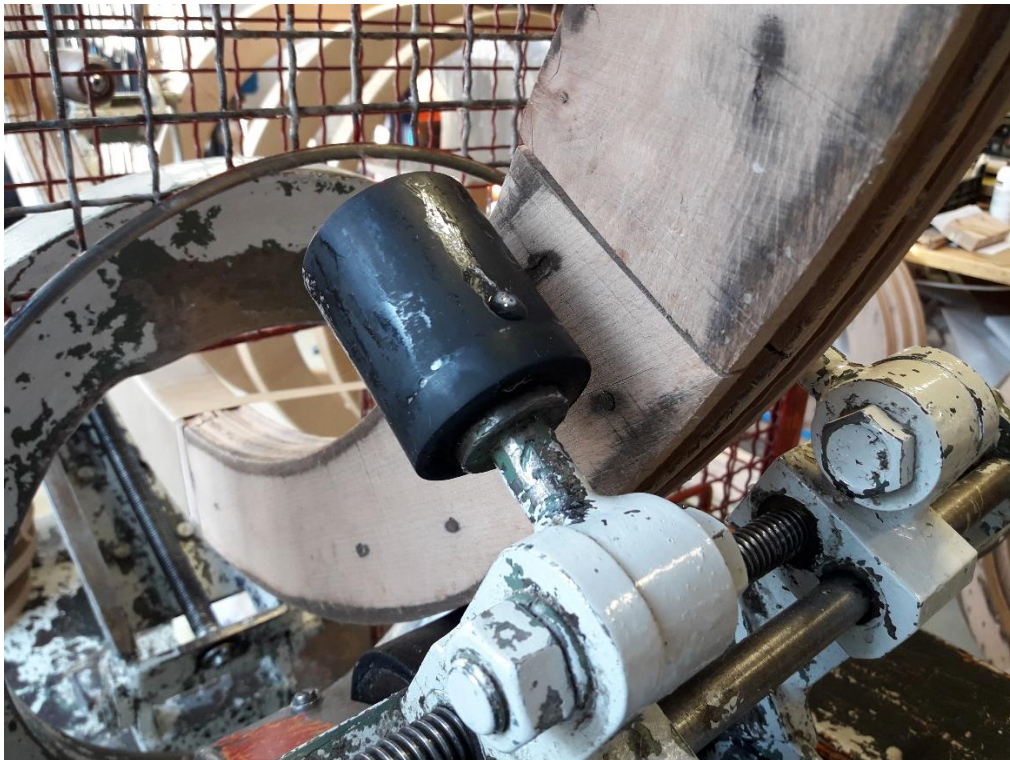
Slika 32. Ostaci ljepila na valjku
