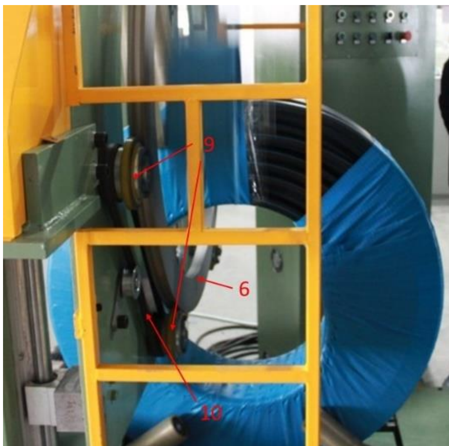
Slika 37. Drugi pogled na stroj za namatanje cijevi FPH-500
