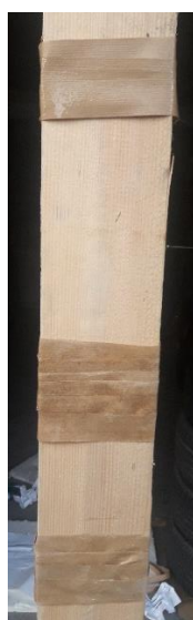
Slika 102. Segmenti namotani na drveni predložak (uspješni eksperimenti)
