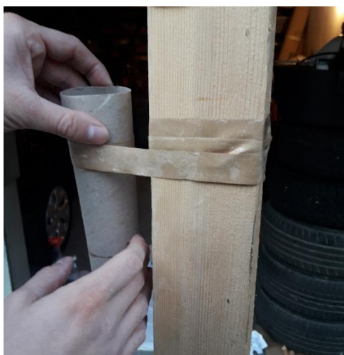
Slika 100. Treći naćin - namatanje papira na predloŹak
