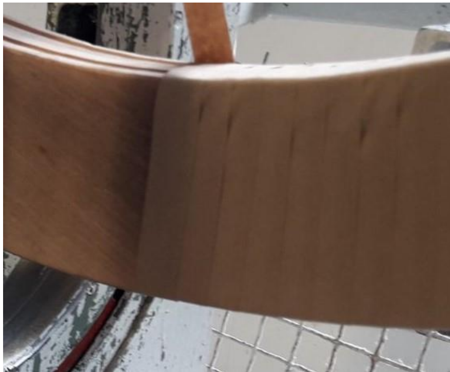
Slika 28. Nepravilno namatanje papira
