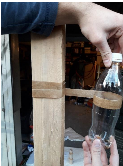
Slika 92. Prvi način - namatanje papira na predložak
