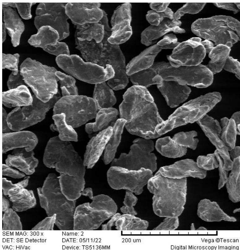
**Slika 17.** Magnezijev prah slikan mikroskopom, uvećanje 300x
