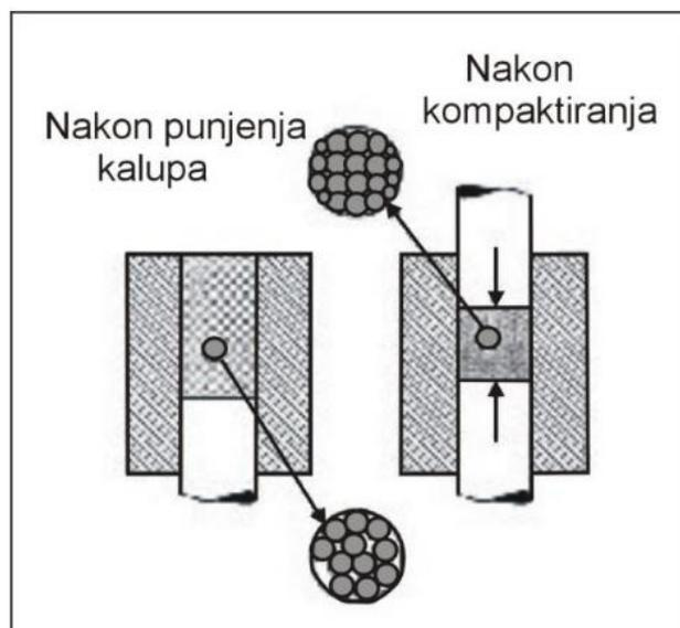
**Slika 9.** Deformacija čestica i uklanjanje poroziteta tijekom kompaktiranja [6]
