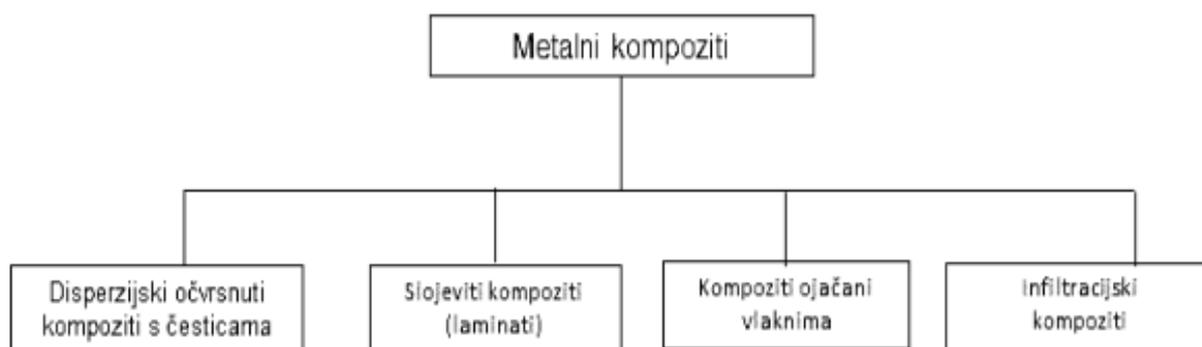
**Slika 2.** Klasifikacija kompozita s metalnom matricom [5]
