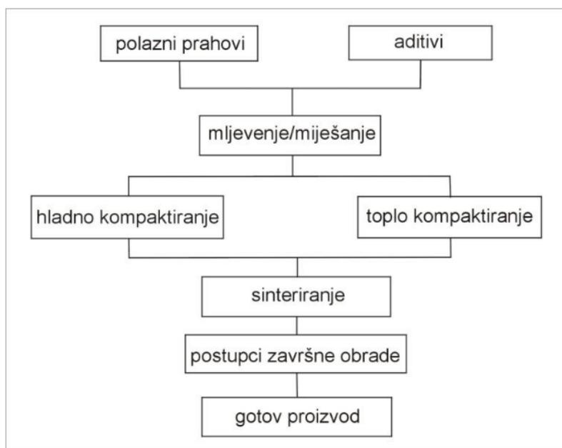
**Slika 5.** Konvencionalni postupci metalurgije praha [7]
