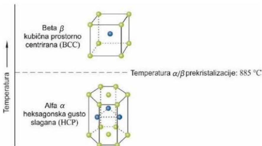
**Slika 13.** Kristalne rešetke čistog titana [18]
