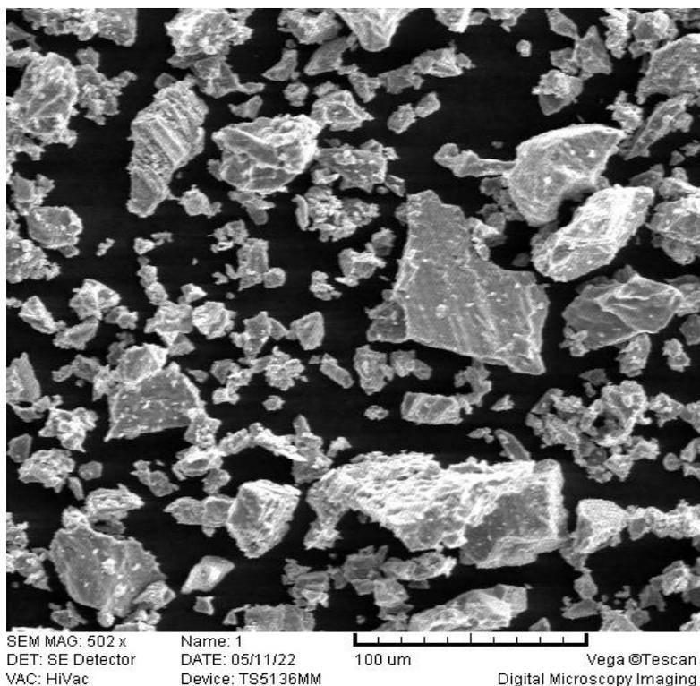
**Slika 16.** Titanov prah slikan mikroskopom, uvećanje 502x
