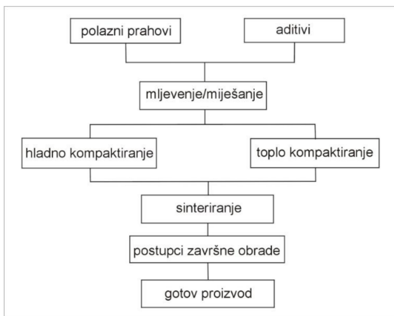
Slika 5. Konvencionalni postupci metalurgije praha [7]
