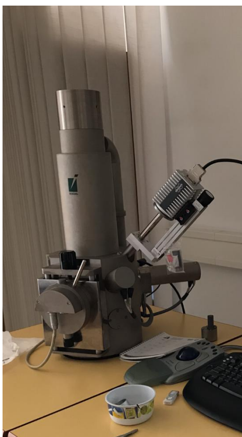
Slika 15. Elektronski mikroskop s EDS detektorom
