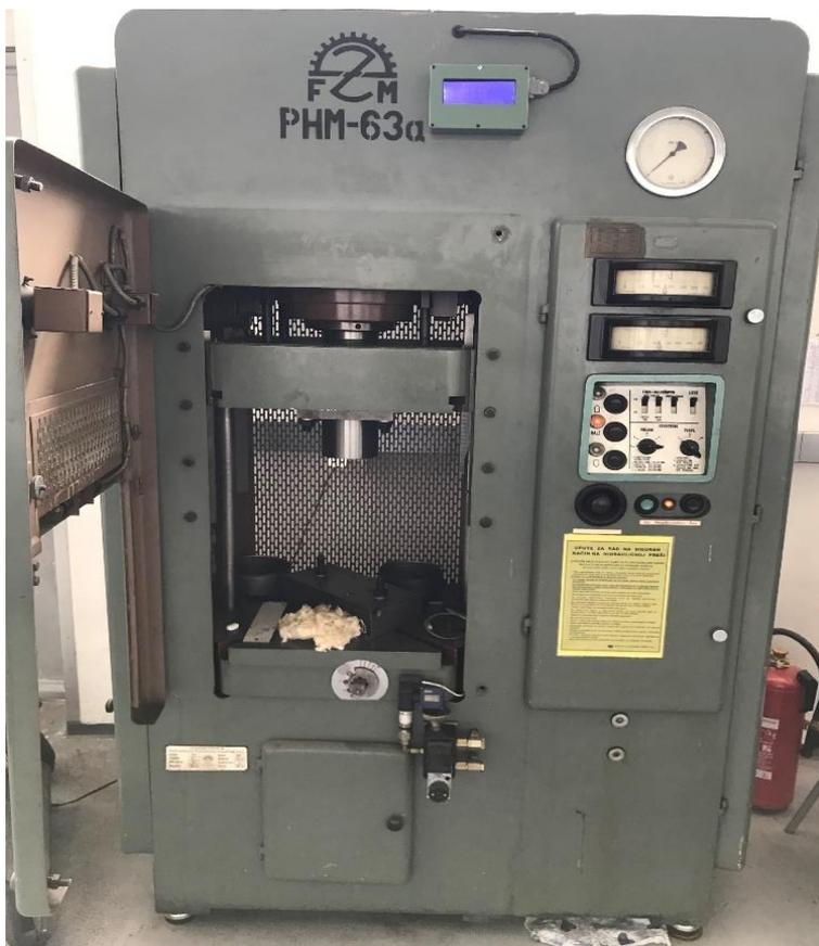
Slika 30. Stroj za hladno izostatsko prešanje
