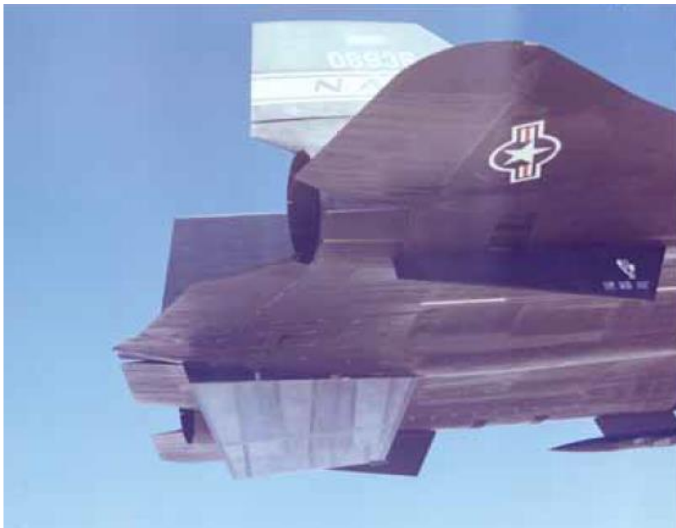
Slika 6: Trbušna peraja vertikalnog stabilizatora lovačkog zrakoplova Lockheed YF-12
