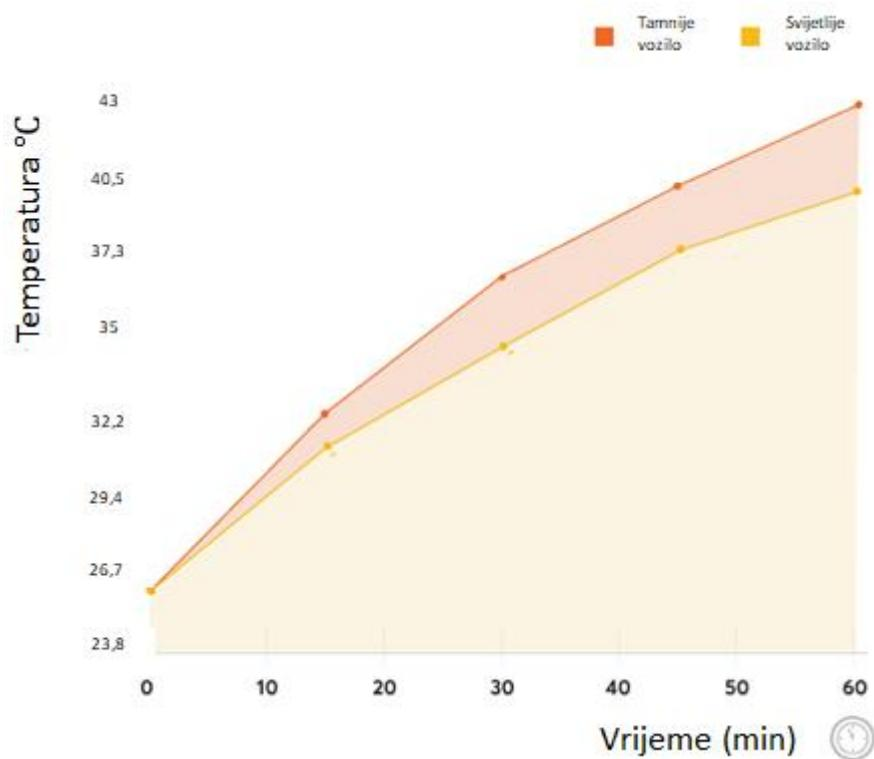
**Slika 2.** Graf porasta temperature u kabini vozila tijekom jednog sata [2]
