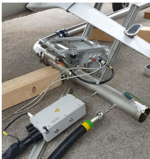
Slika 11. Komponente PEMS uređaja spojene na ispušnu cijev
