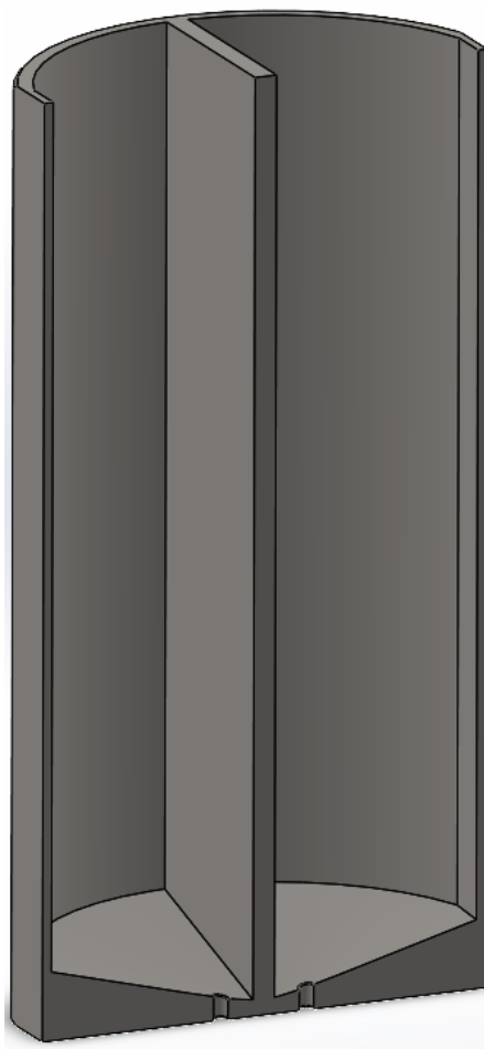
Slika 6. Prikaz konstrukcije mehanizma – oblik spremnika
