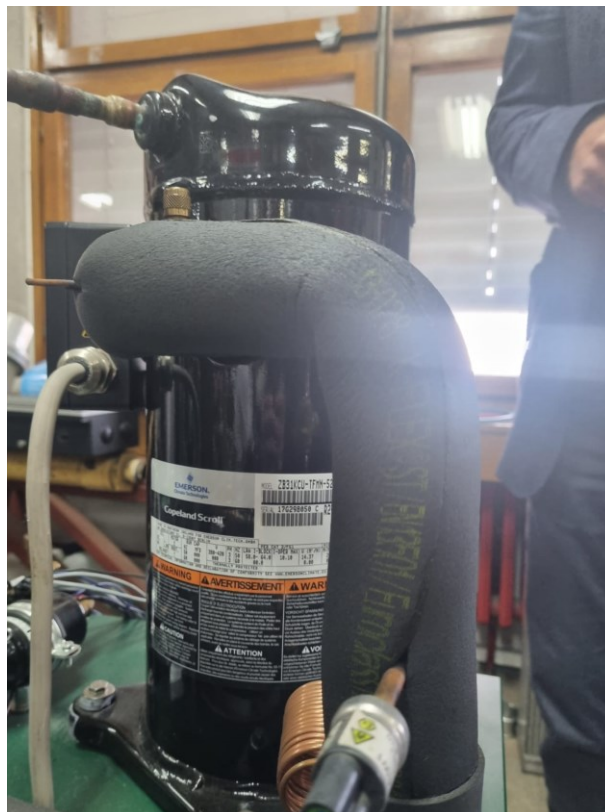
Slika 6. Spiralni („scroll“) kompresor
