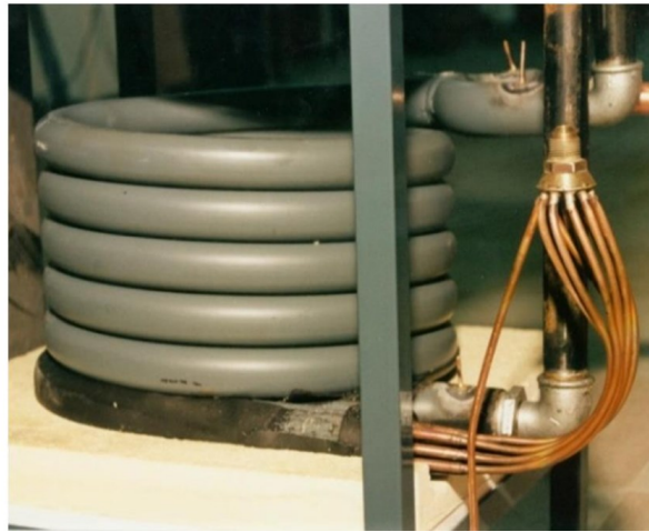
Slika 9. Koaksijalni isparivač eksperimentalnog rashladnog uređaja [3]
