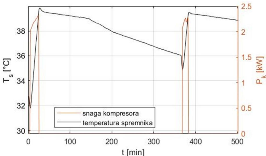
Slika 20. Paljenje geotermalne dizalice topline,  $\Delta T = 3 \text{ } ^\circ\text{C}$
