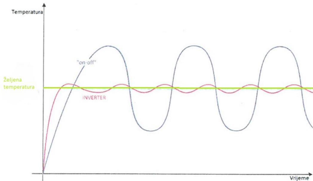
Slika 12. Regulacijska karakteristika inverterskog i „on-off“ načina upravljanja [1]
