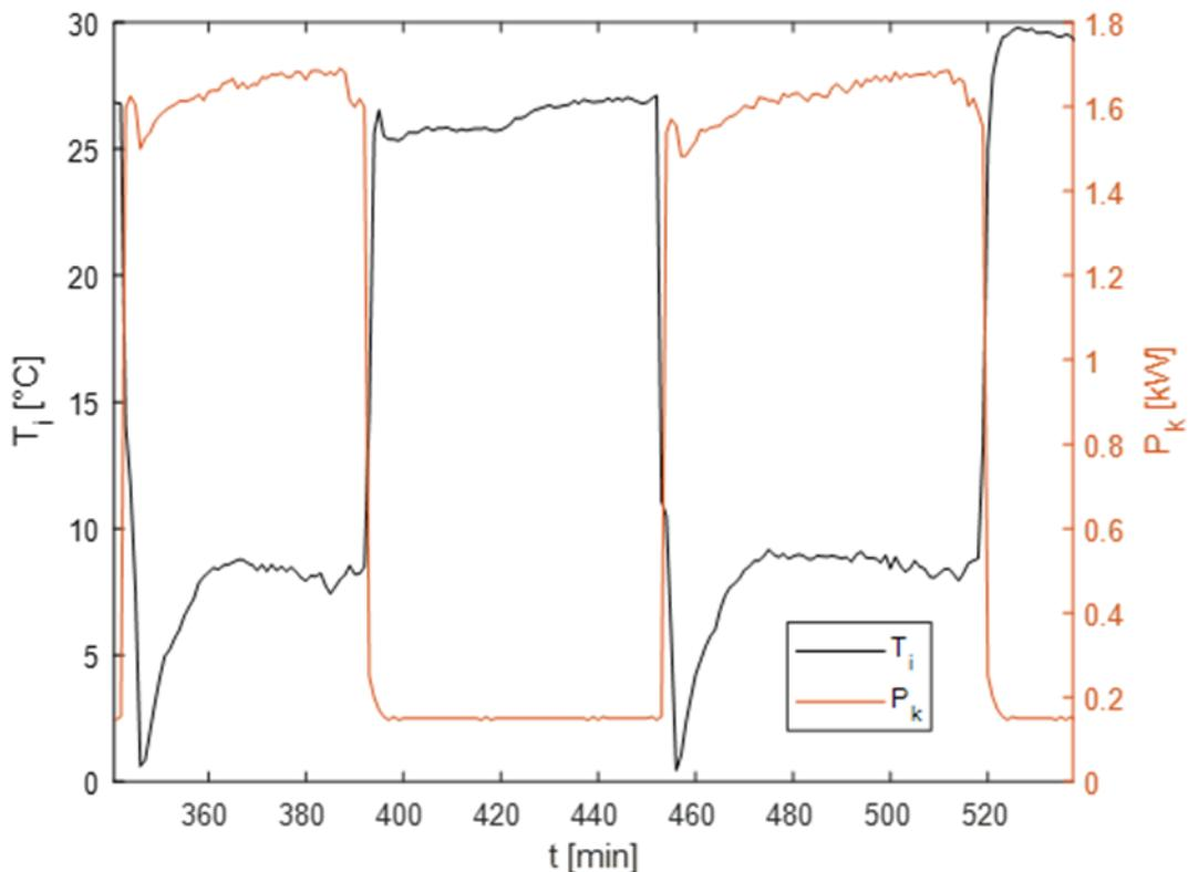
*Slika 26. Kretanje temperature isparavanja u sustavu s frekvencijskom regulacijom,  $\Delta T=3^{\circ}\text{C}$*
