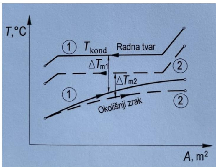
Slika 19. Promjena temperature na kondenzatoru s promjenom broja okretaja kompresora
