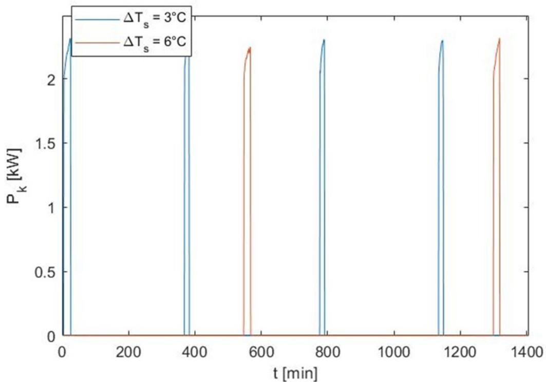
Slika 24. Usporedba intervala paljenja u ovisnosti o histerezi,  $\Delta T=3\text{ }^\circ\text{C}, 6\text{ }^\circ\text{C}$
