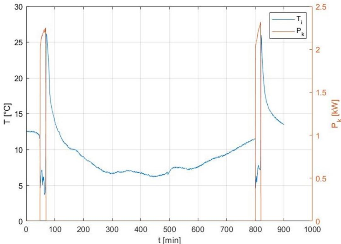
*Slika 23. Kretanje temperature isparavanja pri „on/off“ regulaciji,  $\Delta T=6^{\circ}\text{C}$*
