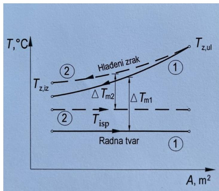
Slika 18. Promjena temperature na isparivaču s promjenom broja okretaja kompresora
