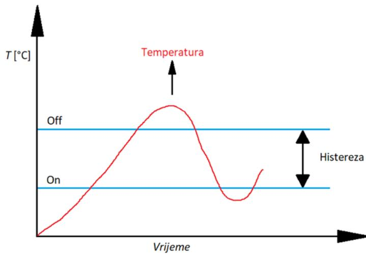
Slika 14. Dijagram prikaza rada uređaja s „on/off“ regulacijom
