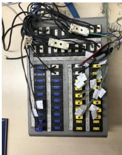
Slika 10. Akvizicijski sustav Agilent 34970 A [2]
