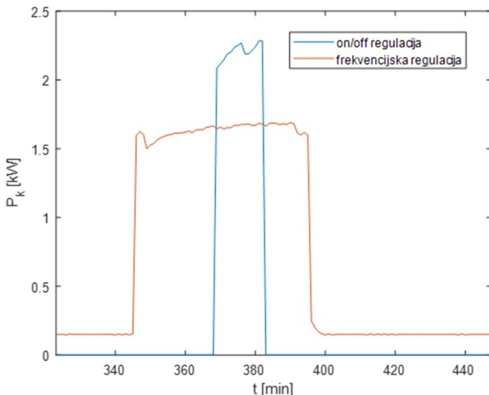
Slika 25. Usporedba ciklusa paljenja s i bez frekvencijskog pretvarača,  $\Delta T=3^{\circ}\text{C}$
