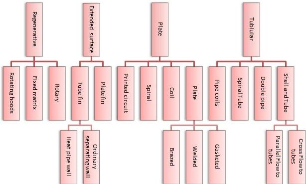
Slika 13 Klasifikacija po geometrijskim značajkama/konstrukciji
