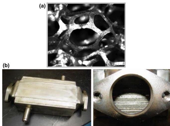
**Slika 14 a) Metalna pjena s otvorenim čelijama b) Pjenasti izmjenjivač topline**
