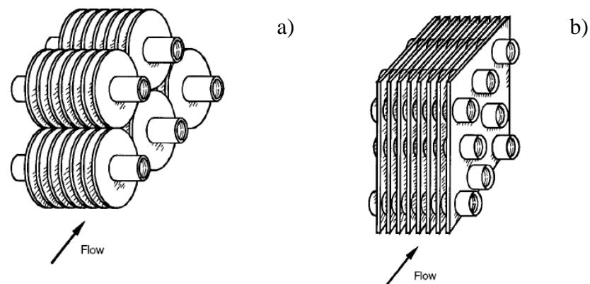
Slika 6 a) Pojedinačno orebreni cijevni izmjenjivač b) Cijevni izmjenjivač s ravnim rebrom
