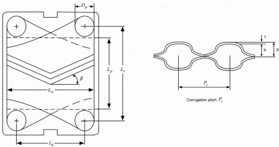
**Slika 15 Struktura ševron ploče (eng. chevron plate)**
