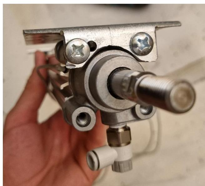
**Slika 25. Kutni profil za pričvršćivanje cilindra**
