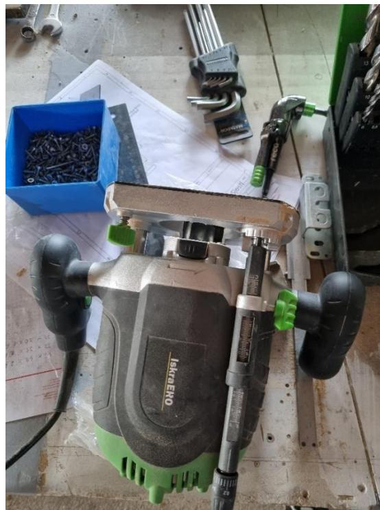
Slika 21. Ručna glodalica
