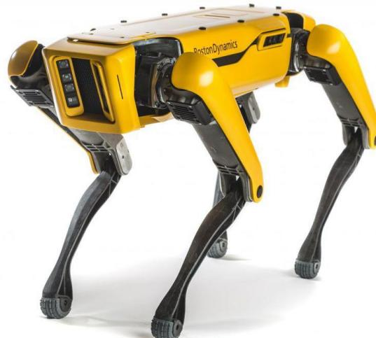
**Slika 2.** Četveronožni hodajući robot [4]
