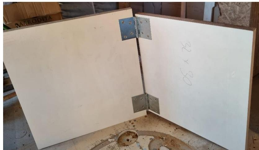
**Slika 24. Spoj ploče naslona za noge i spojne ploče**
