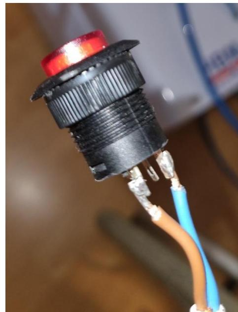
**Slika 54. Žica i prekidač spojeni lemom**
