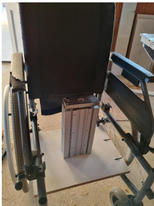
**Slika 13. Donja ploča s ugrađenim cilindrom za podizanje**
