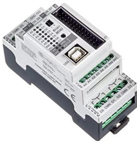
Slika 49. Upravljački uređaj Controllino Mini
