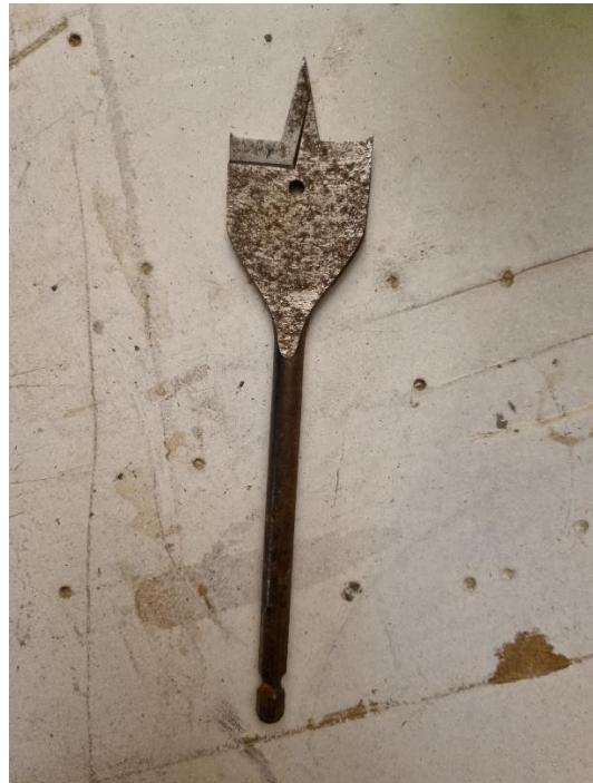
**Slika 14. Srvdlo Ø32 korišteno za bušenje rupa**
