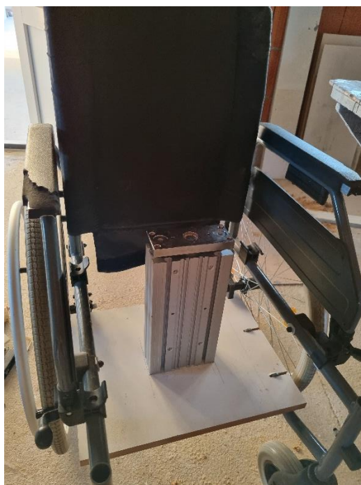
Slika 13. Donja ploča s ugrađenim cilindrom za podizanje
