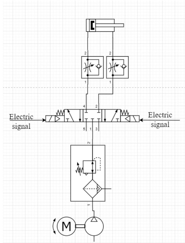
Slika 47. Pneumatska shema za jedan aktuator sustava
