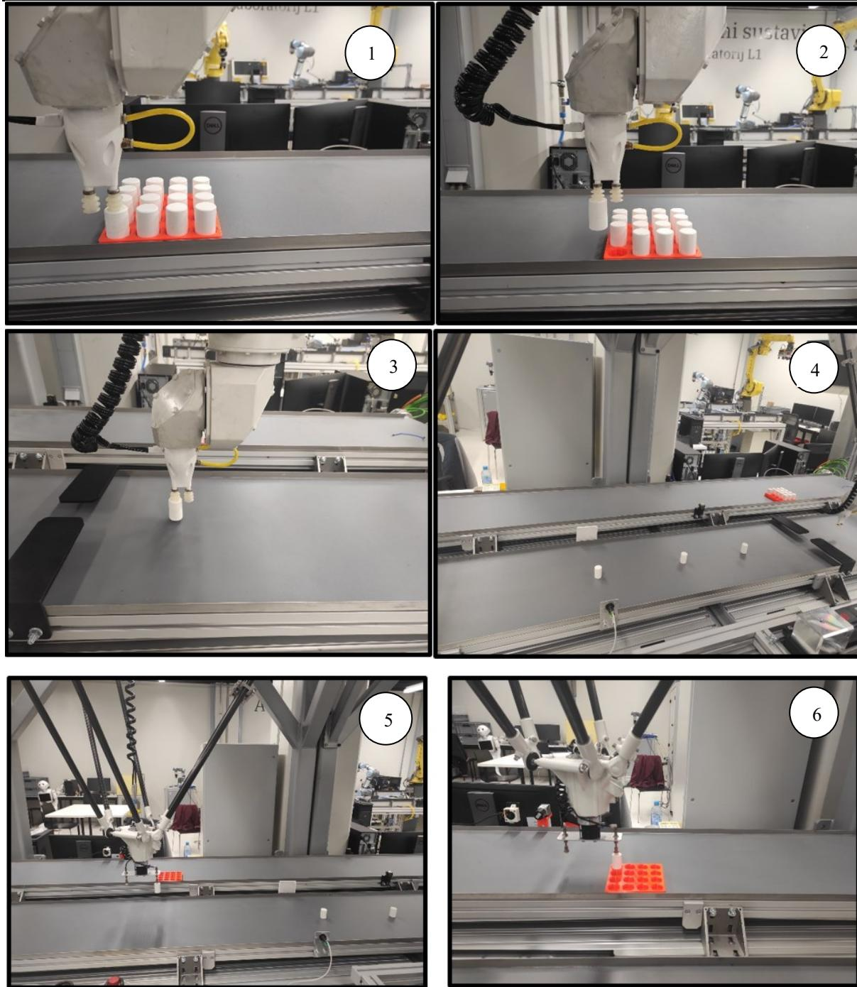
1 – M-3 robot prilazi do prvoga predmeta, 2 – depaletizacija (izuzimanje) predmeta, 3 – odlaganje predmeta na pokretnu traku, 4 – kretanje više predmeta po traci pokraj optičkoga senzora, 5 – praćenje predmeta u pokretu i njegovo izuzimanje s DR-3 robotom, 6 – paletizacija predmeta s DR-3 robotom
