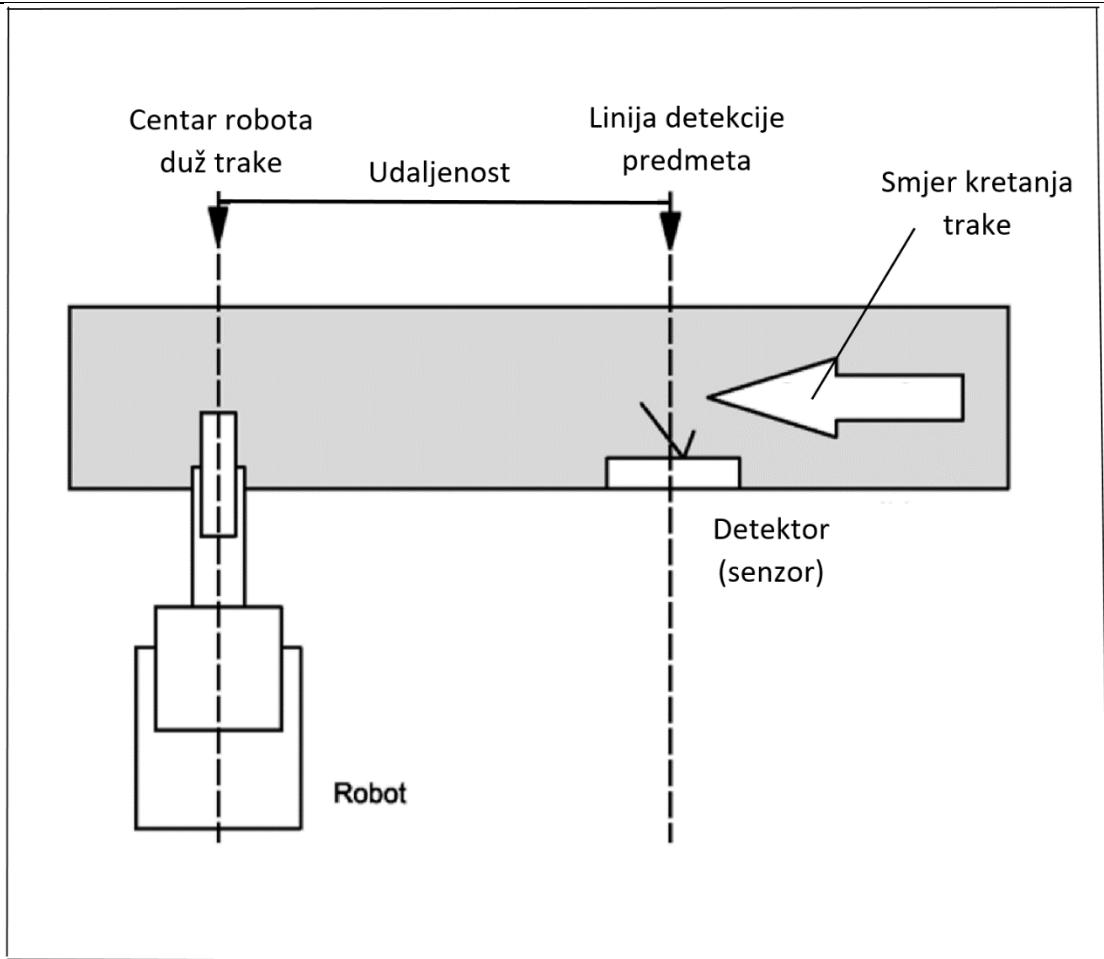
**Slika 25: Mjerenje udaljenosti senzora [8]**
