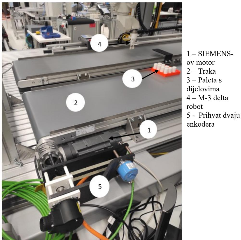
**Slika 8: Druga pokretna traka s nosačem enkodera**
