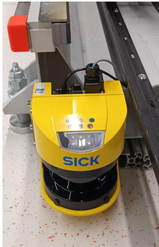
Slika 18: Sick laserski senzor
