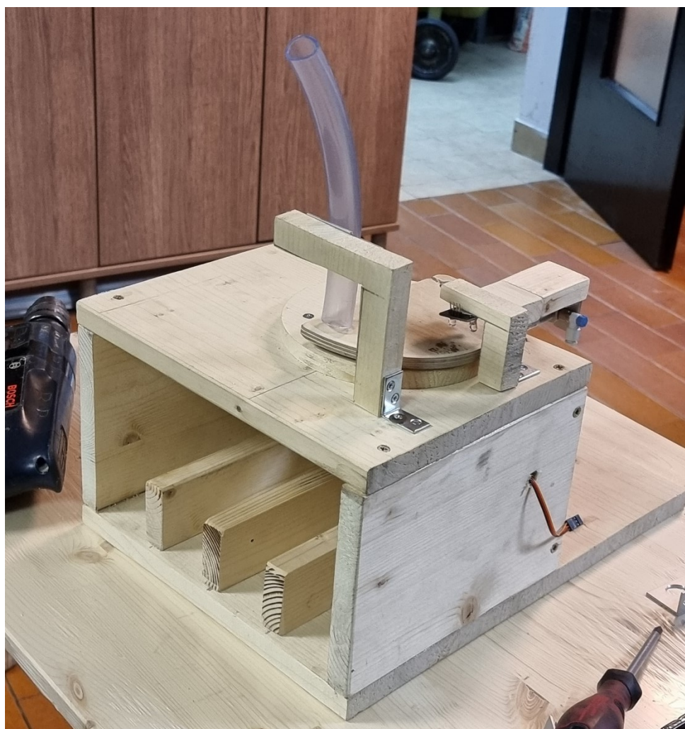
Slika 16. Izrađeni sustav za dobavu predmeta
