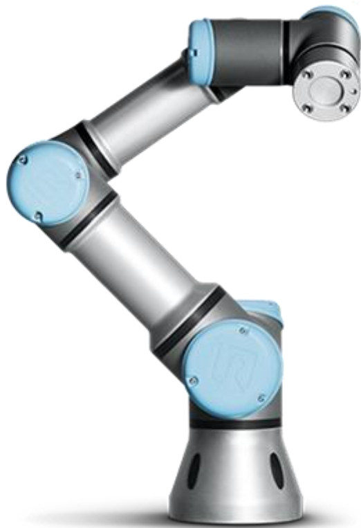
Slika 5. UR3 robotska ruka [14]
