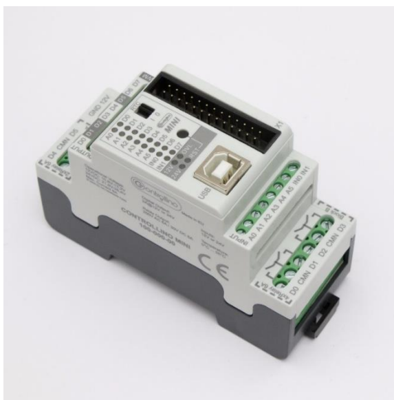
Slika 20. Upravljački uređaj Controllino mini
