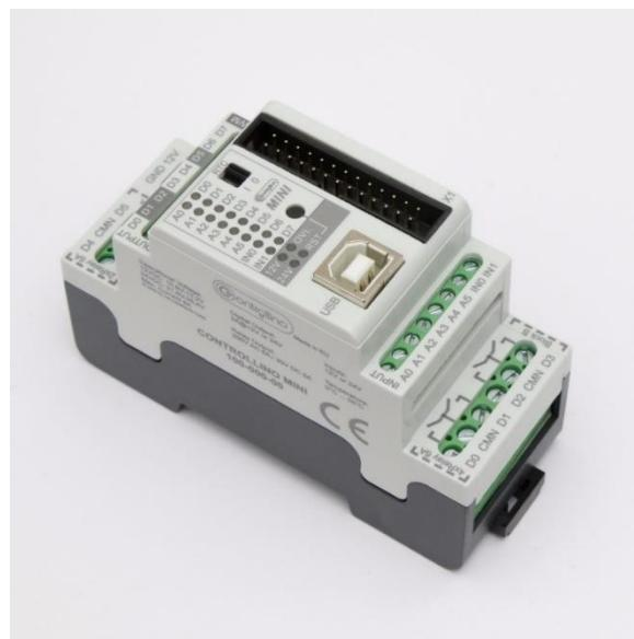
Slika 20. Upravljački uređaj Controllino mini
