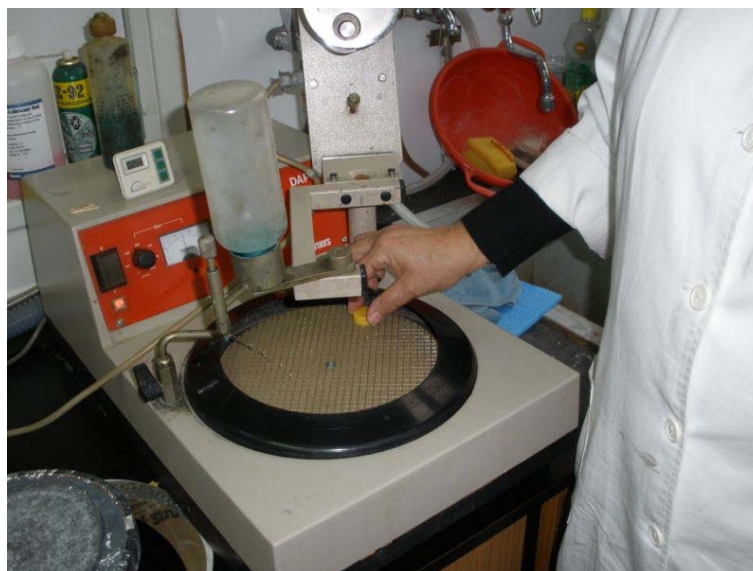
Slika 6. Uređaj za brušenje i poliranje keramike
