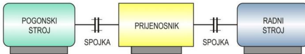
Slika 20. Shematski prikaz funkcije spojke [21]
