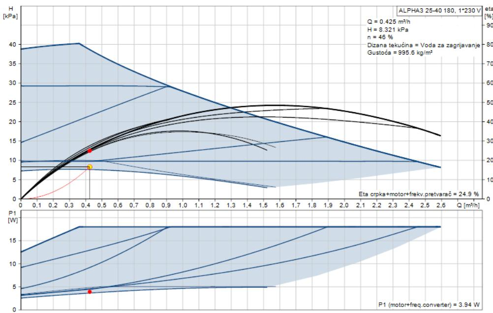
Slika 3.14. Radne karakteristike pumpe Grundfos ALPHA3 25-40 180[14]
