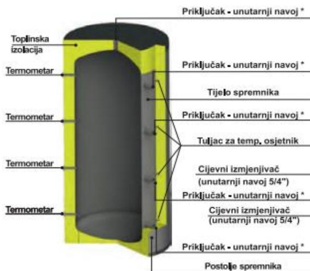
Slika 3.11. *Centrometal CAS 301* s pripadajućim elementima unutar spremnika
