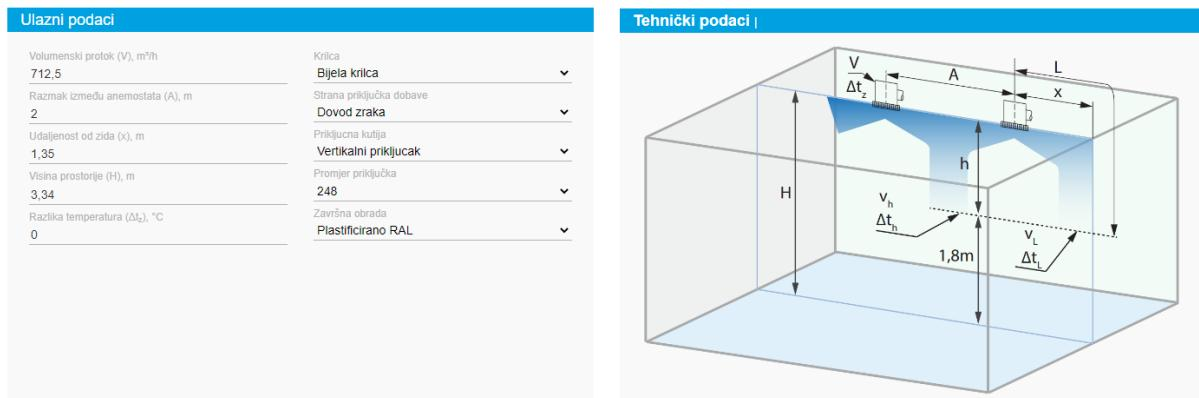
Slika 5.5. Parametri za odabir distributera dobavnog zraka
