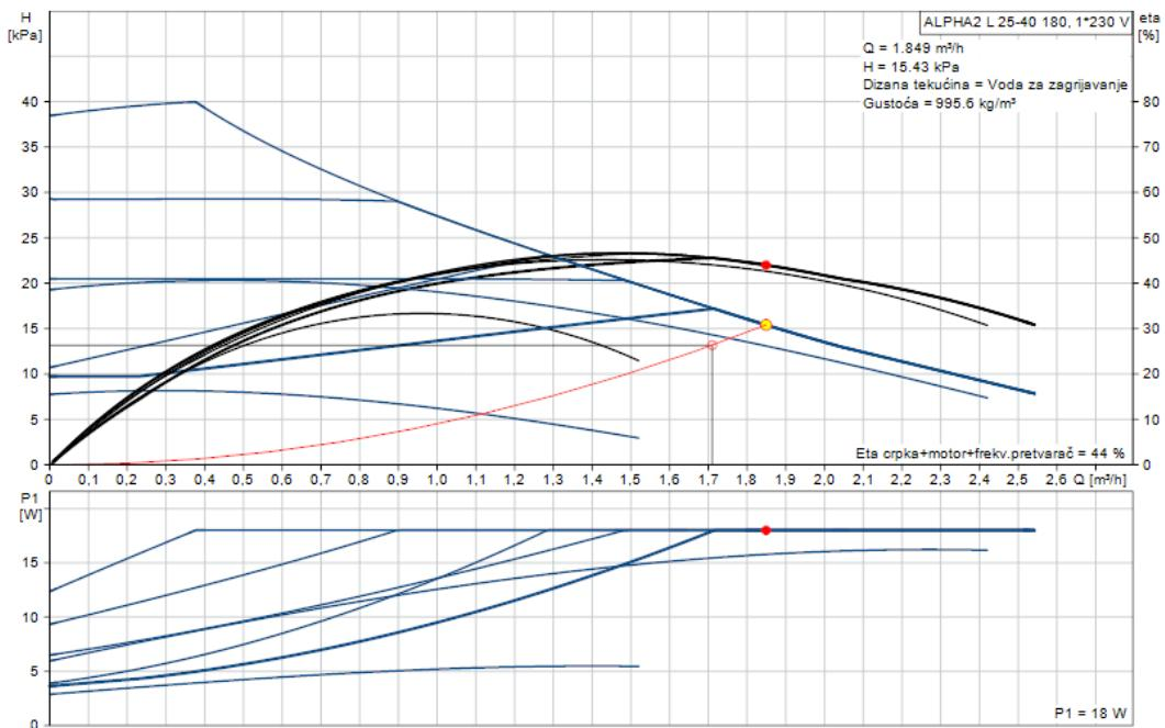
Slika 3.16. Radne karakteristike pumpe Grunfos ALPHA2 L 25-40-180[14]
