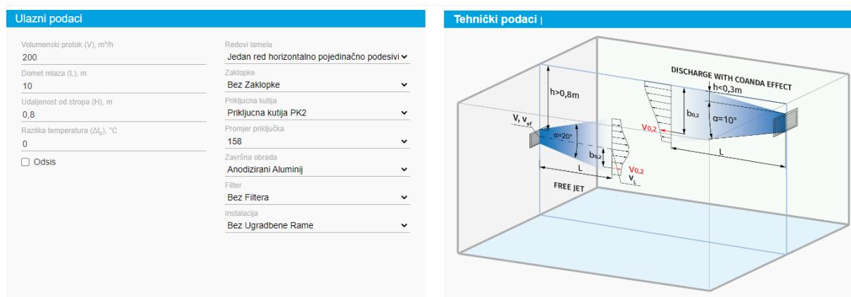
Slika 5.1. Parametri za odabir rešetki dobavnog zraka
