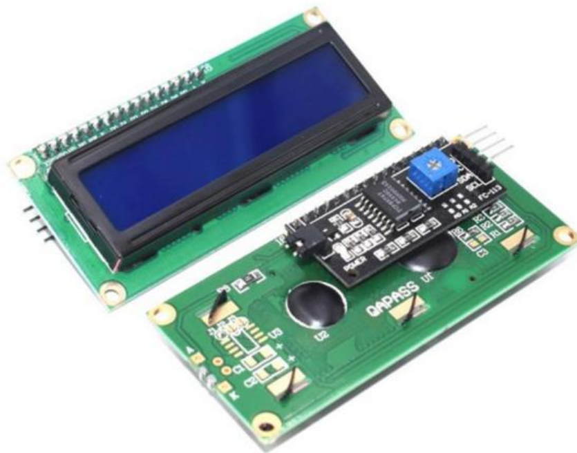
Slika 10. LCD zaslon s I2C kontrolerom [9]
