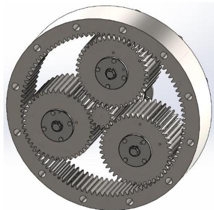
Slika 10. Planetarni reduktor 1UV s 3 planetarna zupčanika
