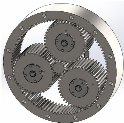
Slika 10. Planetarni reduktor 1UV s 3 planetarna zupčanika
