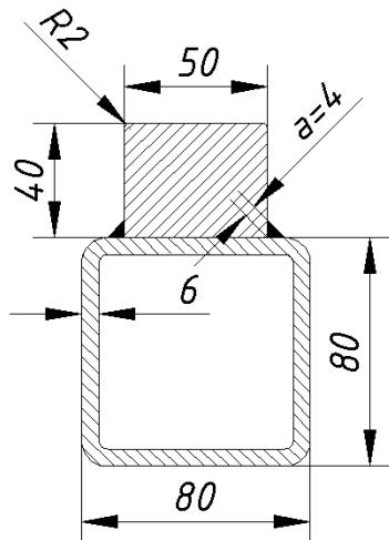
Slika 9.4 Detalj spoja tračnice na nosaču okretnog postolja
