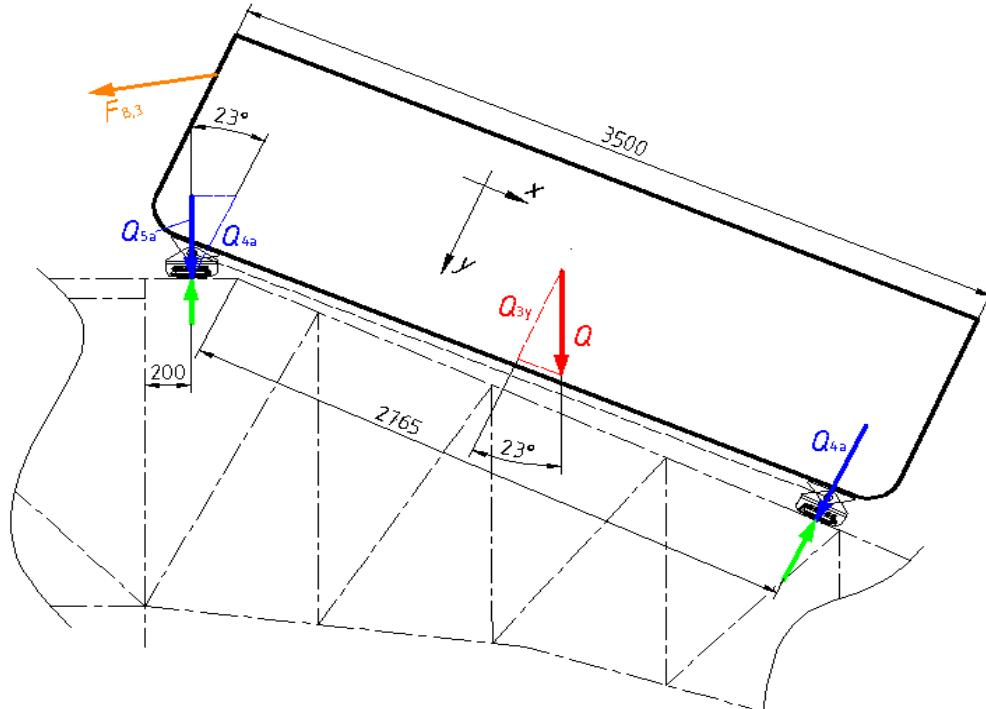
Slika 5.7 Analiza sila, podizna platforma-brod na prijelazu na gornji okretni dio platforme
