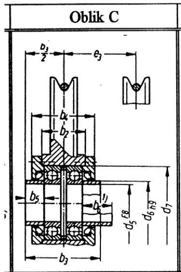
Slika 11.5 Oblik C užnice i mjere za dimenzioniranje
