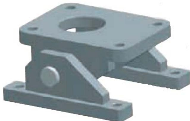
Slika 7.14 Zglobni ležaj s postoljem HSE - 80 uređaja
