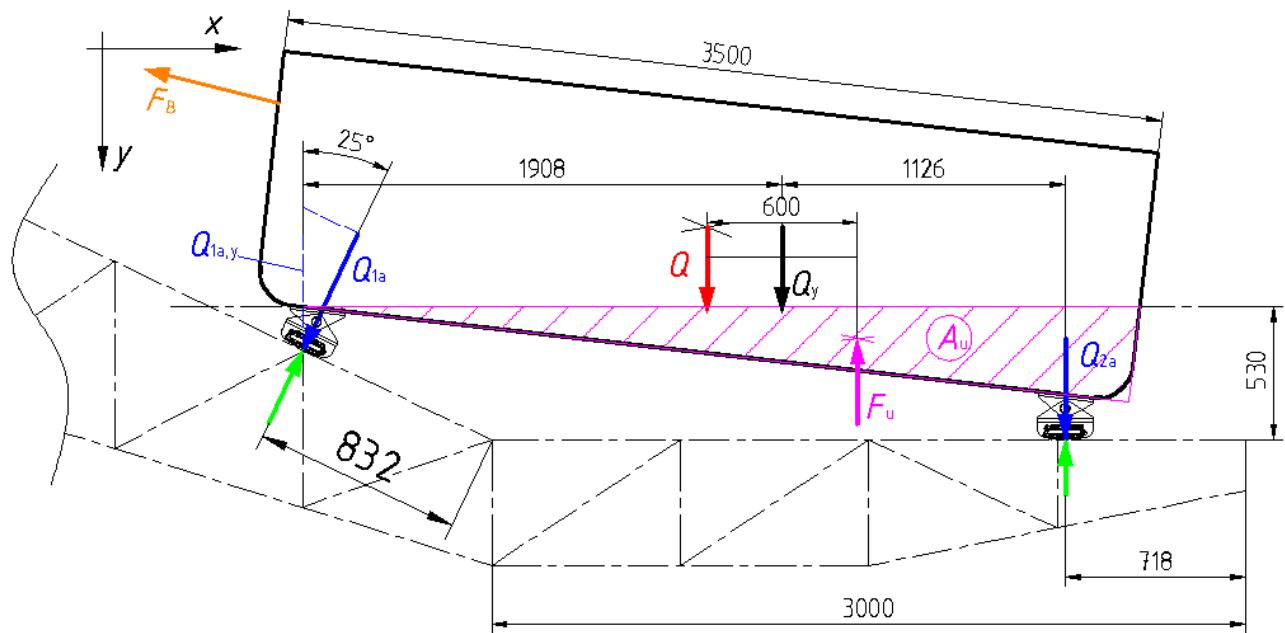
Slika 5.1 Analiza sile, podizna platforma-početak izvlačenja broda
