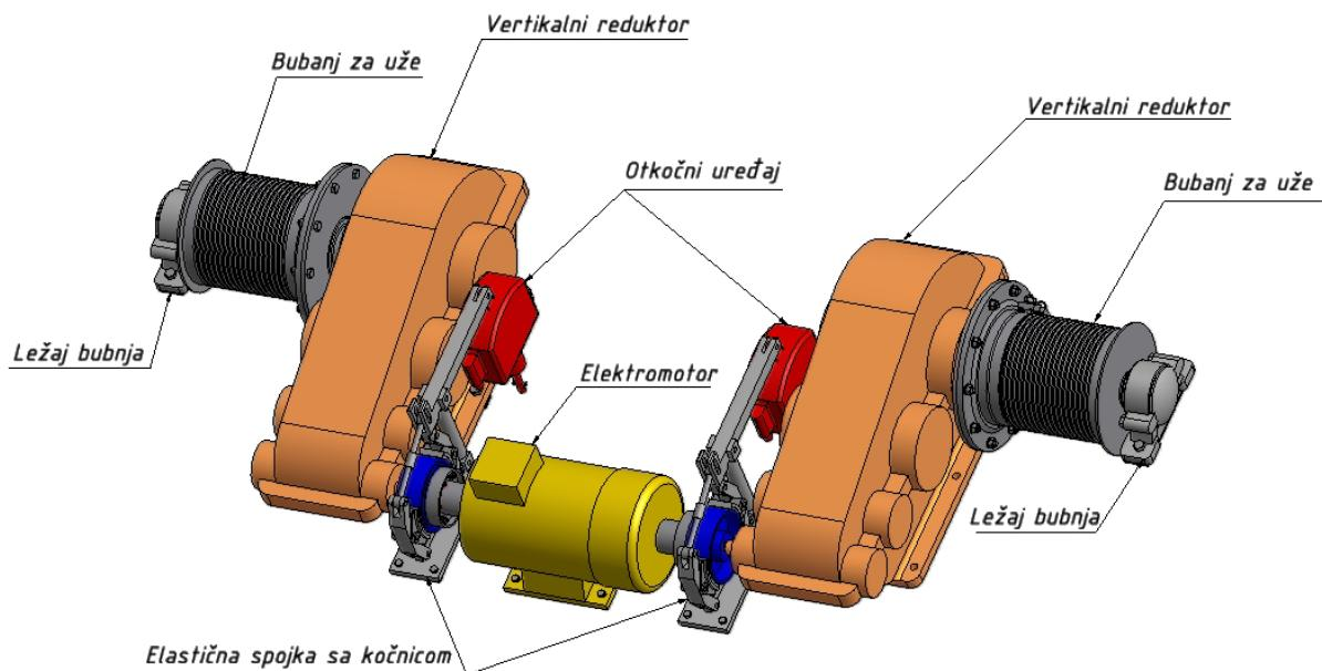
Slika 11.1 Sklop uređaja za izvlačenje broda iz vode
