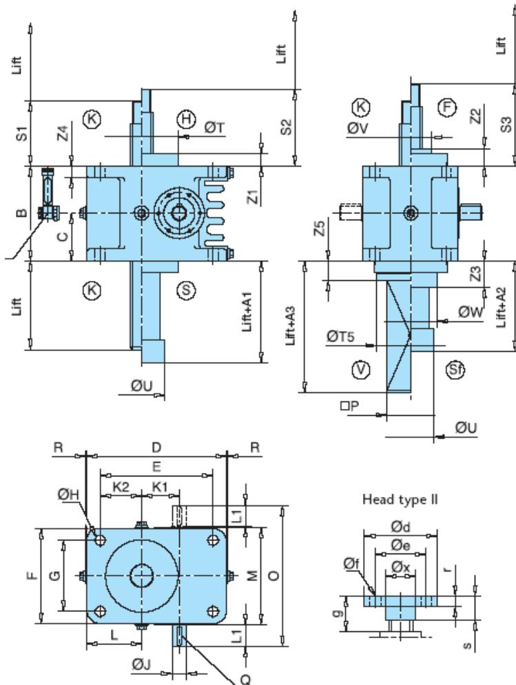
Slika 7.13 HSE - 80 dimenzije uređaja i oblik prihvratne glave
