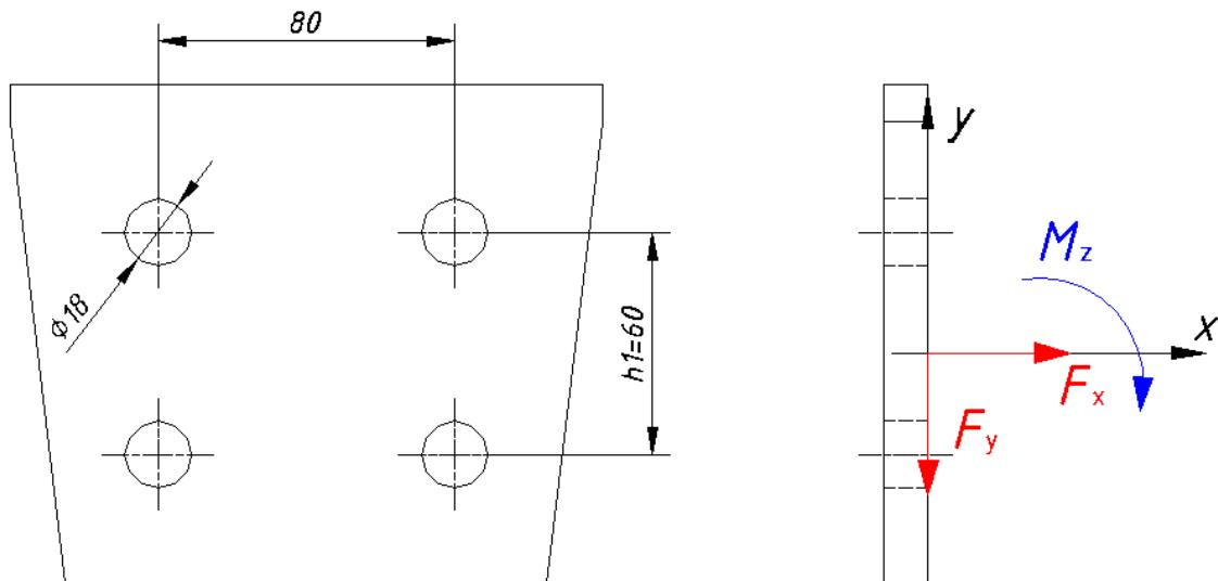
Slika 14.2 Najveće opterećenje spoja donje platforme za prihvatanje brodova sa kosim dijelom platforme
