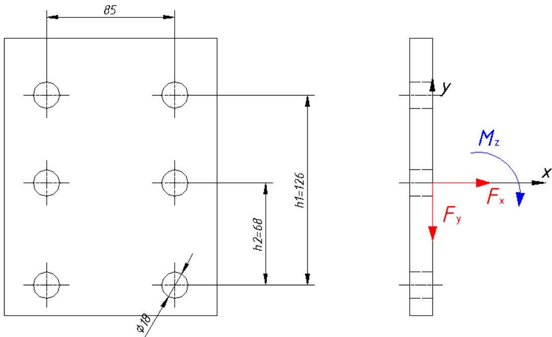
Slika 14.3 Opterećenje kritičnog spoja kod skladišne platforme
