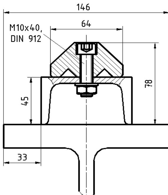
Slika 7.9 Spoj vodilice GU 62 MT za nosač vodilice
