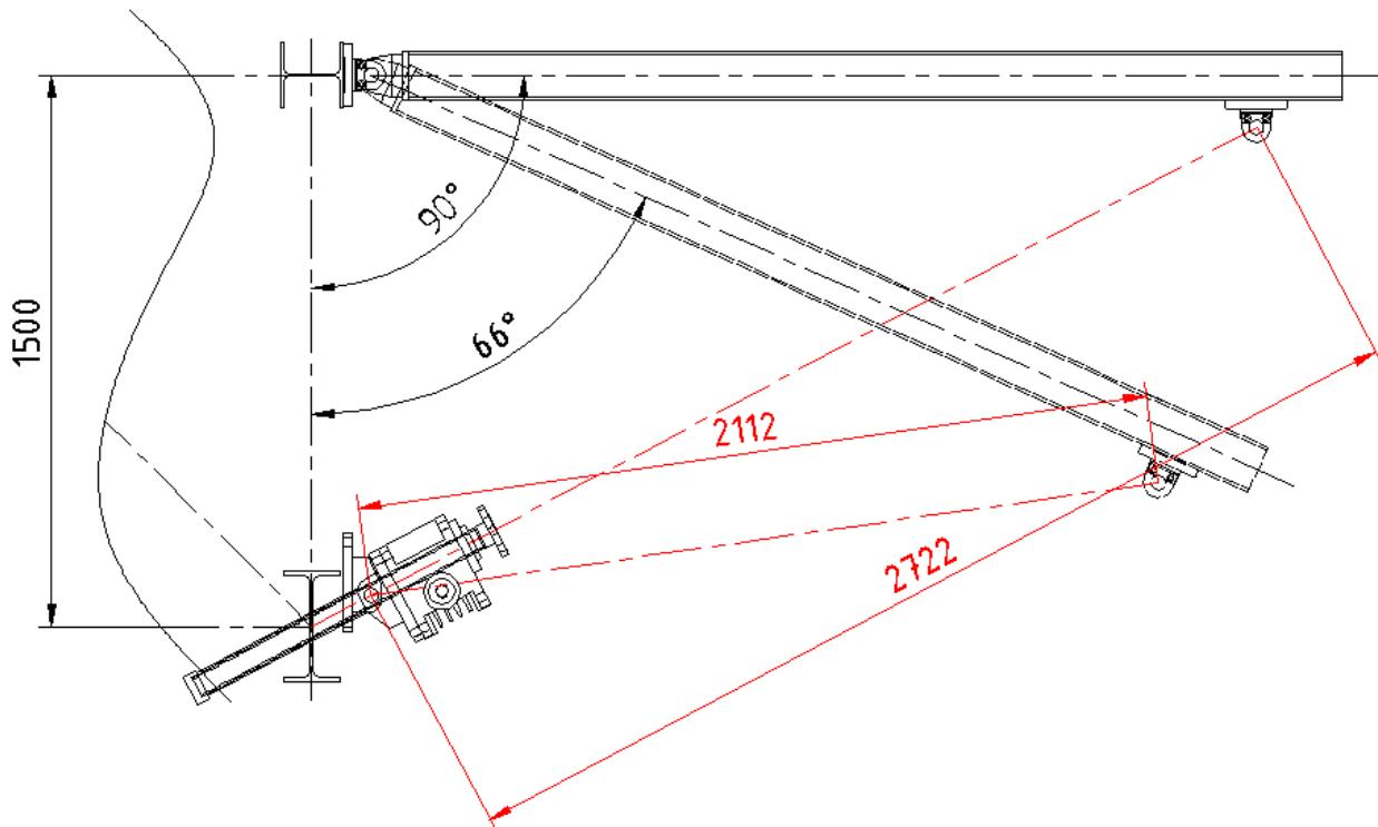
Slika 7.12 Određivanje hoda navojnog vretna Tr 60 x12
