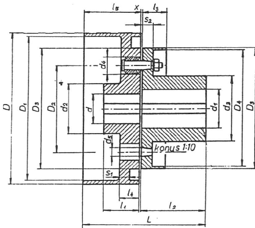
Slika 11.13 Elastična spojka sa bubnjem za kočnicu
