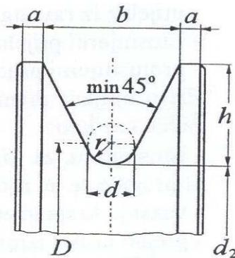
Slika 11.4 Mjere profila užnice
