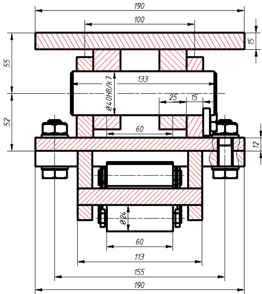
Slika 6.2 Dimenzije transportnog montažnog sklopa u presjeku A-A
