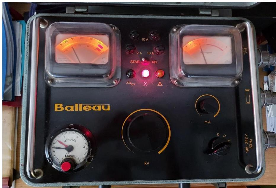
Slika 21. Upravljačka jedinica i parametri snimanja
