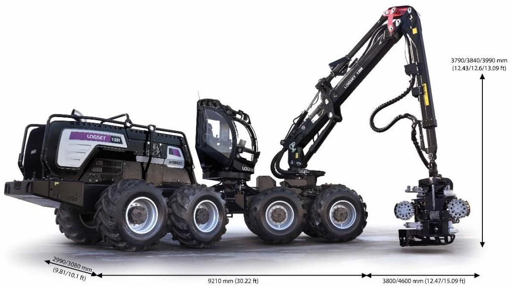
Slika 6. Logset 12H GTE (dimenzije) [8]
