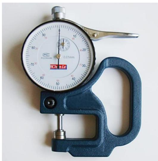
Slika 4.2. Uređaj za mjerenje debljine filmova i folija [22]
