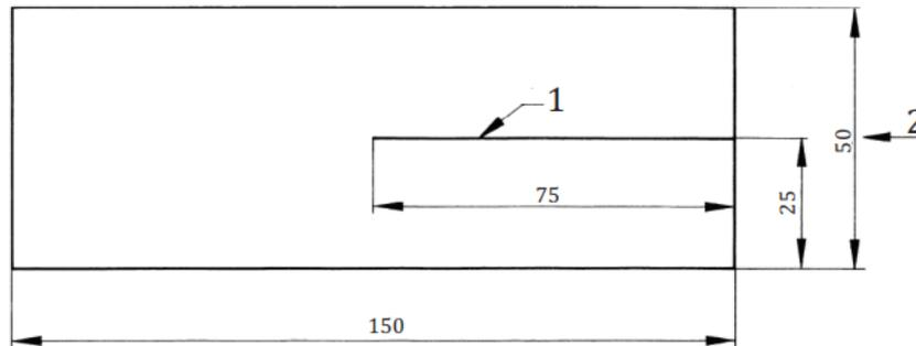
**Slika 4.3. Ispitno tijelo s prorezom, (1) prorez, 2) smjer ispitivanja)**
