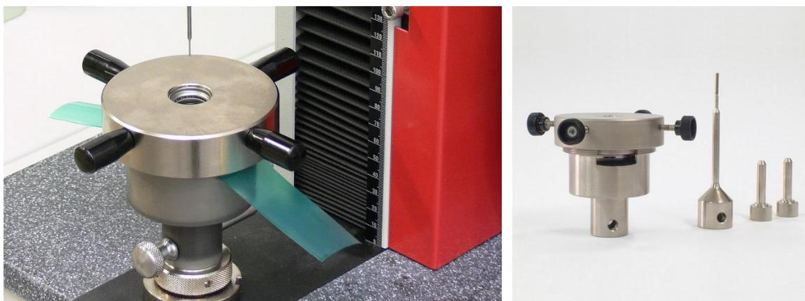
**Slika 4.5. Oprema za provođenje norme HRN EN ISO 14477 [26]**
