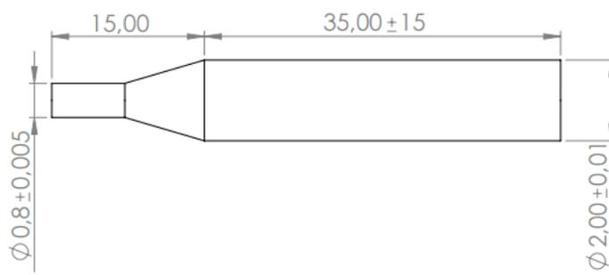
Slika 4.6. Sonda za ispitivanje
