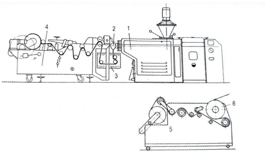
**Slika 3.6. Linija za ekstrudiranje ravnih folija, 1-ekstruder, 2-širokousna mlaznica, 3-vodena kupelj, 4-izvačilica, 5-izvlačilica s rashladnim valjcima, 6-rashladni valjak [10]**
