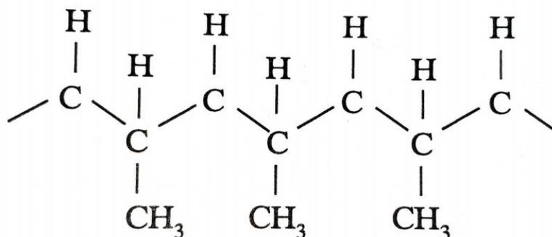
Slika 2.4. Strukturna formula izotaktnog polipropilena [3]
