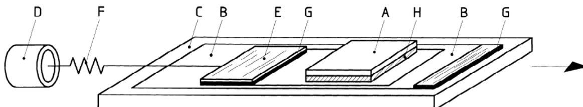
**Slika 4.1. Primjer aparature za određivanje faktora trenja plastičnih filmova i folija: A-klizač, B-ispitno tijelo, C-pomični stol, D-opterećenje, E-pločica za ojačanje, F-opruga, G-dvostrana ljepljiva traka, H-filc**
