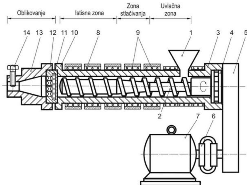
**Slika 3.2. Presjek jednupužnog plastificirajućeg ekstrudera; 1-lijevak, 2-pužni vijak, 3-cilindar, 4-tlačni ležaj, 5-namjestivi prigon, 6-spojka, 7-pogonski motor, 8-grijala, 9-hladila, 10-priрубnica, 11-sita, 12-cjedilo, 13-glava ekstrudera, ujedno i mlaznica, 14-prigušnica [10]**
