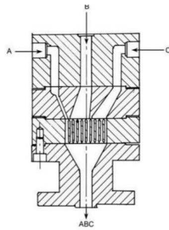
**Slika 3.12. Dovodni blok s ulaznim adapterima [18]**
