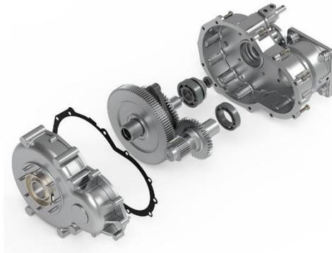
Slika 2.3. Reduktor električnog vozila [2].
