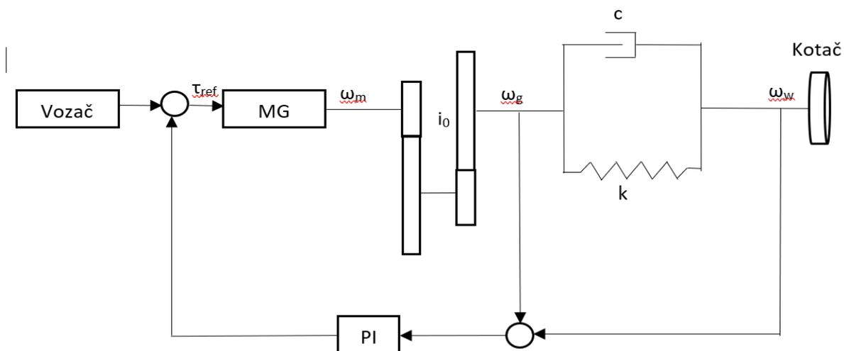
Slika 6.1. Shema upravljanja PI kompenzatorom zračnosti.
