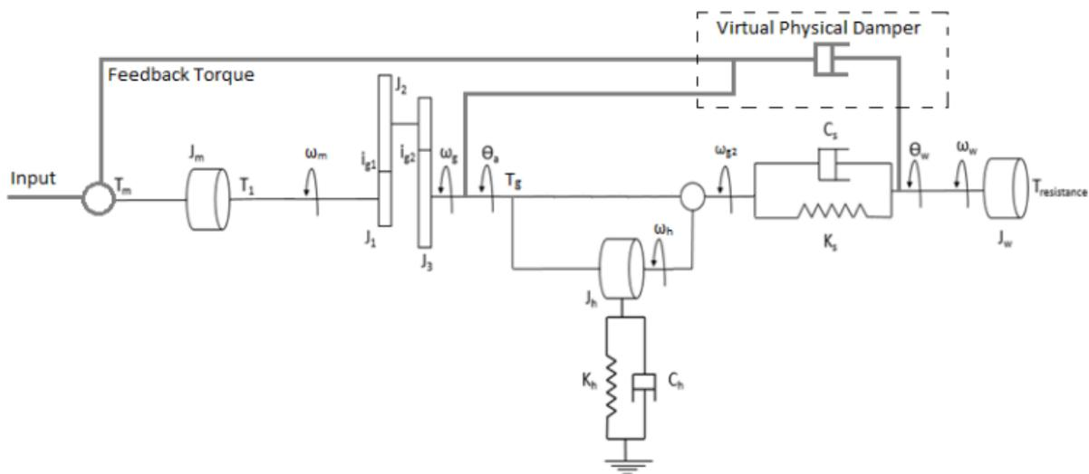
Slika 6.4. Struktura virtualnog fizikalnog prigušenja [9].
