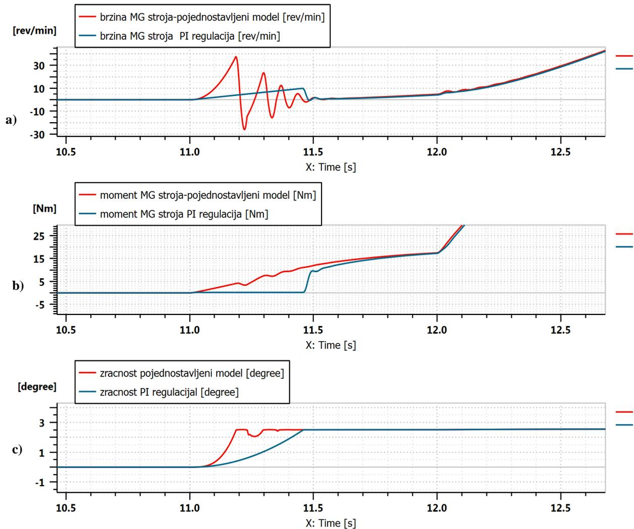
Slika 6.3. Usporedba odziva M/G stroja s PI i bez regulacije, brzina (a), moment (b), zračnost (c).
