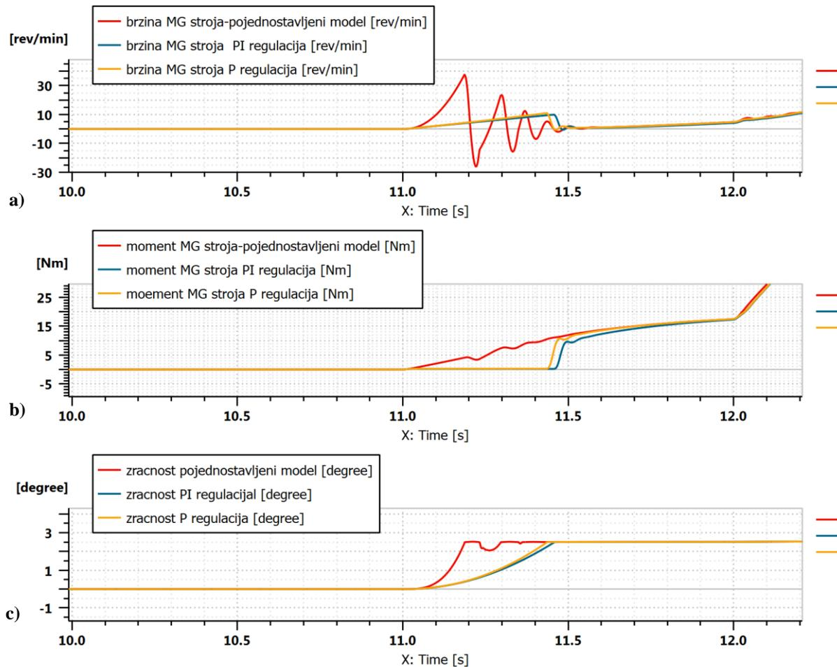
**Slika 6.6.** Usporedba odziva M/G stroja bez regulacije te s P i PI regulatorima; brzina M/G stroja (a), moment (b), zračnost (c).
