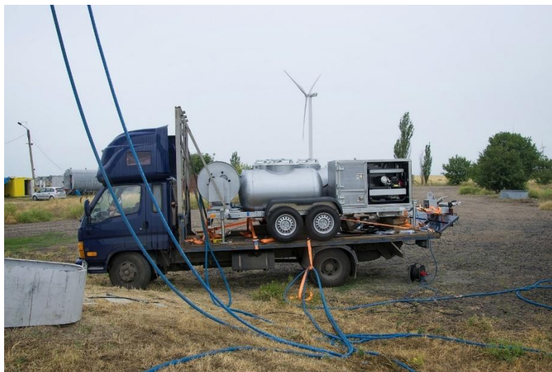
Slika 5: Uporaba stroja za izmjenu turbinskog ulja [13]
