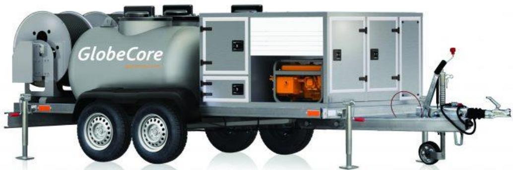
Slika 4: Stroj za izmjenu ulja u vjetroturbini [13]
