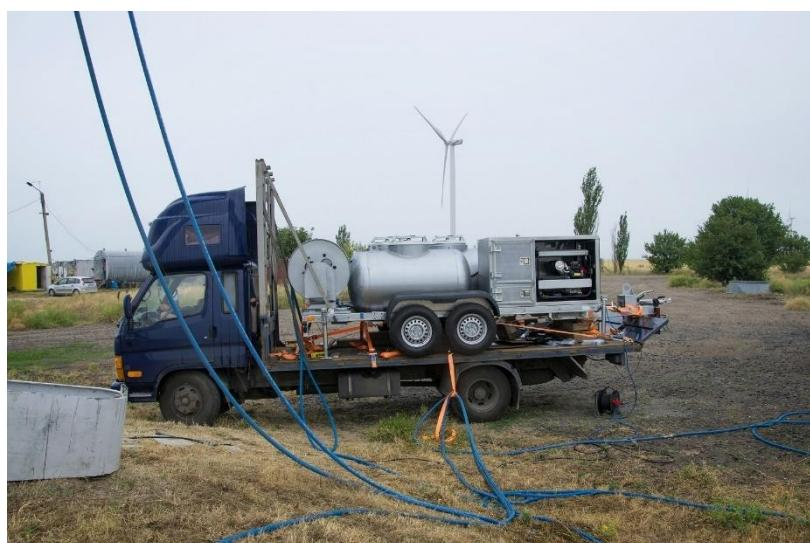
Slika 5: Uporaba stroja za izmjenu turbinskog ulja [13]
